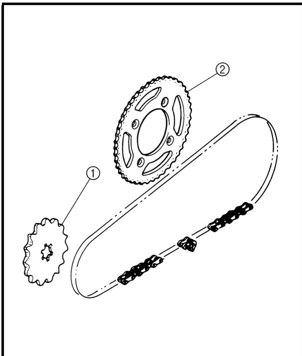
**DRIVE AND DRIVEN SPROCKETS SETTING PARTS**
