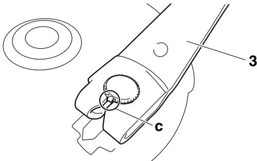
d. Verifique que las zapatas de freno queden correctamente situadas.
