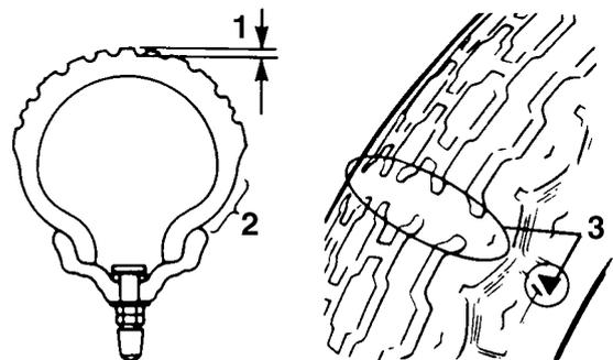
1. Profundidad del dibujo del neumático
