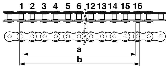
b. Calcule la longitud "c" del tramo de 15 eslabones de la cadena de transmisión con la fórmula siguiente.
