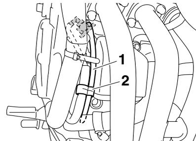
1. Tubo respiradero del depósito de líquido refrigerante
