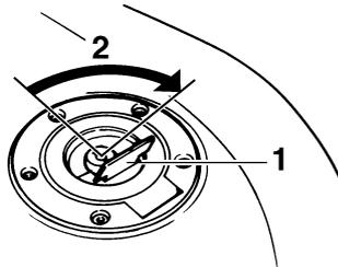
1. Cubierta de la cerradura del tapón del depósito de gasolina
