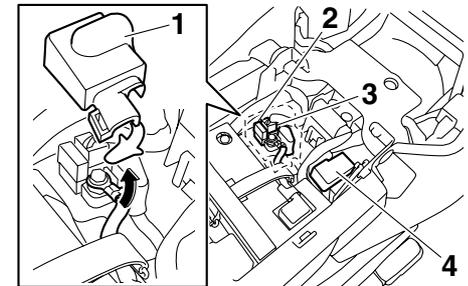
1. Tapa del relé del motor de arranque
