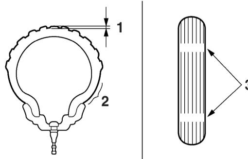
1. Profundidad de la rodadura del neumático
