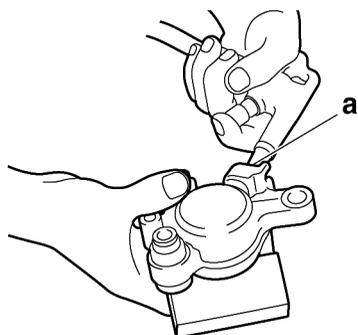
b. Extraiga las juntas del pistón de la pinza de freno.
