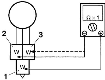
b. Mida la resistencia de la bobina del estátor.
