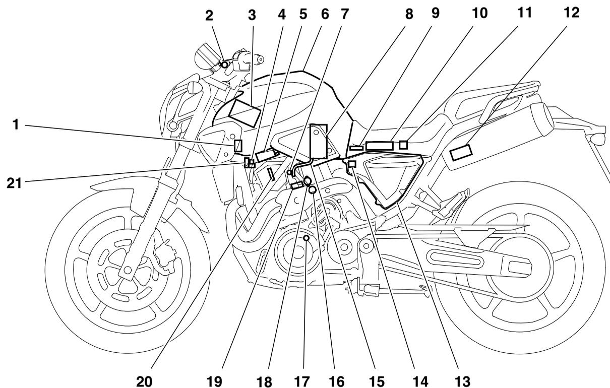
1. Relé del sistema de inyección de combustible
