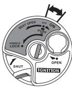
**OFF → ON → OFF → ON → OFF → ON → OFF** 3 veces, cambiará a "Registration Preparation Mode" (Modo de preparación de registro). Si no se realiza menos de 5 segundos después de la primera operación, vuelve a "Normal Operation Mode" (Modo de funcionamiento normal).
