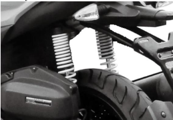
Retire los pernos superiores e inferiores del amortiguador.
