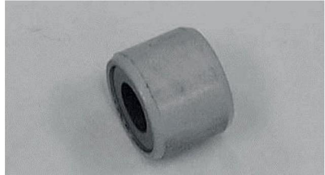
Mida el diámetro interno de la polea de tracción.
