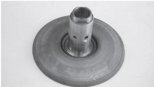
Ponga el conjunto de la polea conducida, el resorte de la cara conducida y el conjunto del clutch en el compresor del resorte del clutch.
