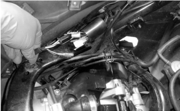
Afloje la abrazadera del conector de aire de la cubierta del sistema CVT y luego desconéctelo.
