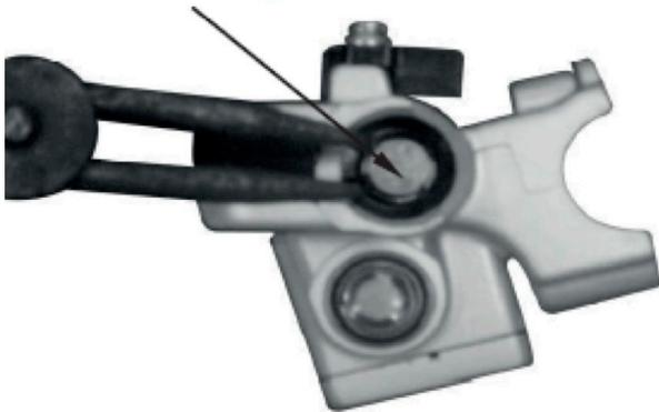
Retire la arandela, el pistón y el resorte del cilindro maestro. Limpie el interior del cilindro maestro con líquido de frenos nuevo. Verifique que el cilindro no esté rayado, desgastado ni quebrado.
