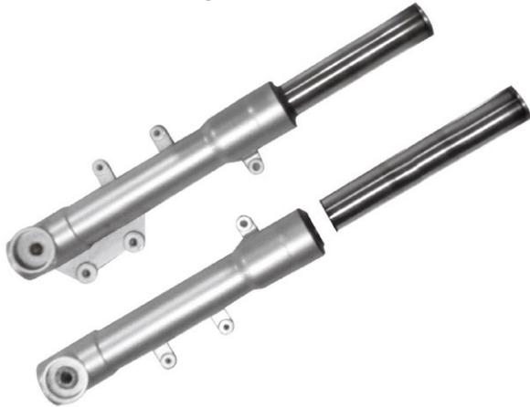
Retire el tapon superior, resorte, antivibrante y el resorte del tubo del amortiguador, inspeccione en busca de irregularidades en los componentes.
