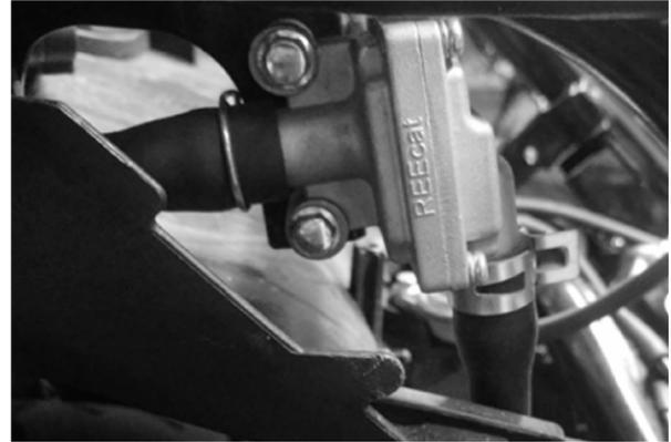
Retire los tornillos de la cubierta de la válvula de 1 vía. Verifique que las lengüetas no estén débiles. Verifique que en asiento de la válvula no haya quebraaduras, daños u holgura entre la lengüeta y el asiento. Verifique que el empaque y el O-ring no estén deteriorados.
