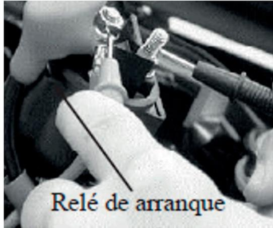
**Nota:** Con la punta positiva del multímetro toque la terminal conectada directamente de batería al relay, luego con la otra punta del multímetro toque la terminal contraria del relay, oprima el freno y pulse el interruptor de start, debe aparecer el voltaje de batería y escuchar un click, sino es así reemplace el relay de start.
