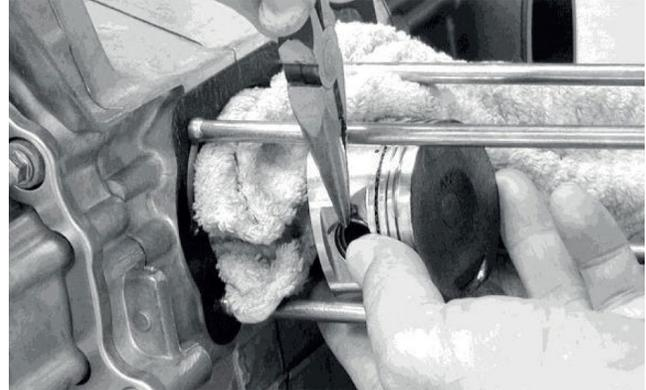
Verifique el pistón, el eje y los anillos. Retire los anillos.
