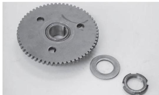
Retire la tuerca de fijación del clutch de arranque.
