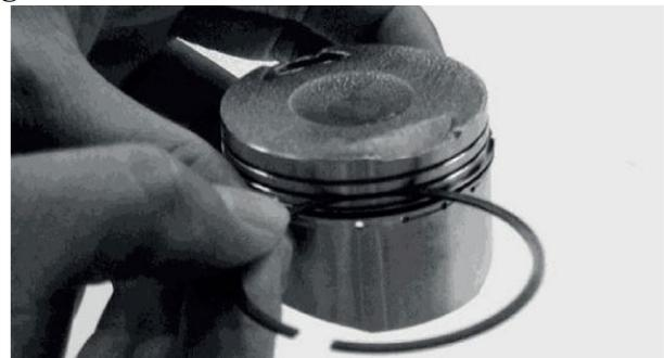
Retire los anillos e inserte cada uno en la parte inferior del cilindro.
