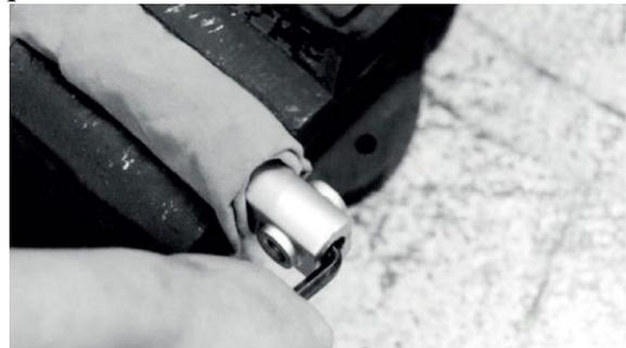
Instale el resorte de la suspensión con el lado denso hacia abajo. Coloque la botella en una prensa.
