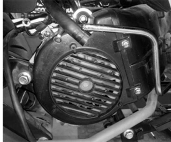
Retire los cuatro tornillos del ventilador.
