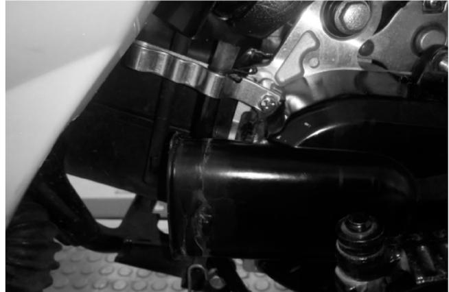
Desconecte la masa del motor.
