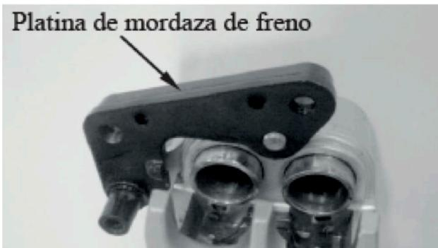
Coloque un trapo debajo para evitar que el pistón caiga al piso. Utilice aire a presión a través del ducto donde viene conectada la manguera del líquido de frenos para expulsar el pistón. Retire el pistón de la mordaza.
