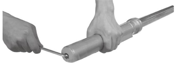
**NOTA:** Dado el caso que no afloje el tapon superior y el tornillo inferior de la suspension, utilice la herramienta.
