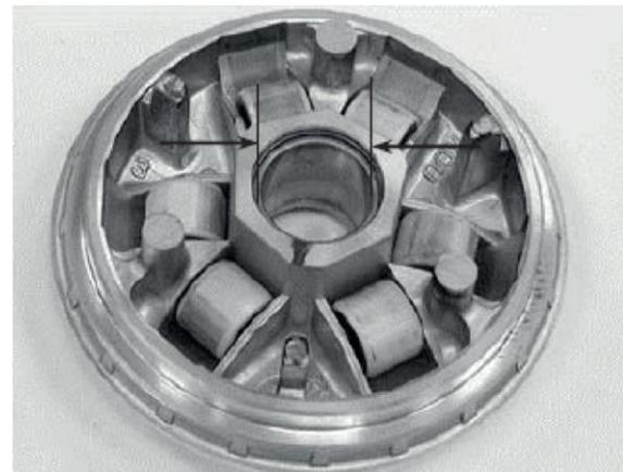
Revise si el buje de la polea conductora tiene desgaste o daños.
