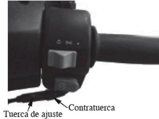
Un mayor ajuste del juego del acelerador se hace en el lado del carburador. Ajuste aflojando la contratuerca y girando la tuerca de ajuste.
