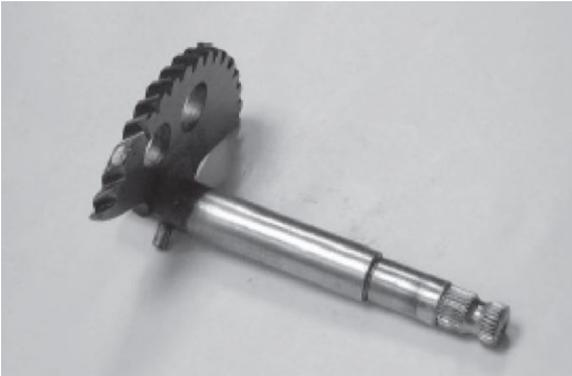
Instale el piñón conducido del arranque y el resorte de fricción como se muestra en la figura. Haga que coincidan las marcas.
