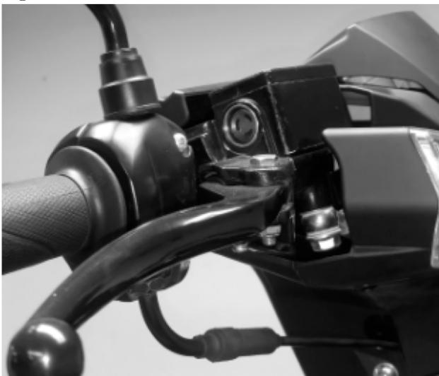
Rellene con líquido de frenos hasta el nivel máximo utilice el método purgado de freno descrito anteriormente, a medida que el líquido ingrese al sistema vaya adicionando más hasta que no salgan burbujas.
