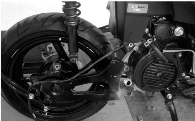
Retire el perno de fijación del motor
