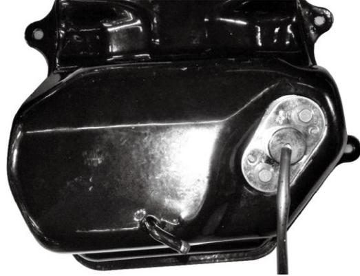
Mida el sensor de combustible con un multímetro en la escala de 200 ohm. Mida voltaje en la escala de 20vdc. Revise el flotador del sensor.
