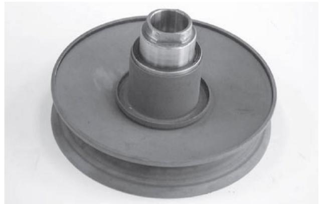
Retire los pasadores de los rodillos guía y los rodillos guía. Retire la cara conducida móvil de la cara conducida.
