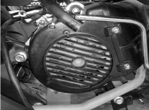
Retire la volante generadora A.C.
