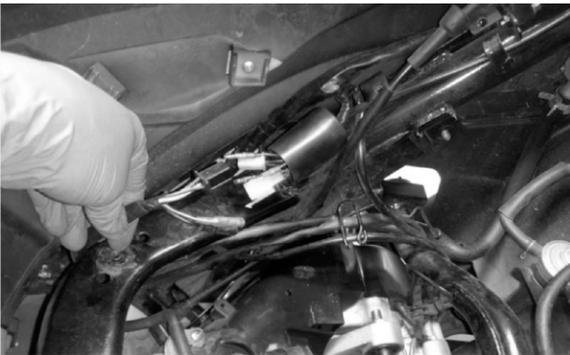
Retire los tornillos de la bobina pulsora.
