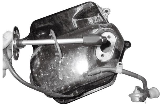
Revise la manguera de combustible en busca de fugas. Al desconectar la manguera del filtro no debe salir combustible, si sale reemplace la llave grifo.
