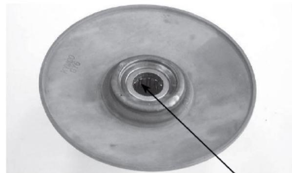
Retire el rodamiento externo de la cara conducida.
