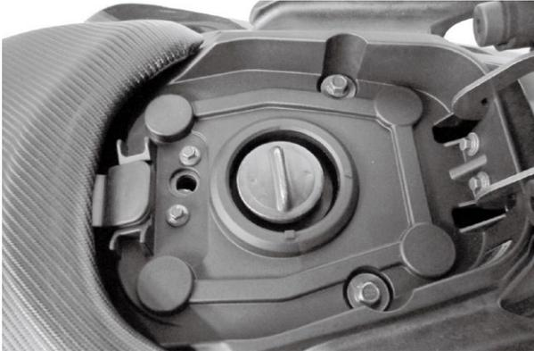
Desmonte las cubiertas laterales derecha/izquierda, el asiento trasero y el seguro de la silla con la guaya, luego retire los cuatro tornillos del tanque de combustible. Repare o reemplace el tanque si tiene fugas.
