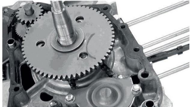
Retire los 2 tornillos y la cubierta separadora de aceite.
