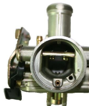
12 Limpie los conductos del carburador y reensamble.
