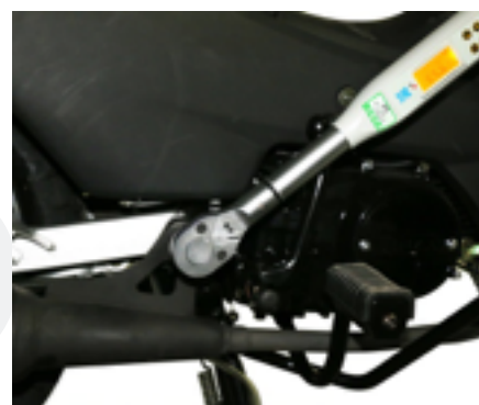
Eje de la tijera, m10 Torque: 45~65Nm
