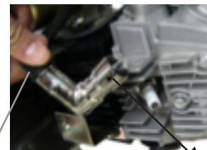
Cable salida secundaria de alto voltaje
