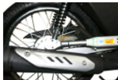
Rueda trasera, m10 Torque 45-65Nm
