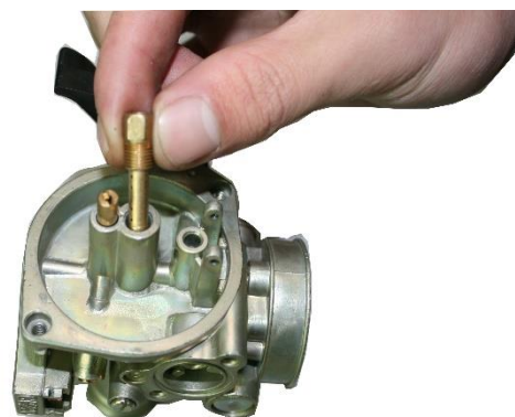
12 Limpie los conductos del carburador y reensamble.
