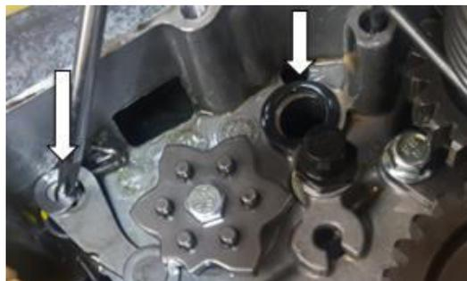
42 Retire el tornillo de la estrella selectora y retire la estrella
