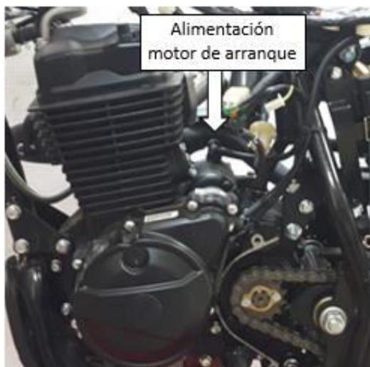
11 Desconecte la masa del motor
