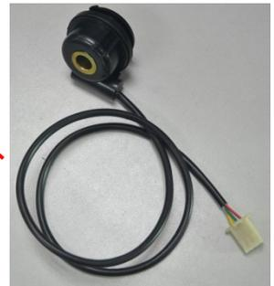
ACOPLE DEL TABLERO AL VELOCÍMETRO
