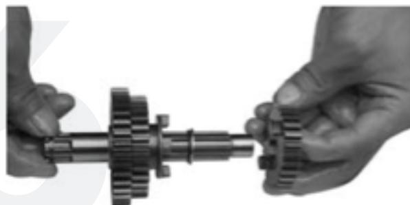
17. Retire el 2do piñón del eje secundario, luego revise su desgaste. Reemplace el piñón desgastado si es necesario.
