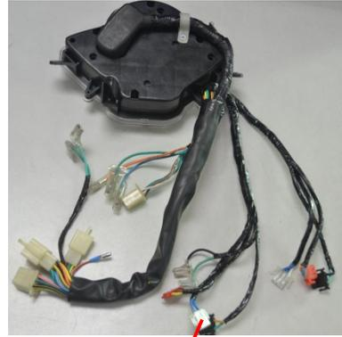
ACOPLE DEL ENCENDIDO ELÉCTRICO AL TABLERO
