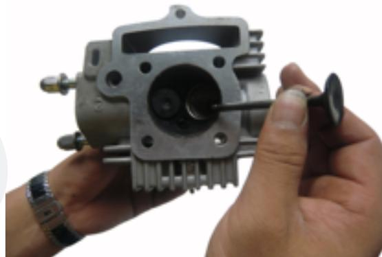
16. Mida el diámetro interno de la guía de la válvula. Si está por fuera del límite, reemplace las partes.
