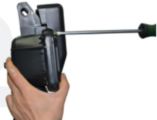
3. Retire el elemento del filtro y revíselo. Reemplácelo si está dañado.
