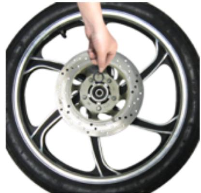
6. Revise el desgaste de los rodamientos de la rueda delantera. Reemplácelos si es necesario.
