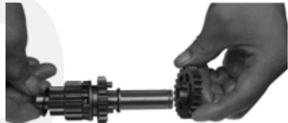
21. Retire el 3er piñón del eje, luego revise su desgaste. Reemplace el piñón desgastado si es necesario.
