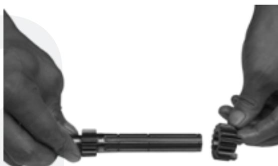
23. Retire el 1er piñón del eje, luego revise su desgaste. Reemplace el piñón desgastado si es necesario.
