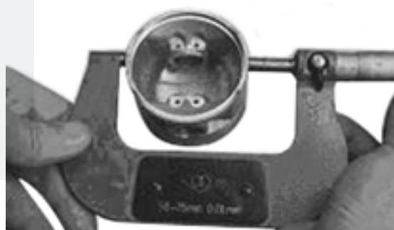
12. Mida el ancho de la ranura del pistón y el diámetro de la falda del pistón. Si esta por fuera del límite de servicio, reemplace el pistón.
