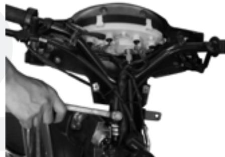
3. Retire el tubo del manubrio, revise si está deformado. Corrija o reemplácelo si es necesario.
