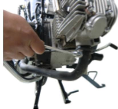
2. Retire el mofle y revise si la platina de montaje se encuentra dañada o reventada. Repare o reemplace la parte dañada.
