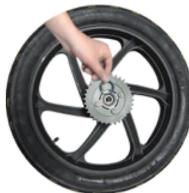
12. Retire las tuercas del sprocket trasero y revise el desgaste del sprocket. Reemplácelo si es necesario.
