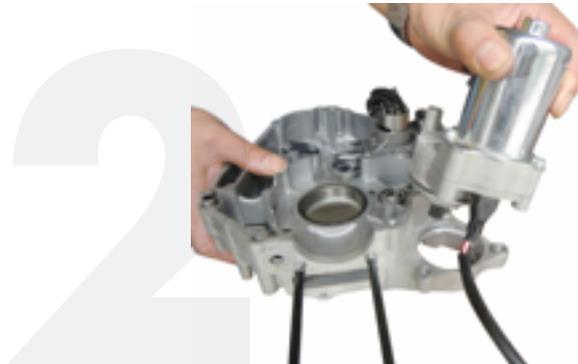
3. Revise si el O-ring en el motor de arranque está dañado. Reemplácelo si es necesario.
