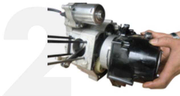
3. Retire y revise si el empaque de la carcasa derecha está dañado. Reemplace si es necesario.
