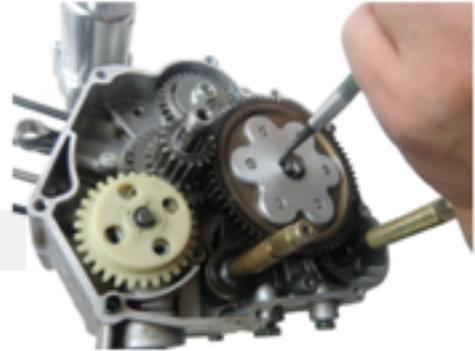
15. Revise el desgaste del piñón accionado primario. Reemplace el piñón desgastado por uno nuevo.
