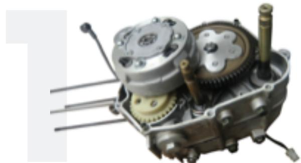
2. Retire la platina de leva del clutch y revise su desgaste. Reemplácela si es necesario.
