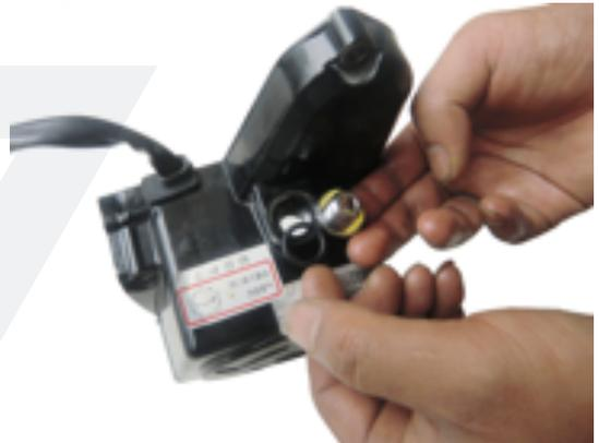
8. Retire y revise si el empaque de la cubierta izquierda está dañado. Reemplácelo si es necesario.
