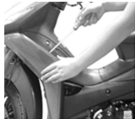
2. Retire el tornillo del filtro de aire y retire la cubierta del filtro de aire.
