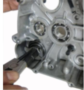
2. Retire el ensamble del eje de arranque.
