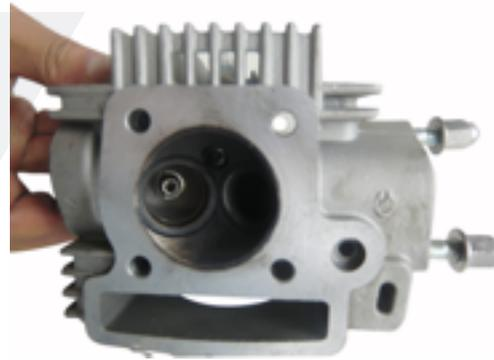
18. Desatornille la bujía, Limpie los depósitos de carbón alrededor de la bujía.
