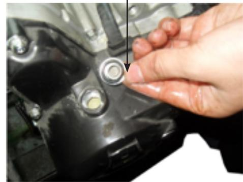
12. Ajuste las válvulas de admisión y escape a 0.04~0.06mm, luego apriete la tuerca de la válvula.
