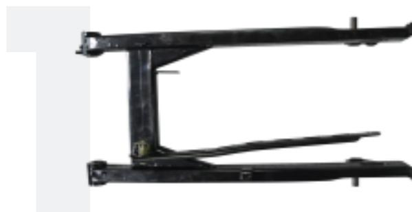
2. Retire la tuerca de seguridad del amortiguador trasero. Revise el desgaste del buje. Reemplácelo por uno nuevo.
