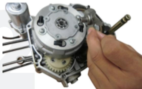
3. Retire el rodamiento del clutch y revise su desgaste. Reemplácelo si es necesario.
