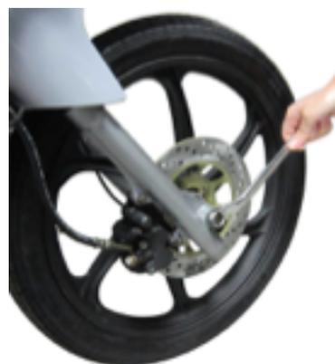
2. Retire el buje del eje delantero y revise si está desgastado. Reemplácelo si es necesario. Límite de servicio: Menor de 3mm de espesor.
