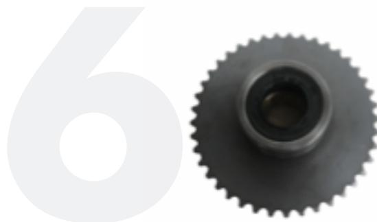
7. Revise el desgaste o deformación del rotor de la volante. Reemplácelo si es necesario.
