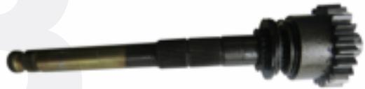
4. Retire el anillo de sujeción y el asiento del trinquete del eje de arranque, luego revise su desgaste. Reemplácelo si es necesario.
