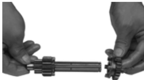
22. Retire el 2do piñón del eje, luego revise su desgaste. Reemplace el piñón desgastado si es necesario.
