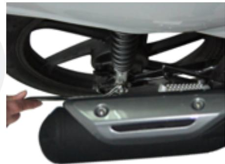
10. Retire la tuerca de ajuste del ajustador de la cadena, retire el eje trasero.
