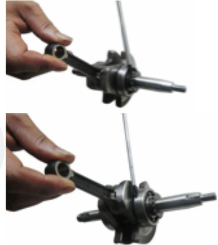
6. Revise el desgaste del eje balanceador. Reemplácelo si es necesario.
