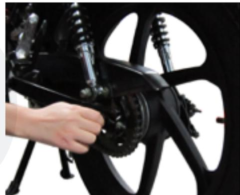
11. Retire el buje y el retenedor del centro de la rueda y revise el retenedor. Reemplácelo si es necesario.
