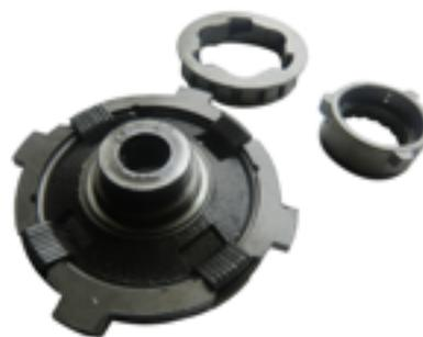
13. Mida el espesor de los discos de fricción del clutch con un pie de rey. Si está por fuera del límite de servicio, reemplace los discos como un conjunto. El límite de servicio del espesor es 1.3mm, y el límite de servicio de la deformación es 0.2mm.
