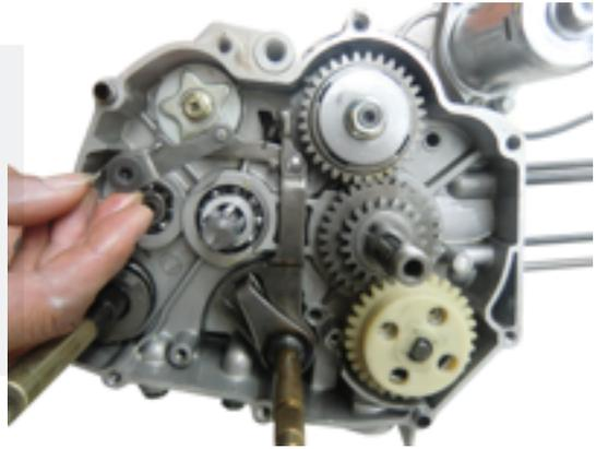
2. Retire el tornillo del tambor de cambios. (NOTA: Torque de apriete del tornillo: 8~12 Nm)
