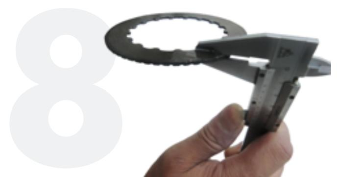
9. Retire el ensamble externo del clutch. Revise su desgaste. Reemplácelo si es necesario. (NOTA: Torque de apriete: 8~12 Nm)
