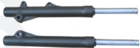
4. Retire el tornillo de drenaje, retire todo el aceite de las barras. Revise el aceite y reemplácelo si es necesario.
