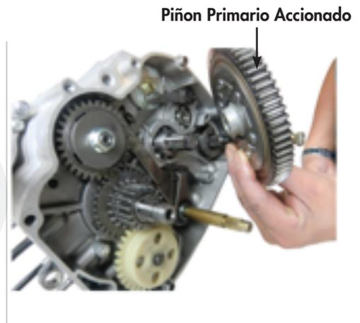
16. Revise el desgaste del piñón primario. Reemplace si el piñón está desgastado por uno nuevo. Límite de servicio diámetro interno <math><21.05\text{mm}</math>
