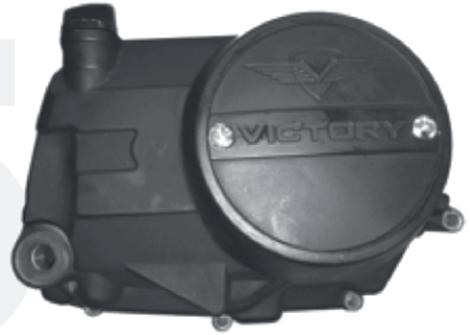
6. Retire los tornillos de la cubierta de la carcasa izquierda.
