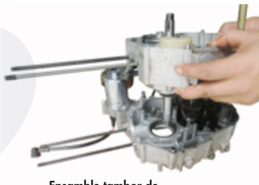
10. Retire el ensamble del tambor de cambios, ensamble del eje principal y ensamble del eje secundario.
