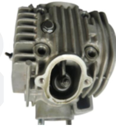
9. Retire el tornillo protector del eje del balancín.
