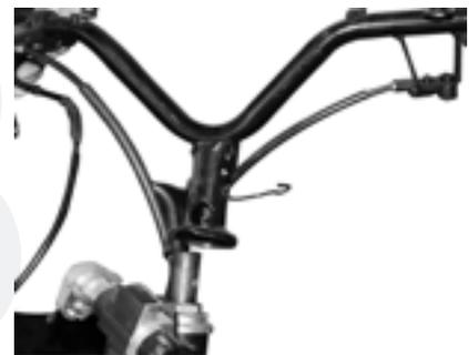
4. Retire la tuerca de seguridad del vástago de la dirección.
