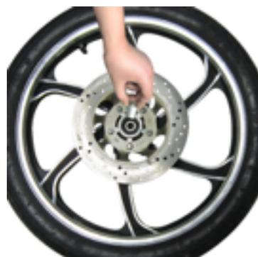
3. Revise el desgaste del retenedor de la manzana del velocímetro y reemplácelo si es necesario.
