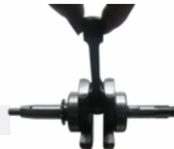
5. Revise el desgaste del piñón de sincronización de la biela y reemplácelo si es necesario. Asegúrese de que el espacio del diente esté alineado con el chavetero de la línea central del cigüeñal. Revise el desgaste de los rodamientos derecho e izquierdo de la carcasa. Reemplácelos si es necesario.
