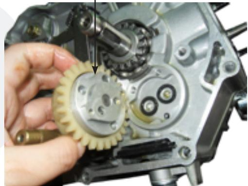
11. Revise el desgaste del O-ring de la bomba de aceite y reemplácelo si es necesario.
