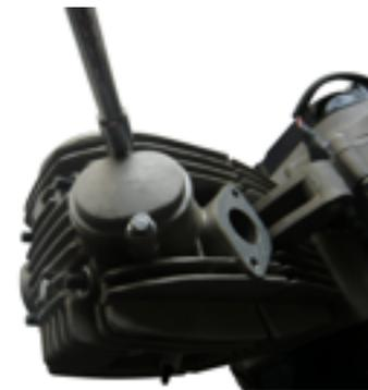
11. Retire el tapón del agujero de inspección en la cubierta izquierda. Gire la volante en sentido anti-horario hasta que la marca "T" en la volante se alinee con la marca en la cubierta izquierda de la carcasa. En este caso, las válvulas de admisión y de escape están cerradas.
