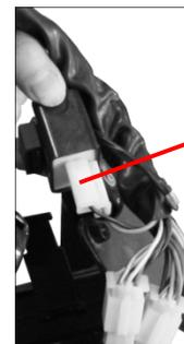
Retire el tablero y revise la continuidad del acople de las luces LED de día delanteras y LED de posición trasera (Stop), LED de freno, LED de iluminación, direccional, pito y direccional LED delantera. Repare o reemplace la parte dañada.
