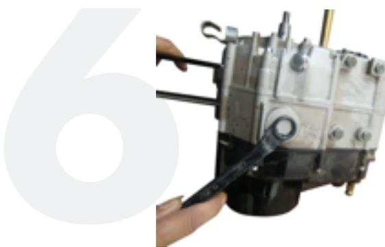
7. Retire los tornillos de la cubierta derecha de la carcasa, luego retire la cubierta derecha de la carcasa.
