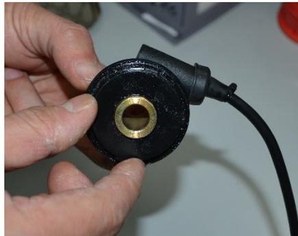
Rote el sensor de velocidad para medir los valores de voltaje en sus dos posiciones.
