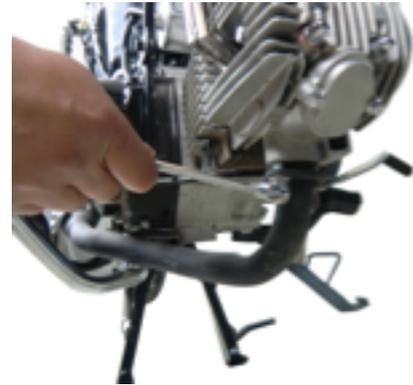
2. Retire el mofle y revise si la platina de montaje se encuentra dañada o reventada. Repare o reemplace la parte dañada.
