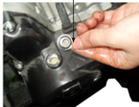
12. Ajuste las válvulas de admisión y escape a 0.03~0.05mm, luego apriete la tuerca de la válvula.
