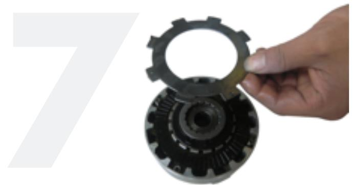
8. Mida el espesor del plato conductor y del disco de fricción con un pie de rey. Si está por fuera del límite de servicio, reemplace los discos como un conjunto. Límite de servicio: 3.1mm, 2.3mm
