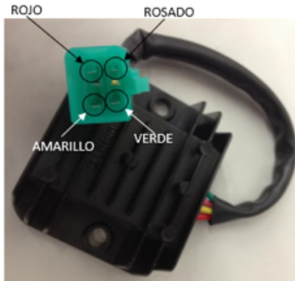
El voltaje de carga del regulador es 13V~15V. Si es menor a 13V reemplácelo por una nuevo. Desconecte del ramal eléctrico del acople de la bobina de carga del plato de bobina; revise si la bobina tiene continuidad. De lo contrario, repare o reemplace.
