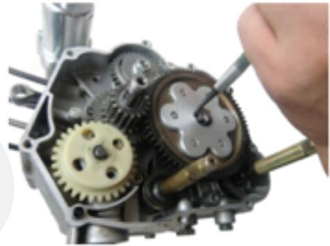
16. Revise el desgaste del piñón accionado primario. Reemplace el piñón desgastado por uno nuevo.
