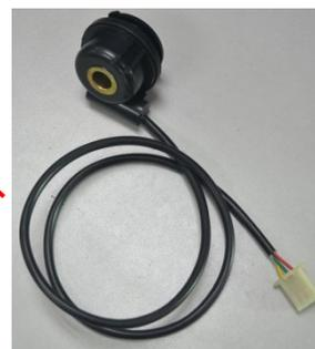
ACOPLE DEL TABLERO AL VELOCÍMETRO
