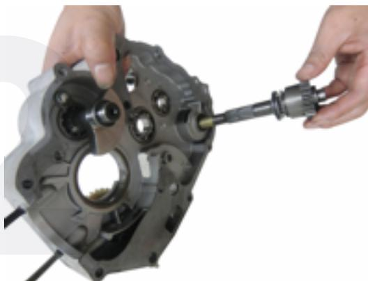
3. El ensamble del eje de arranque se muestra en la siguiente figura.
