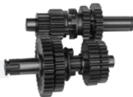
15. Retire el 4to piñón del eje secundario y luego revise su desgaste. Reemplace el piñón desgastado si es necesario.
