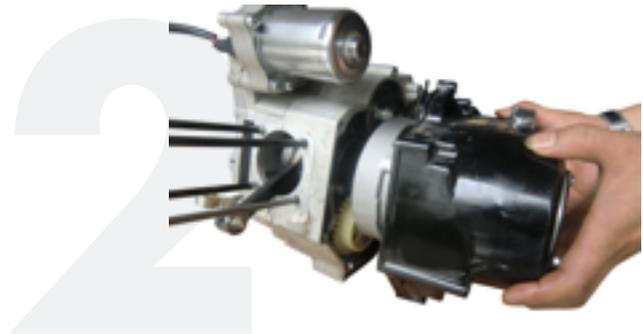
3. Retire y revise si el empaque de la carcasa derecha está dañado. Reemplace si es necesario.
