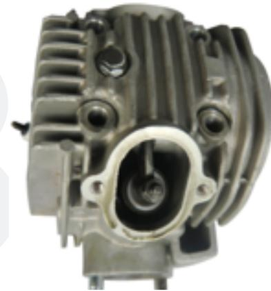
9. Retire el tornillo protector del eje del balancín.
