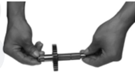
19. Revise el desgaste de todas las arandelas y pin candado del eje secundario. Reemplace las arandelas si es necesario.
