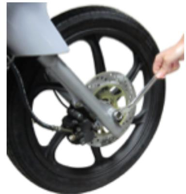
2. Retire el buje del eje delantero y revise si está desgastado. Reemplácelo si es necesario. Límite de servicio: Menor de 3mm de espesor.
