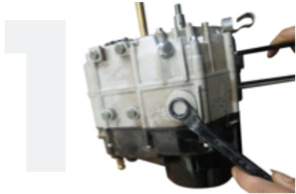
2. Retire los tornillos de la cubierta derecha de la carcasa. Retire la cubierta golpeando con un martillo de goma. (NOTA: torque de apriete del tapón 8~12Nm).
