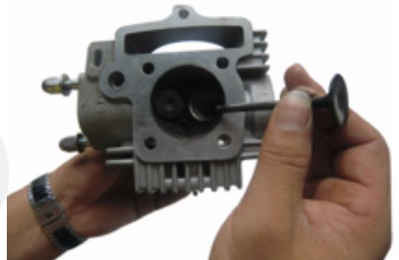
16. Mida el diámetro interno de la guía de la válvula. Si está por fuera del límite, reemplace las partes.
