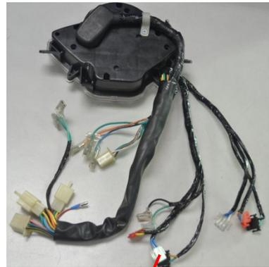
ACOPLE DEL ENCENDIDO ELÉCTRICO AL TABLERO
