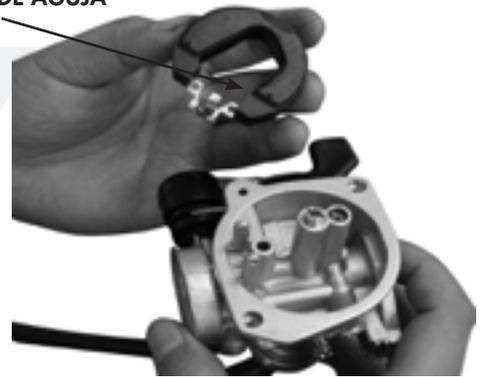
8. Retire el boquerel principal y revíselo. Limpie el boquerel con una pistola de aire comprimido si es necesario.
