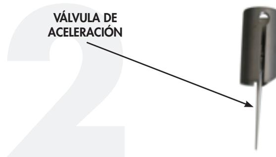
3. Retire la aguja y revise su desgaste y deformación. Reemplace la aguja si es necesario. Revise el adecuado ajuste de la aguja y vuelva a ajustar si es necesario. Como regla, la posición del gancho de la aguja está en la 3er muesca contando desde la parte superior.
