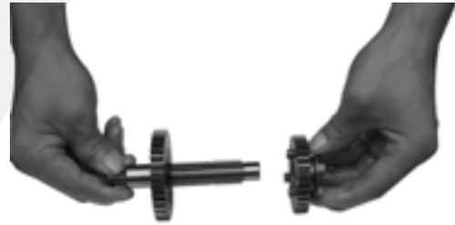
18. Revise el 1er piñón del eje, luego revise su desgaste. Reemplace el piñón desgastado si es necesario.
