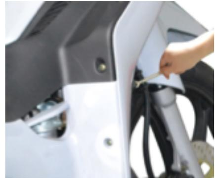
2. Retire las tuercas de seguridad del eje delantero y del cáliper. Retire el eje y la rueda.
