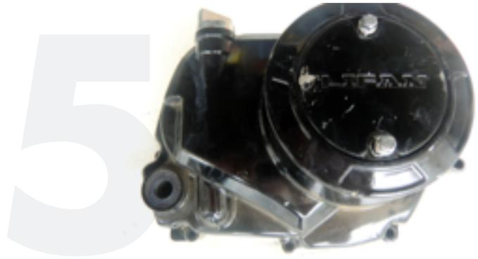
6. Retire los tornillos de la cubierta de la carcasa izquierda.
