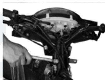
3. Retire el tubo del manubrio, revise si está deformado. Corrija o reemplácelo si es necesario.
