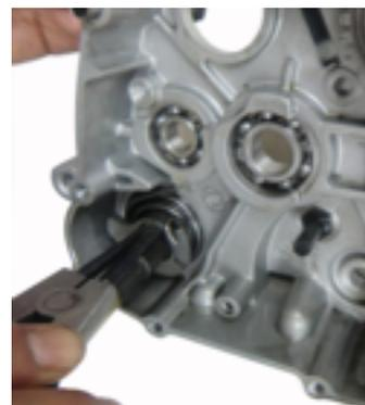
2. Retire el ensamble del eje de arranque.
