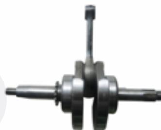
4. Mida la holgura del extremo grande de la biela con una galga de espesores y un micrómetro. Si está por fuera del límite de Servicio, reemplácela por una nueva.
