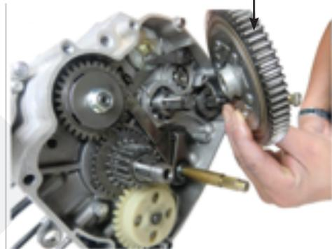
17. Revise el desgaste del piñón primario. Reemplace si el piñón está desgastado por uno nuevo. Límite de servicio diámetro interno <math>< \sim 21.05\text{mm}</math>
