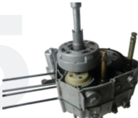
6. Retire el anillo de retención del clutch. Revise su deformación. Reemplácelo si es necesario.
