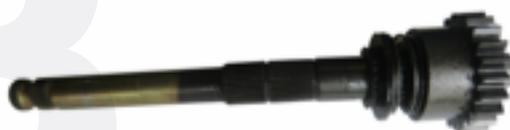
4. Retire el anillo de sujeción y el asiento del trinquete del eje de arranque, luego revise su desgaste. Reemplácelo si es necesario.
