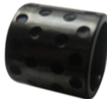
18. Revise el desgaste del buje del piñón primario. Reemplace el buje desgastado por uno nuevo.
