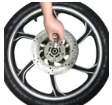
3. Revise el desgaste del retenedor de la manzana del velocímetro y reemplácelo si es necesario.
