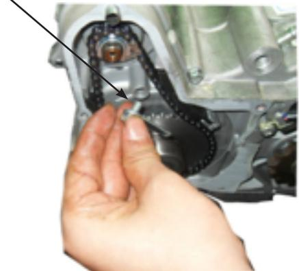
11. Retire el sprocket de arranque, la platina de tensión, la platina guía y el piñón del clutch de arranque, retire el tornillo de la cubierta del sprocket, luego retire la cubierta del sprocket y el empaque.
