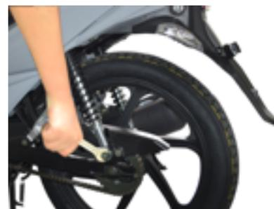
3. Revise el funcionamiento del resorte, revise si el amortiguador trasero tiene fugas. Reemplácelo si es necesario
