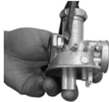
12. Limpie los conductos en el carburador y aplique aire en todos los conductos y boquereles con una pistola de aire comprimido. Para ensamblar, haga lo opuesto a los procedimientos de desensamble.
