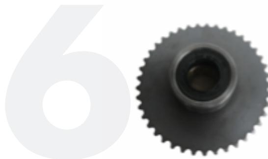
7. Revise el desgaste o deformación del rotor de la volante. Reemplácelo si es necesario.
