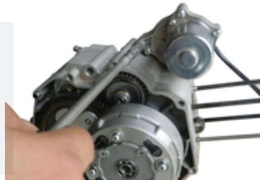
2. Golpeando con un martillo plástico, retire el motor de arranque.
