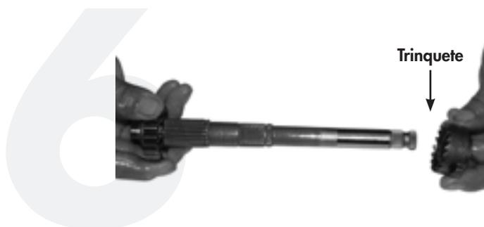
7. Revise el desgaste y la deformación del piñón de arranque y la parte dentada. Reemplácelo si es necesario.
