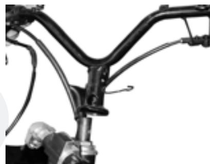
4. Retire la tuerca de seguridad del vástago de la dirección
