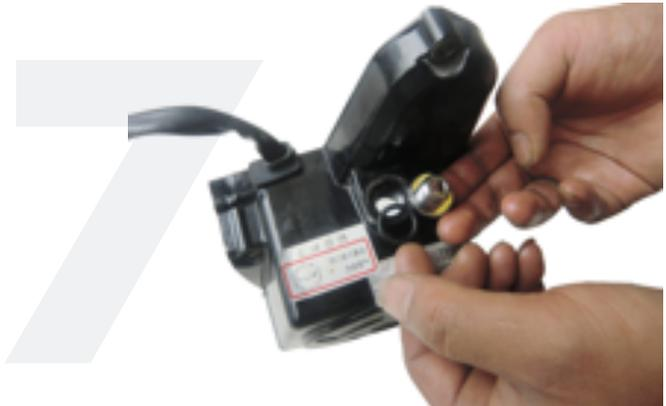
8. Retire y revise si el empaque de la cubierta izquierda está dañado. Reemplácelo si es necesario.
