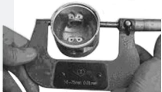
12. Mida el ancho de la muesca del pistón y el diámetro de la falda del pistón. Si esta por fuera del límite de servicio, reemplace el pistón.
