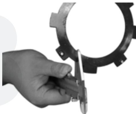
14. Revise el desgaste del cuerpo del clutch de arranque, los rodillos y los resortes. Reemplace las partes si es necesario.
