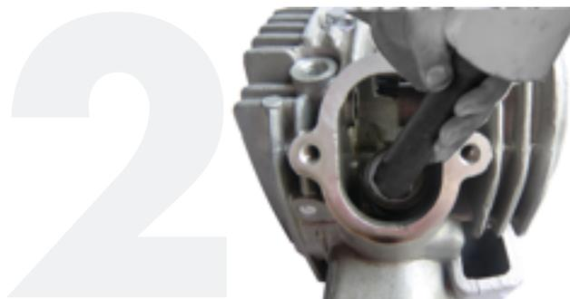
3. Revise los resortes de las válvulas y revise su desgaste o deformación. Repárelos o reemplácelos si es necesario.
