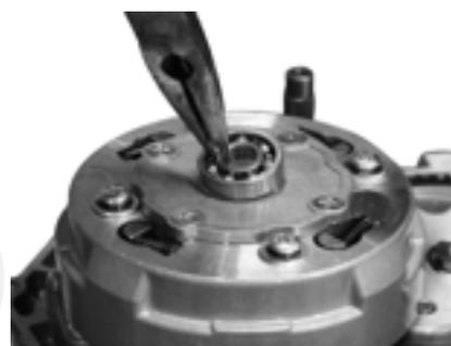
4. Retire el tornillo de la cubierta del clutch y revise su desgaste. Reemplácelo si es necesario. (NOTA: Torque de apriete del tornillo 8~12N•m)
