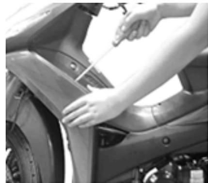
2. Retire el tornillo del filtro de aire y retire la cubierta del filtro de aire.
