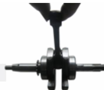
5. Revise el desgaste del sprocket de sincronización de la biela y reemplácelo si es necesario. Asegúrese de que el espacio del diente esté alineado con el chavetero de la línea central del cigüeñal. Revise el desgaste de los rodamientos derecho e izquierdo de la carcasa. Reemplácelos si es necesario.
