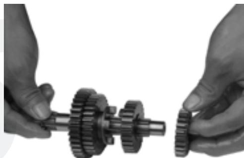
16. Retire el 3er piñón del eje secundario y la arandela, luego revise su desgaste. Reemplace el piñón desgastado si es necesario.
