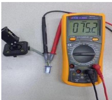
Resistencia del sensor con tanque vacío 70~80 Ω
