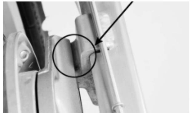
Coloque la rueda trasera al chasis alineando los agujeros de los espaciadores y las tuercas de ajuste de la cadena de transmisión.
