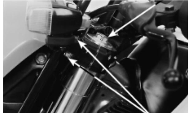
Tornillos de fijación MUESTRA TIPO DE MESA
