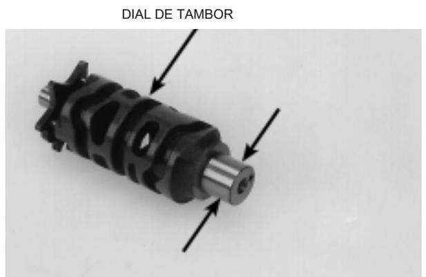
Inspeccionar el cojinete del tambor en la carcasa del motor deslizador de la derecha para el desgaste o daños excesivos.
