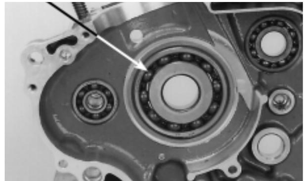
Extraer los rodamientos del eje de balancín utilizando las herramientas especiales.
