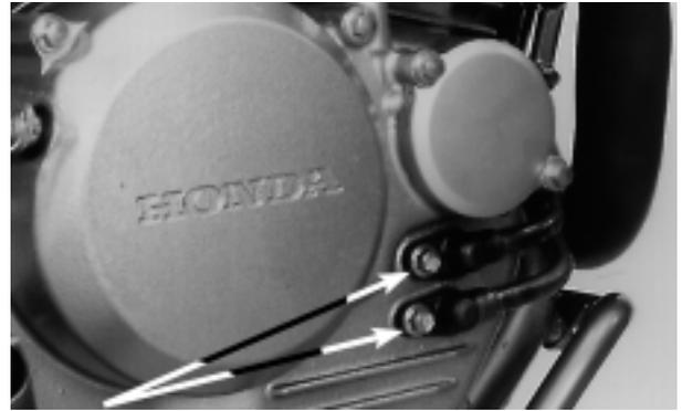
Perno / tubo de aceite / anillos de estanqueidad refrigerador del aceite
