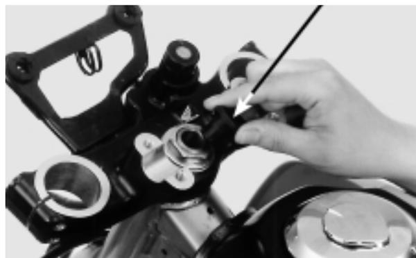
Retire la tuerca de la columna de dirección con la herramienta especial.
