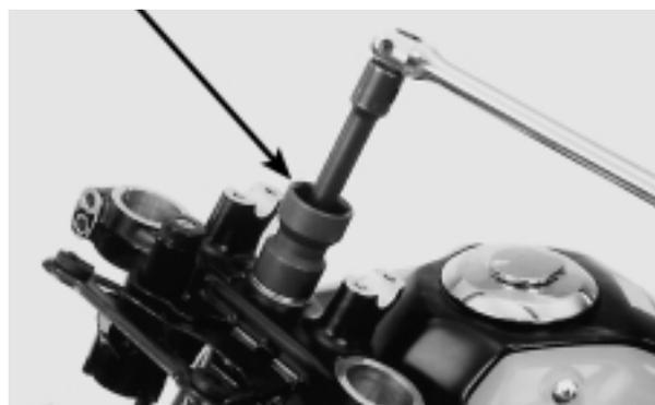
Retire la tuerca y la arandela de la columna de dirección.
