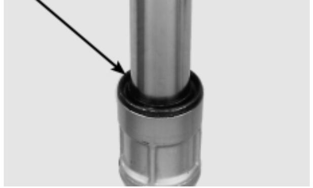
Retire la ranura del anillo de retención del cilindro exterior.
