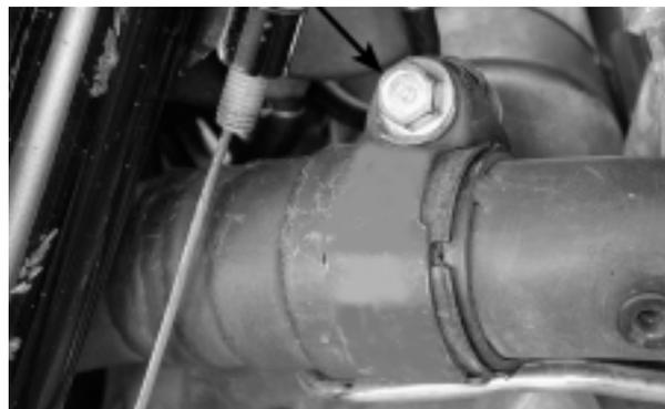
Apretar el montaje frontal silenciador perno con el par especificado.
