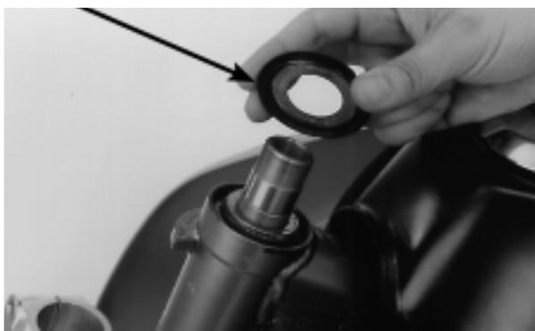
Mantenga la columna de dirección y retirar el anillo de rodadura interior y el cojinete superior.
