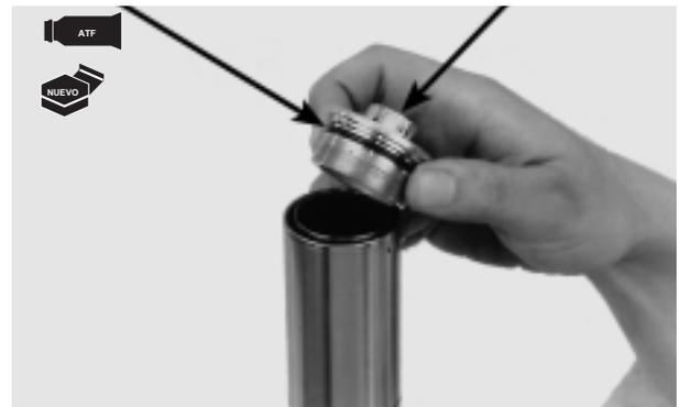
Instalar compromiso escudo en el tenedor y el extremo inferior de la ranura. Coloque la mordaza superior de modo que la proyección tornillo se enfrenta a la cara exterior de la tenedor después de la instalación en la motocicleta.
