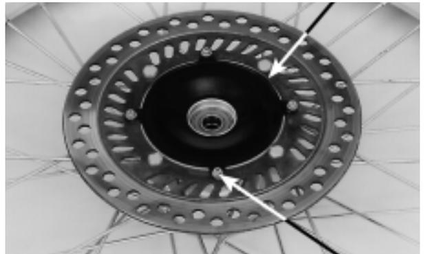
Retire los tornillos y el cubo del disco de freno.
