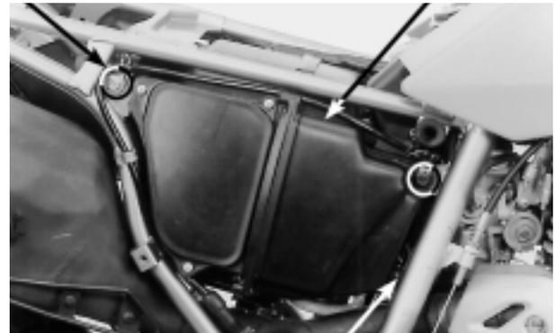
TUBO pernos de la caja MOTOR SUSPIRADOR
