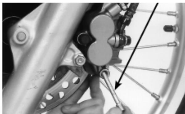
Coloque y apriete el £ Buja la clavija de inserción con el par especificado.
