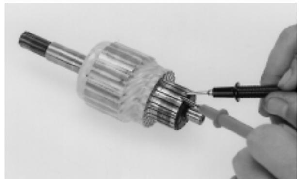
Compruebe la continuidad entre cada barra del conmutador y el eje inducido.
