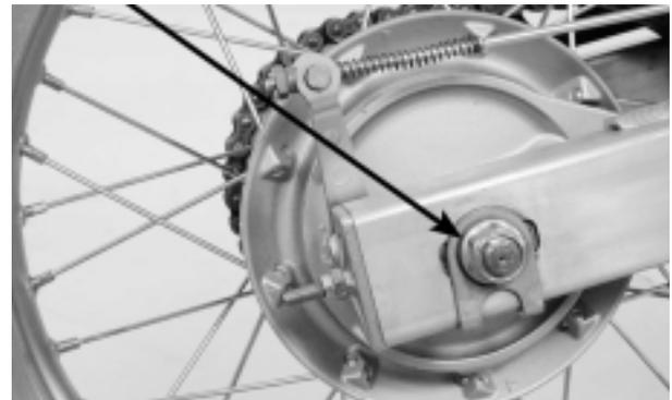
Insertar el eje trasero desde el lado izquierdo a través de la cadena de izquierda unidad de ajuste, el espaciador izquierda, la rueda trasera, el espaciador derecho, espejo ajustador del freno y la cadena de transmisión derecha.
