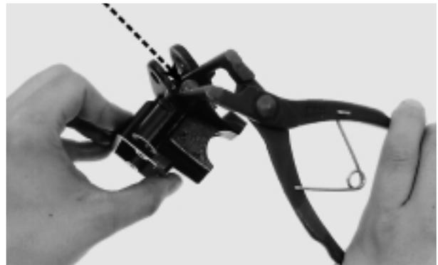
Retire el anillo elástico, la pista o y el resorte del cilindro maestro.
