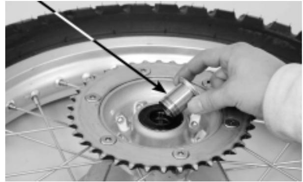
Instalar el panel de freno en el cubo de la rueda derecha lado.
