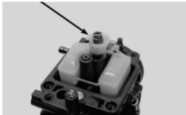
Retire el pasador del flotador, la válvula de flotador y el flotador.
