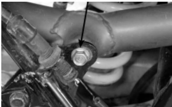
Apretar el tornillo de fijación silenciador tuerca / trasero con el par especificado.
