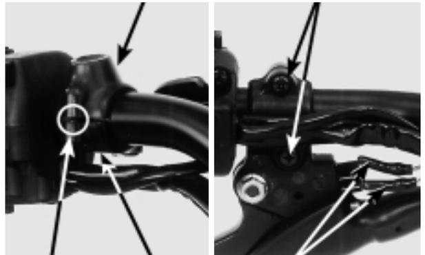
Conectar el conector del interruptor del embrague.
