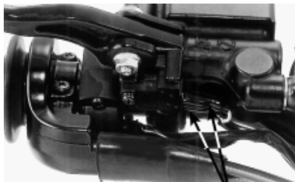
CONECTORES DE FRENO INTERRUPTOR DE LA LUZ DELANTERA
