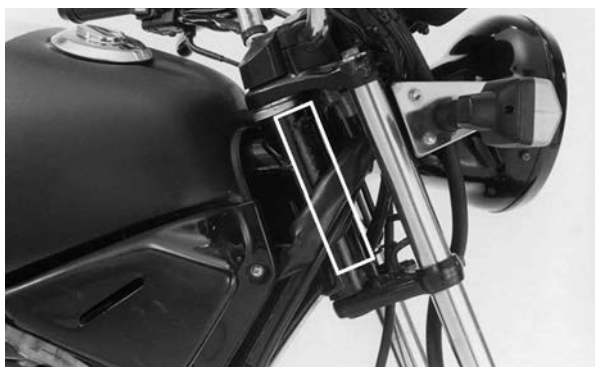
(1) El número de serie del chasis está grabado del lado derecho del conducto de la columna de dirección.
