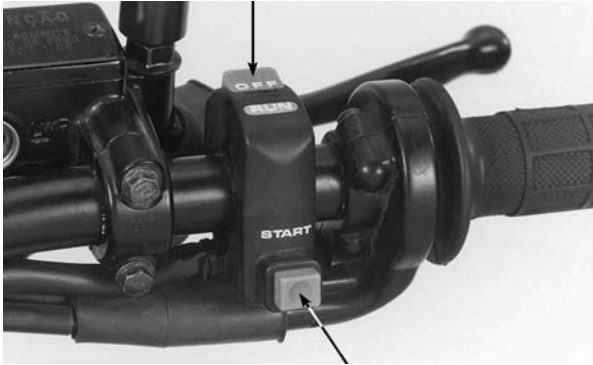
INTERRUPTOR DE ARRANQUE
