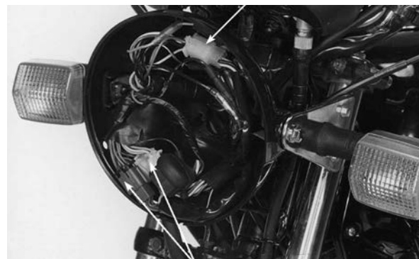
CONECTOR IZQUIERDO DE LOS INTERRUPTORES
