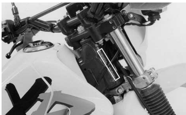
(1) El número de serie del chasis está grabado sobre el costado derecho de la columna de dirección.
