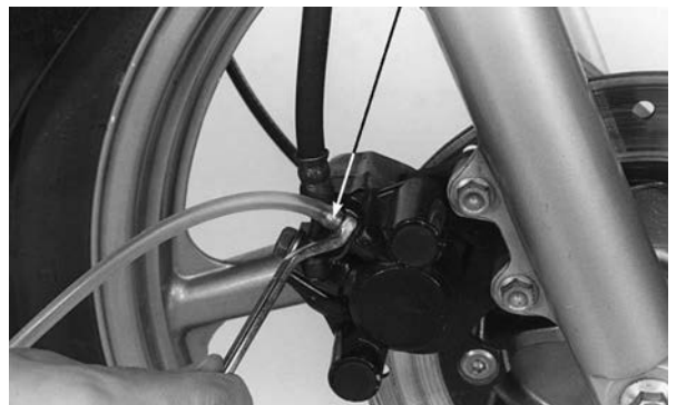
VALVULA DE PURGADO
