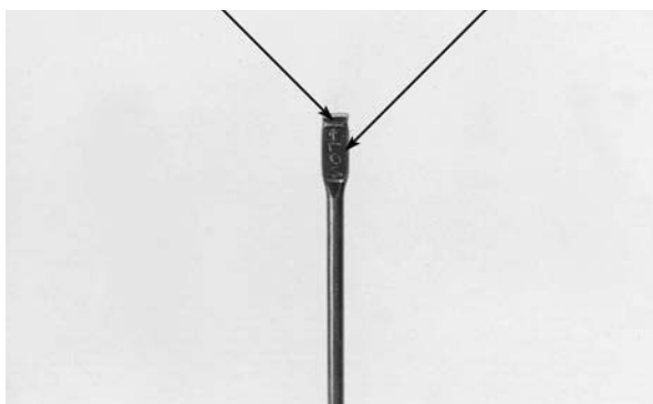
NIVEL INFERIOR MEDIDOR DEL NIVEL DE ACEITE
