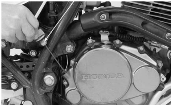
MEDIDOR DEL NIVEL DE ACEITE
