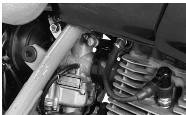
(3) El número de identificación del carburador está ubicado del lado derecho del cuerpo del carburador.
