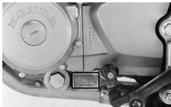
(2) El número de serie del motor está grabado en la parte inferior de la carcasa izquierda del motor.
