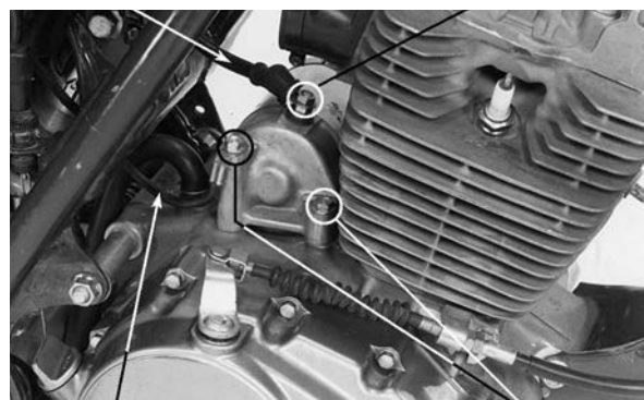
CABLE A TIERRA
