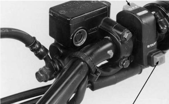
INTERRUPTOR DE ARRANQUE
