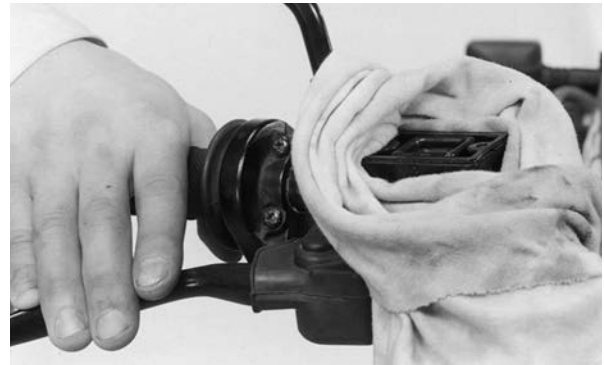
VALVULA DE PURGADO
