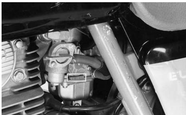
(3) El número de identificación del carburador está ubicado sobre el costado derecho del cuerpo del carburador.
