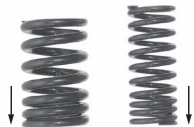
Lado de la cámara de combustión
