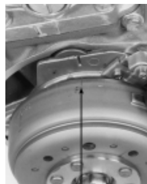
MARCAS DE AVANCE
