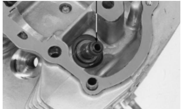
Lubrique los vástagos de las válvulas con aceite del motor.
