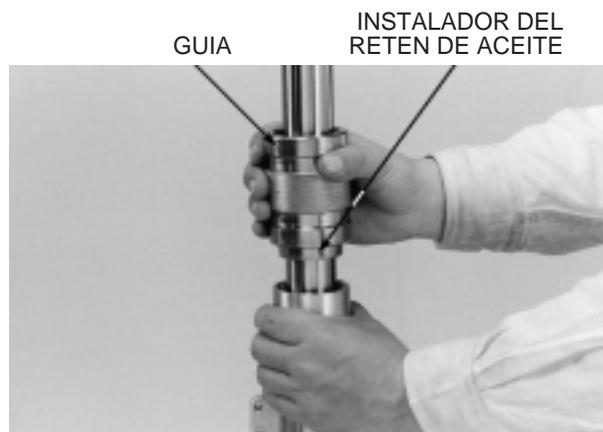
Instale la traba del retén de aceite en la canaleta del cilindro externo.
