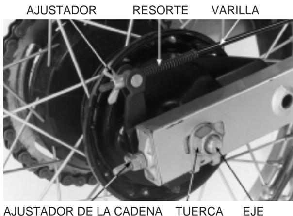
Suelte las tuercas de ajuste de la cadena de transmisión.
