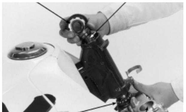
RODAMIENTO INFERIOR COLUMNA DE DIRECCION
