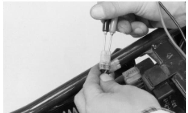
Si la resistencia estuviese fuera de la especificación, desconecte el conector de la bobina de excitación y mida la resistencia entre los cables negro/rojo y tierra.
