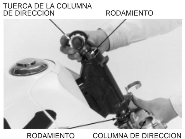
Apriete la tuerca de ajuste de la columna de dirección hasta apoyar en la pista cónica superior.
