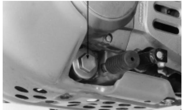
Instale y apriete el tapón de drenaje de acuerdo con el torque especificado.
