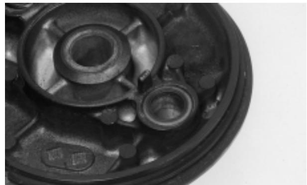
Instale el asiento de la leva en el espejo del freno, alineando la ranura del asiento con el reborde del espejo del freno.
