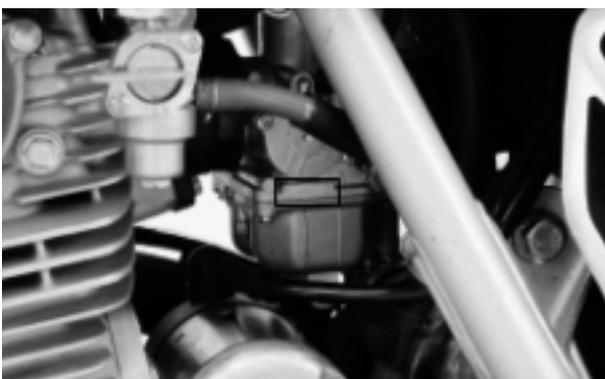
(3) El número de identificación del carburador está ubicado sobre el costado derecho del cuerpo del carburador.
