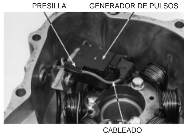
Introduzca el cojín del cableado en la ranura de la tapa izquierda del motor.
