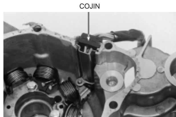
Aplique la traba química en las roscas de los tornillos del generador de pulsos.
