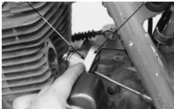
Apriete los tornillos de fijación del accionador del tensor de la cadena de comando.
