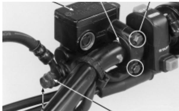
TORNILLO DE LA MANGUERA DE FRENO CALIBRE
