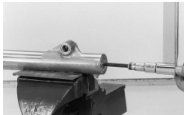
Instale el buje del cilindro externo a través del cilindro interno del amortiguador hasta que apoye en el cilindro externo.
