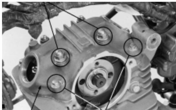
TAPA DEL CABEZAL TORNILLOS
