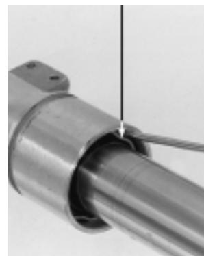
Asegure firmemente el amortiguador.
