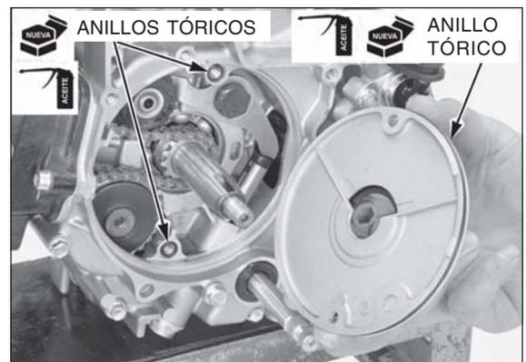
Instale la placa del separador de aceite y los tornillos; enseguida los apriete.
