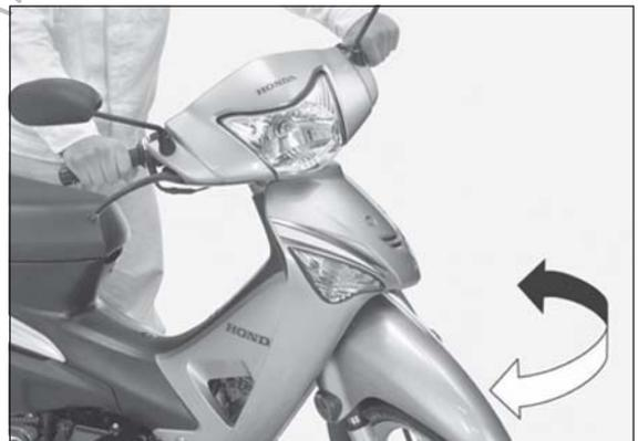
Verifique los cojinetes de la columna de dirección, sujetando firmemente las patillas de la horquilla e intentando mover la horquilla delantera hacia adelante y hacia atrás.
