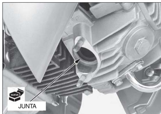
Ajuste el tubo de escape/silenciador en la posición correcta.
