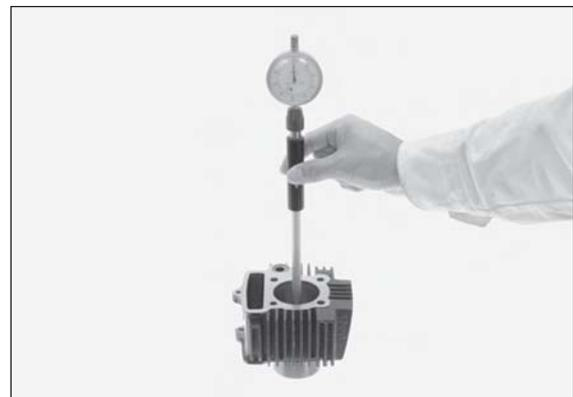
Calcule la conicidad del cilindro en tres puntos de los ejes X e Y. Utilice la mayor lectura para determinar la conicidad.
