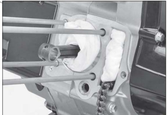
Aplique aceite para motor al pie de la biela, orificio del pasador del pistón y pasador del pistón.
