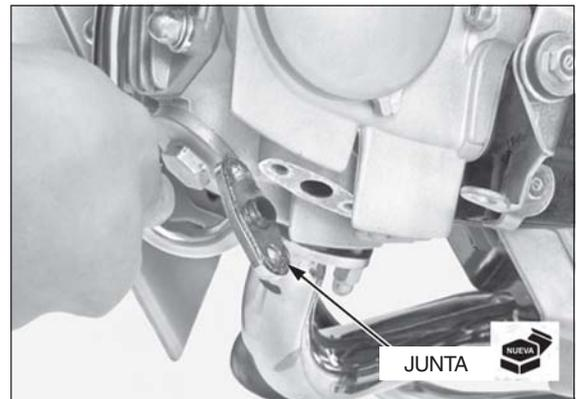
Ajuste el tubo de inyección de aire, guía de la manguera de drenaje del carburador y terminal de tierra en la posición correcta e instale provisionalmente los tornillos.
