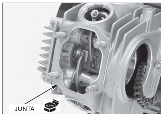
Instale la tapa de válvulas con la respectiva marca de flecha vuelta hacia abajo.
