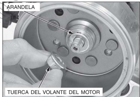
Sujete el volante del motor, utilizando la herramienta especial y apriete la tuerca del volante del motor de acuerdo con el par de apriete especificado.
