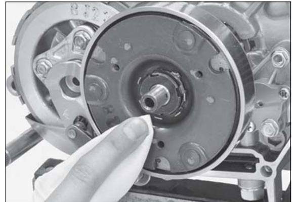
Instale una nueva junta con el lado sellado vuelto hacia la tapa del filtro centrífugo de aceite.
