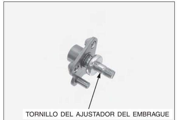
Instale el ajustador del embrague/guía del accionador en la tapa derecha de la carcasa del motor, alineando la guía con el orificio en la tapa de la carcasa del motor.
