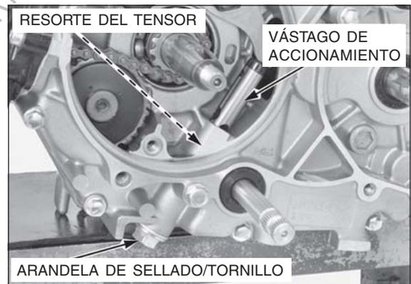
Remueva el tornillo del pivote, brazo tensor y rodillo del tensor.
