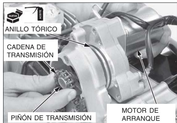
Instale el cable negativo (-) del motor de arranque/tornillos de fijación y luego apriételos.
