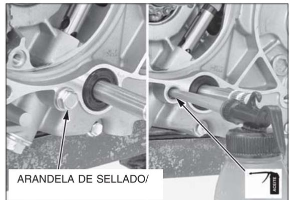
Aplique aceite para motor a los nuevos anillos tóricos y los instale en la ranura de la carcasa del motor y ranura de la placa del separador.
