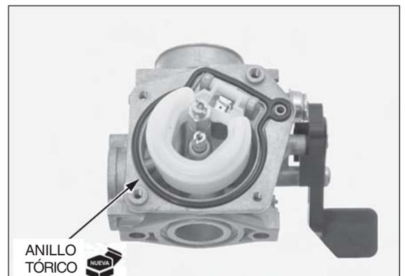
Instale la cámara del flotador.
