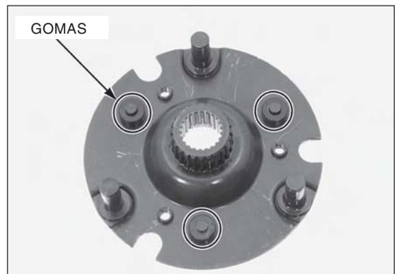
Inspeccione las guías de la placa de accionamiento con respecto a desgaste o a daños.
