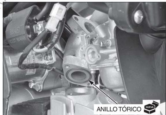
Instale el tubo de entrada y los tornillos en la culata.
