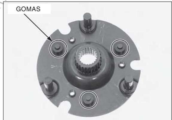
Aplique aceite para motor a los pivotes de la placa de accionamiento. Instale los contrapesos del embrague y los resortes en la placa de accionamiento, como se muestra en la figura.
