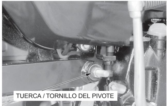
Instale los amortiguadores traseros en los pivotes inferiores; a continuación, instale las arandelas y las tuercas de montaje inferiores.
