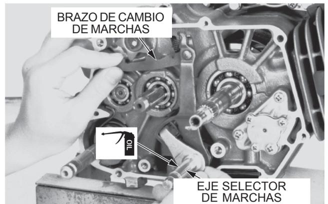
Instale el resorte de retorno, brazo posicionador y enseguida, apriete el tornillo, según el par de apriete especificado.
