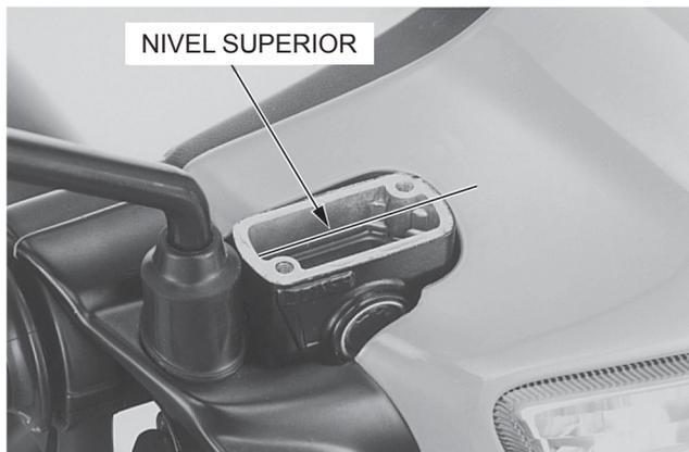
Instale el diafragma, placa de ajuste y tapa del depósito. Apriete los tornillos, según el par de apriete especificado.
