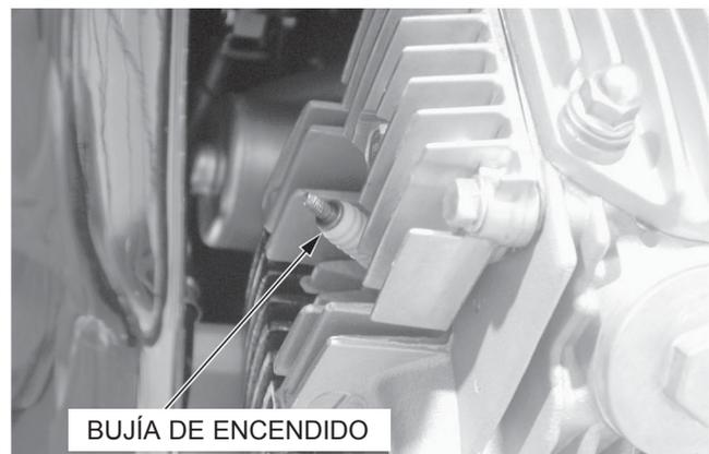
Remueva la bujía de encendido, utilizando una llave para bujías de encendido o equivalente. Inspeccione o reemplace según descrito en la tabla de mantenimiento (página 3-3).
