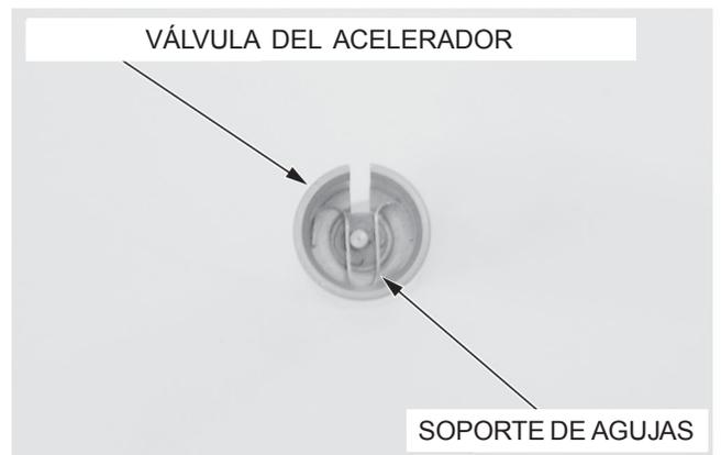
Instale el resorte de la válvula del acelerador en el cable del acelerador.
