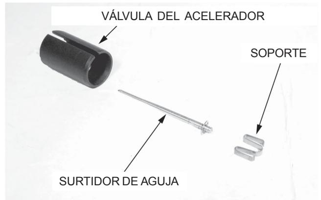
Instale el soporte de aguja del surtidor en la válvula del acelerador.
