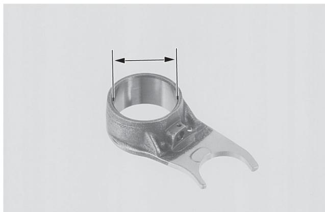
Mida el espesor de la garra de la horquilla de cambios.
