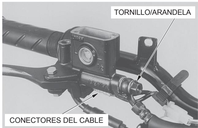
Remueva los tornillos del soporte del cilindro maestro, soporte y cilindro maestro.
