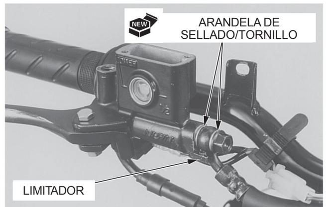
Conecte los conectores del cable del interruptor de la luz de freno.
