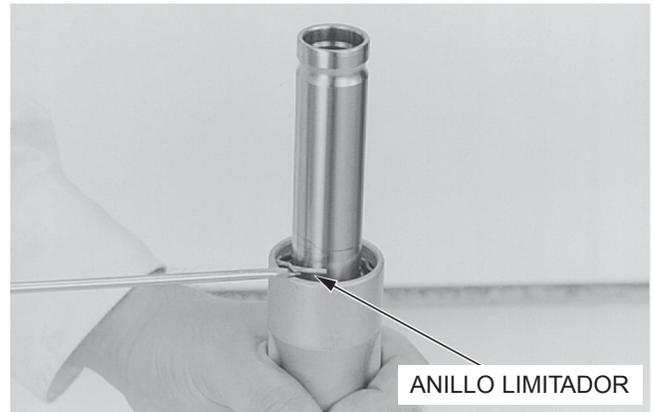
Sujete la corredera de la horquilla en un tornillo de banco con mordazas blandas o un trapo. Remueva el tornillo Allen de la horquilla y la arandela de sellado, utilizando una llave hexagonal.
