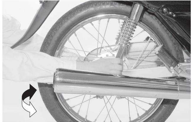
Verifique con respecto a cojinete de la rueda desgastado, sujetando la rueda trasera y tratando de mover la rueda de lado a lado.
