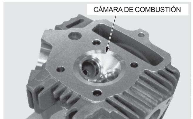
Inspeccione la culata del motor con respecto a alabeo, utilizando una regla de acero y un calibrador de espesores.
