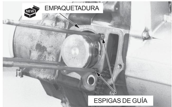
Aplique aceite limpio de motor a la superficie exterior del pistón y a las ranuras del anillo del pistón y al orificio del cilindro. Instale el cilindro mientras comprime los anillos del pistón.
