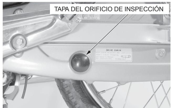
Verifique la holgura en la cadena de transmisión a través del orificio de inspección.
