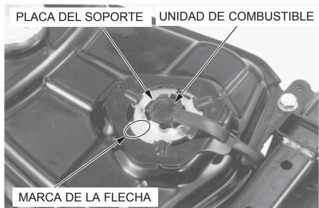
Encamine el cable de la unidad de combustible y conecte el conector 3P.
