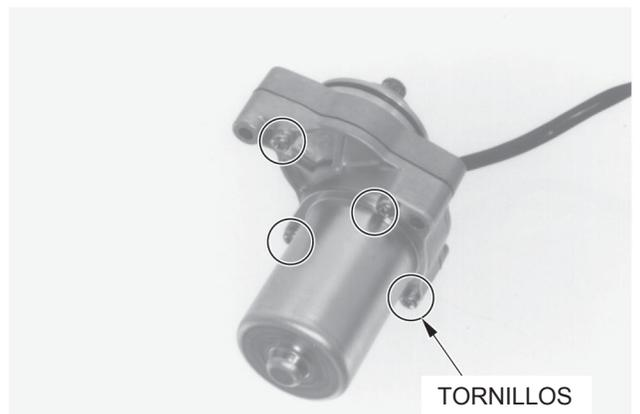
Instale el cable en el motor de arranque y apriete el tornillo.
