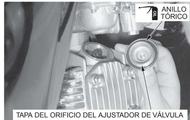
Inspeccione si los anillos tóricos de la tapa del orificio de sincronización y de la tapa del orificio del cigüeñal están en buenas condiciones; los reemplace, si fuese necesario.
