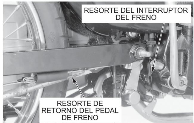
Instale el pasador de la empaquetadura en el brazo de freno; enseguida, instale el resorte de freno, tirante del freno y tuerca de ajuste.
