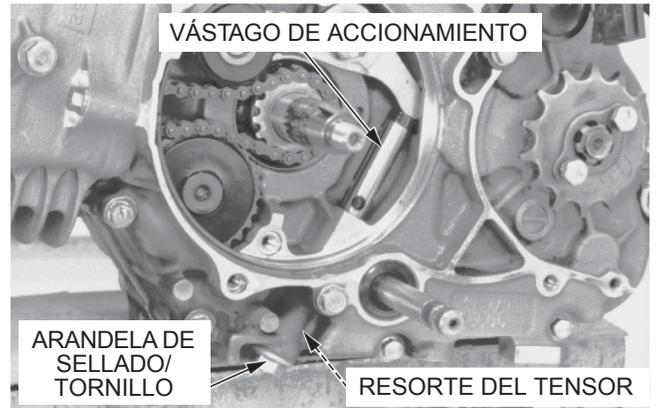
Remueva el tornillo del pivote, brazo del tensor y el rodillo del tensor.
