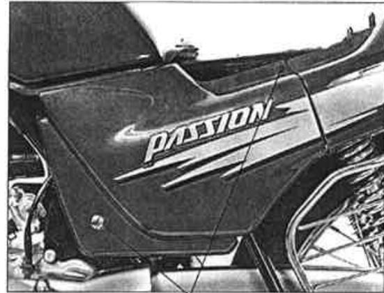
TORNILLOS DE LA CUBIERTA LATERAL
