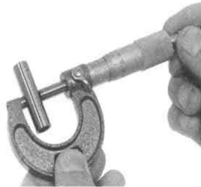
**INSPECCIÓN DEL EJE DE LEVAS**
