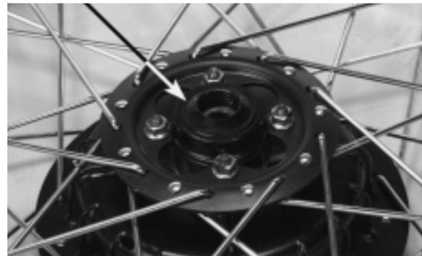
Instale el cabezal del extractor en el rodamiento.
