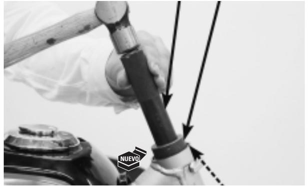
PISTA EXTERIOR DEL RODAMIENTO INFERIOR
