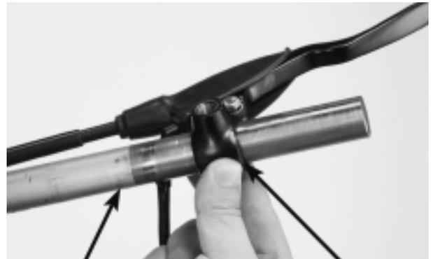
MANILLAR SOPORTE DE LA PALANCA DEL FRENO
