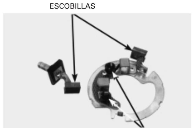
Instale el conjunto del portaescobillas en la tapa trasera, alineando su resalte con la ranura en la tapa trasera.
