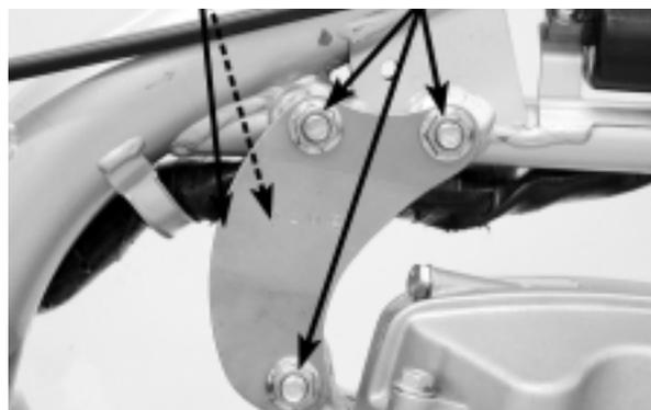
Apriete los tornillos/tuercas de fijación y de los soportes del motor al par de apriete especificado.
