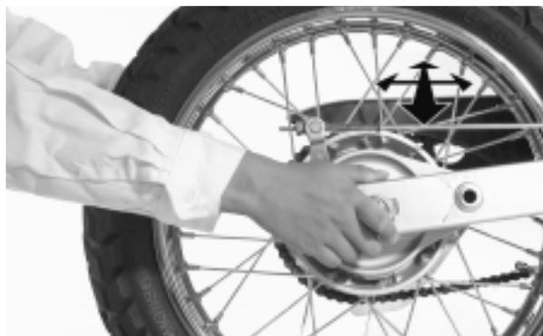
Inspeccione la acción del amortiguador trasero comprimiendo el extremo trasero varias veces. Inspeccione todo el conjunto del amortiguador con respecto a fugas o a daños.
