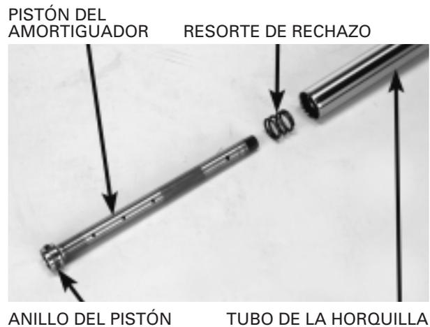
Instale el retén de aceite en la extremidad del pistón del amortiguador.
