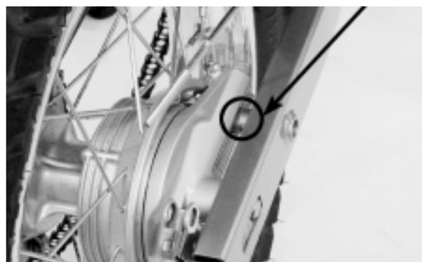
Coloque la rueda trasera en el bastidor y alinee los agujeros del collarín con los agujeros del ajustador de la cadena de transmisión.
