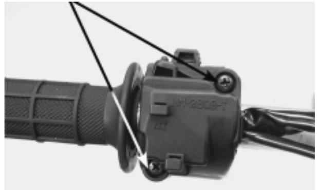
Instale los soportes de la palanca del embrague en el manillar.
