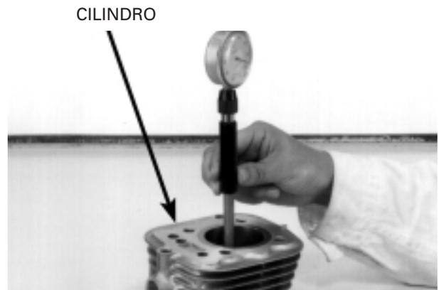
Mida el cilindro con respecto a conicidad en tres puntos (parte superior, centro y base de la carrera del pistón) y en dos direcciones, X e Y, en ángulo recto.
