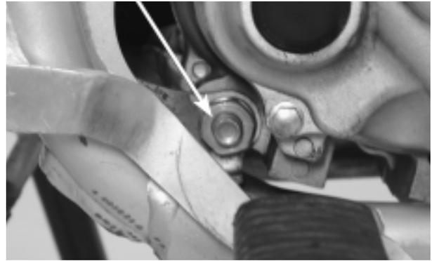
Instale el tornillo/tuerca de fijación delantera inferior del motor (8 mm).
