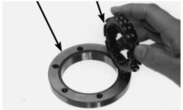
**INSPECCION DEL EMBRAGUE DEL ARRANQUE (Solamente Tipo ES:)**
