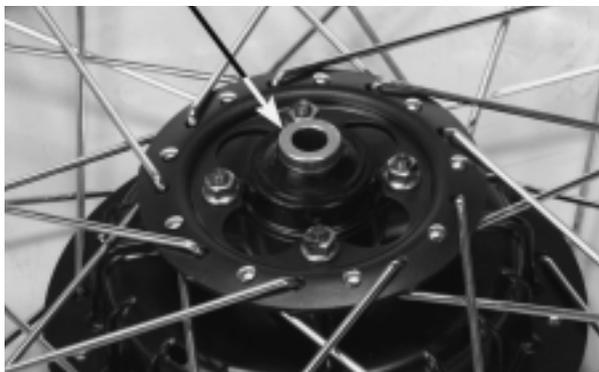
Instale el panel del freno alineando las lengüetas del retén del engranaje del velocímetro con las ranuras en el cubo de la rueda.
