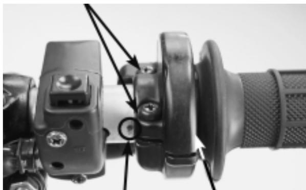
Instale la tapa del soporte del acelerador.
