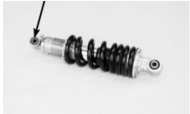
**REEMPLAZO DEL RODAMIENTO DE AGUJAS**
