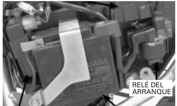
MODULO DE CONTROL DEL ENCENDIDO (ICM) BATERIA
