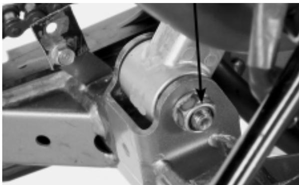
Quite el tornillo de fijación superior del amortiguador.
