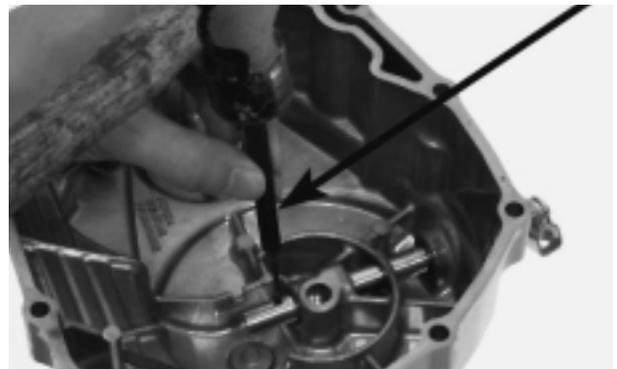
Quite el brazo de accionamiento del embrague. Verifique el guardapolvo con respecto a daños o desgaste. Reemplácelo, si necesario.
