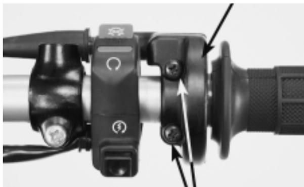
GUÍA DEL CABLE DEL ACELERADOR
