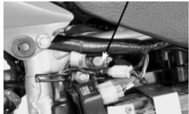
TORNILLO/TUERCA DE FIJACIÓN INFERIOR DEL AMORTIGUADOR
