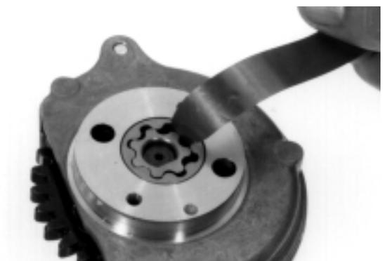
Mida la holgura entre el rotor externo y la carcasa de la bomba.
