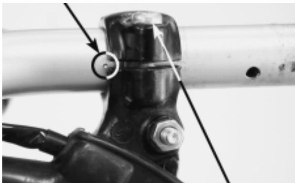
PERNO DEL SOPORTE DE LA PALANCA DEL FRENO
