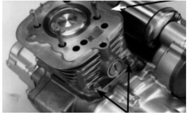
PERNOS DE FIJACIÓN DEL CILINDRO
