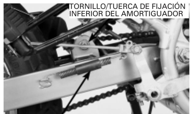
TORNILLO/TUERCA DE FIJACIÓN INFERIOR DEL AMORTIGUADOR
