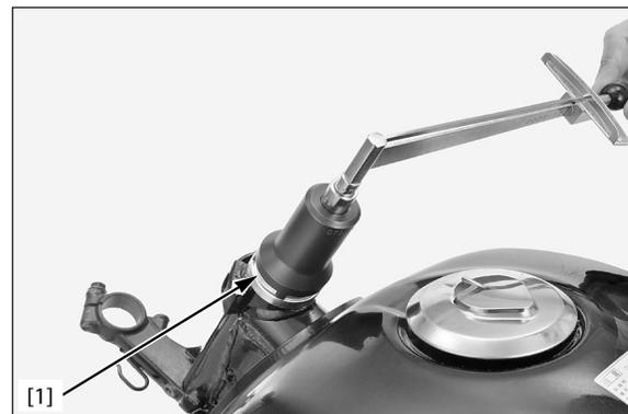
Instale provisoriamente los tubos de la horquilla, enseguida apriete la tuerca de la columna al par especificado.
