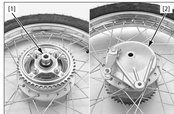
Coloque la rueda trasera en el brazo oscilante e instale la cadena de transmisión en la corona.
