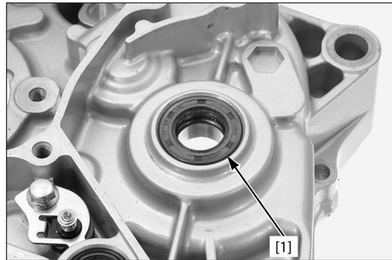
Extraiga el cojinete [1] del eje secundario desde la carcasa izquierda del motor.
