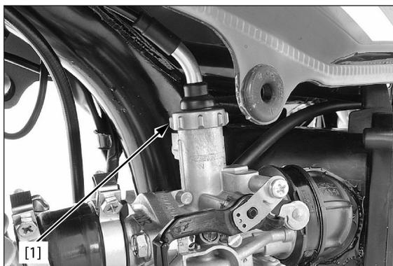
Desconecte la manguera de drenaje [1] del carburador.
