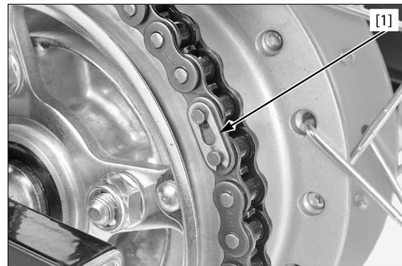
Instale la cadena de transmisión en la corona y piñón de transmisión.
