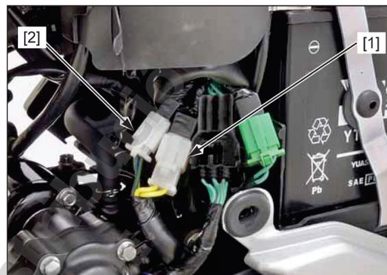
Suelte el cable del interruptor de posición de la transmisión [1] de las guías para cables [2] en la tapa izquierda de la carcasa del motor.
