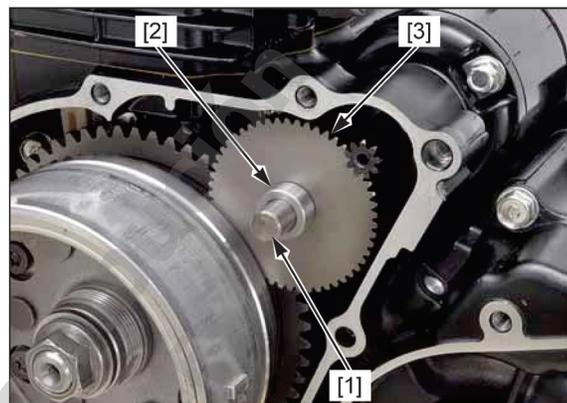
Sujete el volante del motor usando la herramienta especial y quite la tuerca [1] y la arandela [2].
