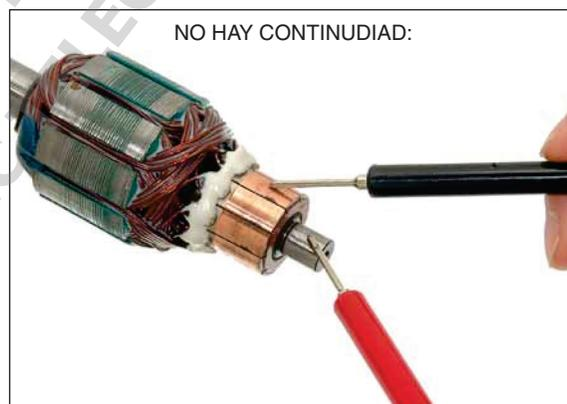
Inspeccione la continuidad entre la escobilla aislada y el terminal del cable.
