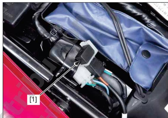
Inspeccione la continuidad entre los terminales del diodo.
