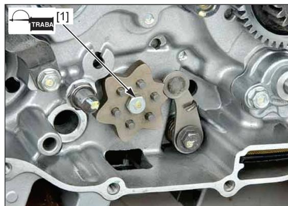
Aplique aceite del motor al área de rodadura del eje del selector de marchas.
