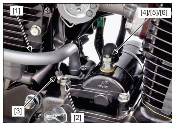
Desconecte el conector 2P [1] del sensor EOT.
