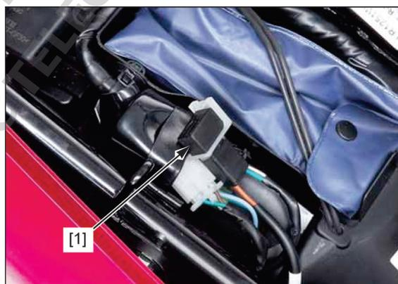
Inspeccione la continuidad entre los terminales del diodo [1].
