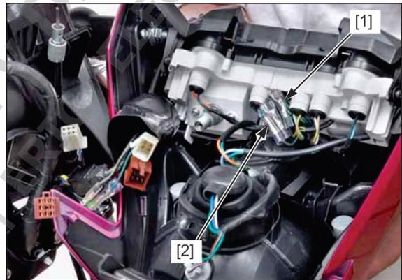
Desconecte el conector del cable Marrón/amarillo [1] del tablero de instrumentos.
