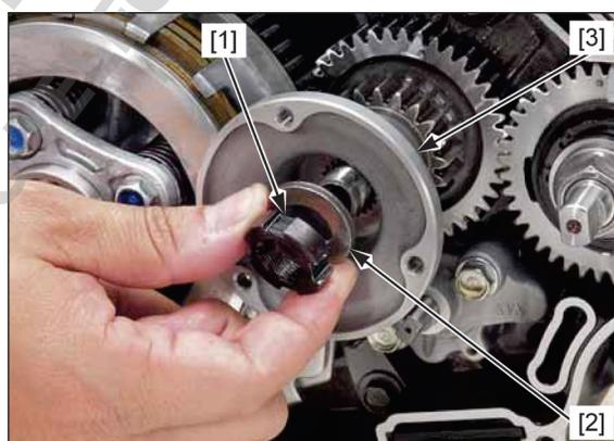
Suelte los tornillos de la placa de accionamiento del embrague [1] de forma cruzada en varias etapas.
