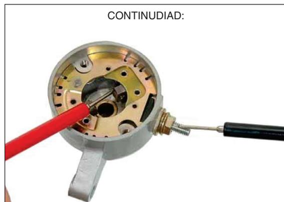
Inspeccione la continuidad entre la escobilla aislada y la tapa trasera.
