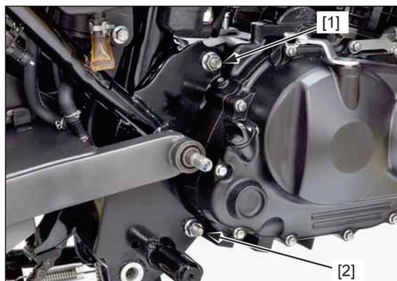
Apriete las tuercas delanteras de fijación del motor [1] (lado del chasis) al par de apriete especificado.
