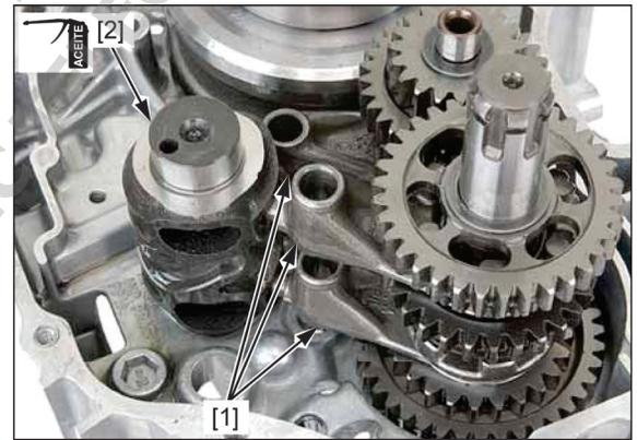
Aplique aceite del motor a los ejes de la horquilla selectora [1] e insértelos en la carcasa derecha del motor, a través de las horquillas selectoras.
