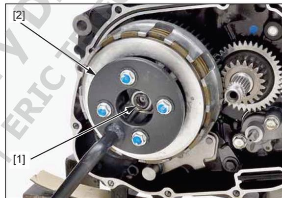
Instale los resortes del embrague [1], la placa de accionamiento [2] y los tornillos [3].
