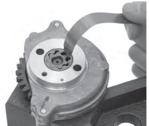
Mida la holgura entre el rotor exterior y la carcasa de la bomba.
