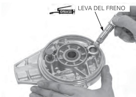
Instale la placa indicadora de desgaste en la leva del freno alineando sus dientes anchos con la ranura ancha en la leva del freno.
