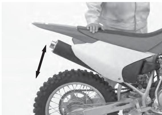
Apoye la motocicleta firmemente y levante la rueda trasera del suelo colocando un caballete o un cajón debajo del motor.
