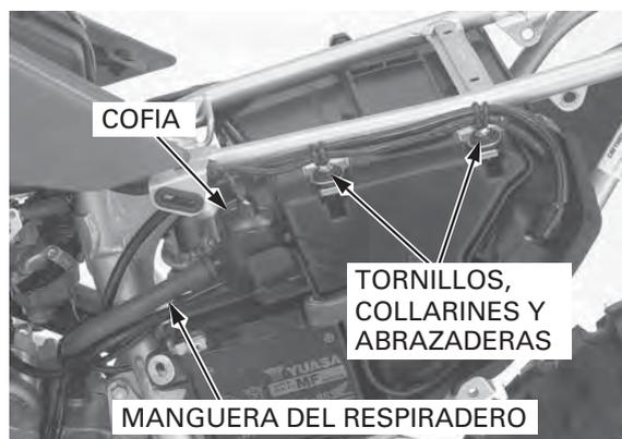
Afloje la abrazadera del tubo de conexión.
