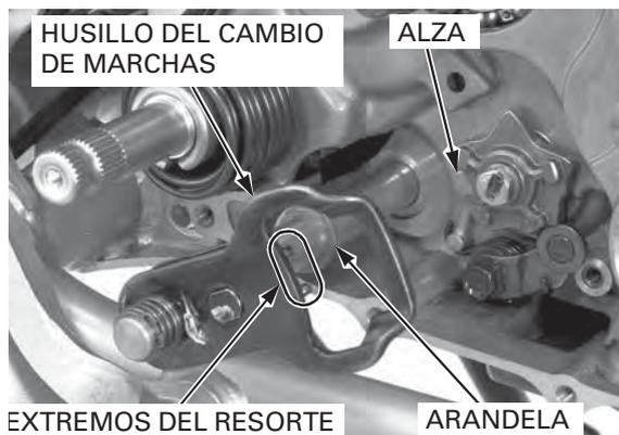
Instale el pedal del cambio de marchas de forma que la distancia entre la línea de centro horizontal de la tapa del orificio del cigüeñal y el pedal del cambio de marchas sea de 59 mm (2,3 pulg.).
