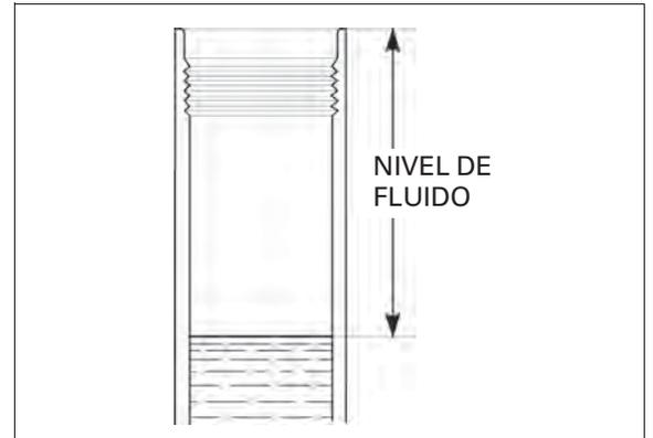
Tire del tubo de la horquilla hacia arriba e instale el resorte de la horquilla con el extremo de espiras más juntas vuelto hacia abajo.
