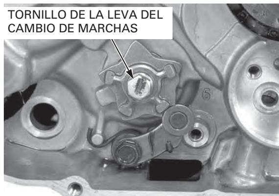
Instale la arandela de empuje en el husillo de cambio de marchas e inserte el husillo en la carcasa del motor; alinee los extremos del resorte de retorno con la alza en la carcasa del motor.
