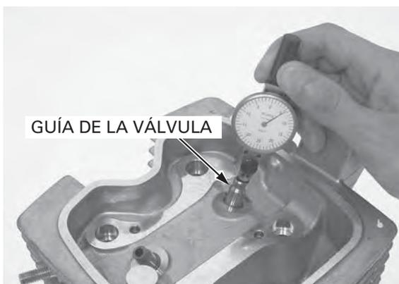
*Inspeccione y rectifique los asientos de válvula siempre que las guías de válvula fuesen reemplazadas (página 9-17).*
