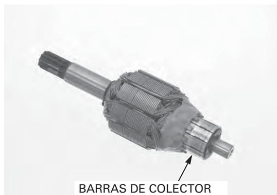
Inspeccione en cuanto a la continuidad entre las barras de colector. Debe haber continuidad.
