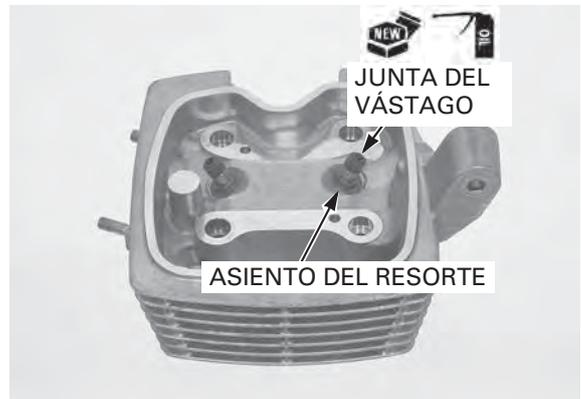
Lubrique la superficie deslizante del vástago de válvula con solución de aceite de molibdeno.
