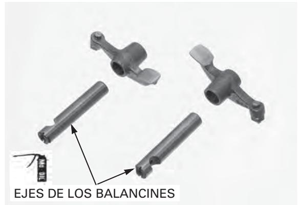
Coloque los balancines en la tapa de la culata. Instale los ejes de los balancines a través de la tapa de la culata y de los balancines.
