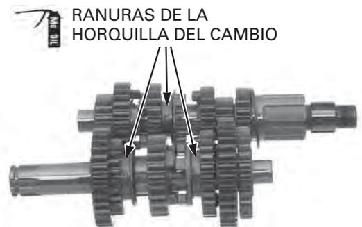
Instale el eje principal y el contraeje como un conjunto dentro de la carcasa izquierda del motor.
