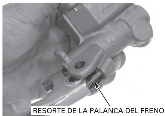
Aplice grasa a base de silicona a la superficie deslizante del tornillo pivote de la palanca de freno. Instale y apriete el tornillo pivote.
