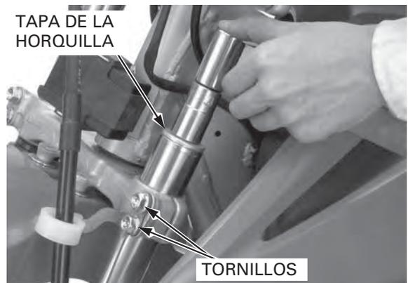
Alinee el extremo de la parte superior del tubo de la horquilla con la superficie superior del puente superior, como se muestra.
