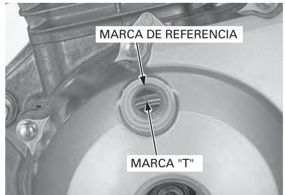
Las líneas de referencia en la rueda de distribución deben estar a ras de la superficie de la culata y la marca de sincronización "o" debe estar vuelta hacia la parte delantera (PMS; punto muerto superior en la carrera de compresión).
