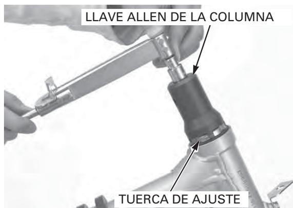
Instale el puente superior, la arandela y la tuerca de la columna.
