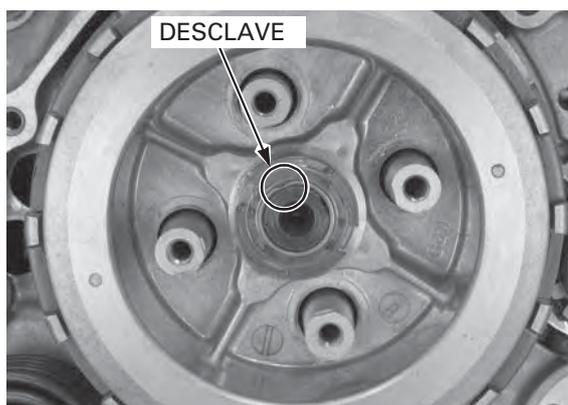
Acople el soporte central del embrague en la placa de presión usando cuatro tornillos del resorte del embrague para sujetar el soporte central del embrague y aflojar la contratuerca del soporte central del embrague, usando las herramientas especiales.
