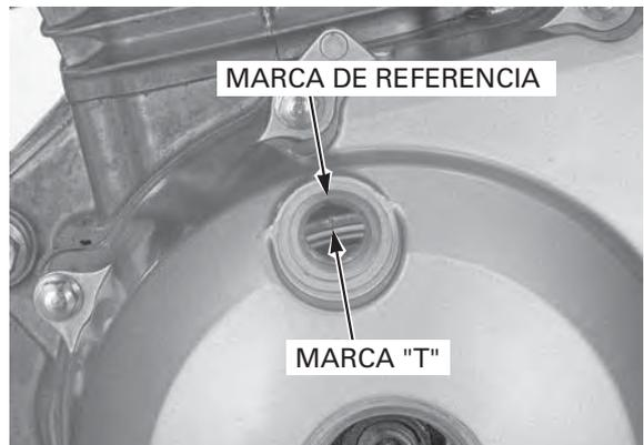
Las líneas de referencia en la rueda de distribución de la excéntrica deben estar a ras de la superficie de la culata y la marca de sincronización "o" debe estar vuelta hacia la parte delantera (PMS; punto muerto superior en la carrera de compresión).
