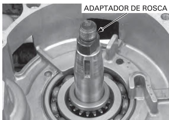
Provisoriamente, monte las dos mitades de la carcasa utilizando la herramienta de montaje de la carcasa para traccionar el cigüeñal dentro de la carcasa izquierda del motor.
