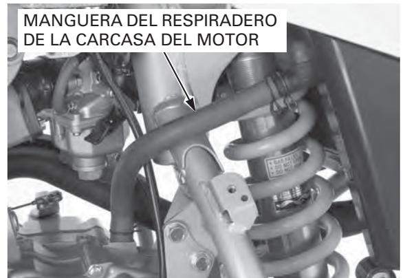
Empuje lo tubo de drenaje abierta para evacuar cualquier depósito.
