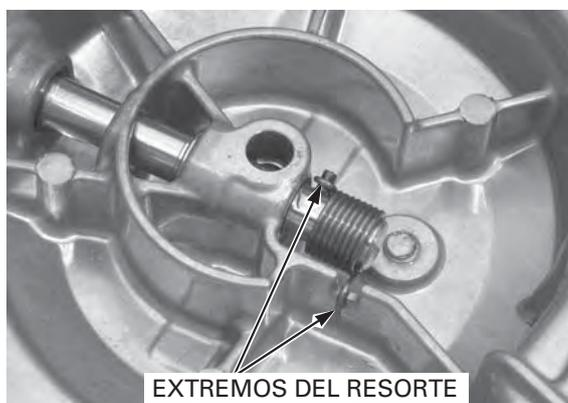
Instale la pieza del levantador en la ranura del brazo del levantador; alinee la ranura con el orificio de la pieza del levantador.
