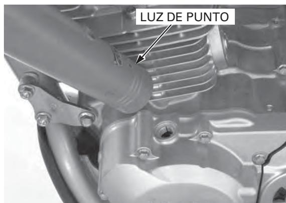
El punto de encendido está correcto si la marca "F" en el volante del motor está alineada con la marca de referencia en la tapa de la carcasa del motor izquierda.
