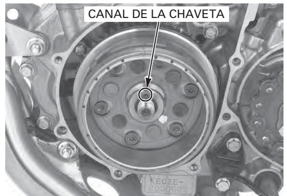
Aplice aceite de motor en las roscas de la tuerca del volante del motor y en la superficie de asentamiento.
