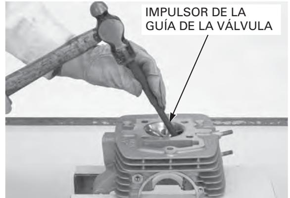
Mientras la culata del motor aún esté calentada, quite las nuevas guías de válvula del congelador e instale los nuevos anillos tóricos en las guías de válvula.
