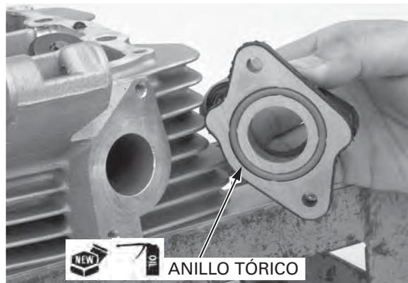
Instale el aislador y apriete los dos tornillos firmemente.
