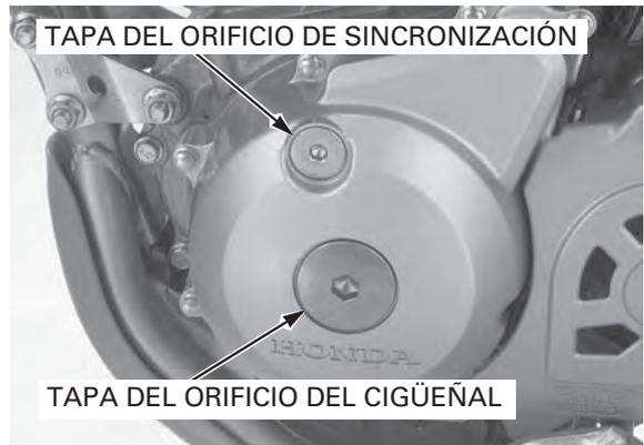
Gire el cigüeñal en sentido contra horario y alinee la marca "T" en el volante del motor con la marca de referencia en la tapa de la carcasa del motor.
