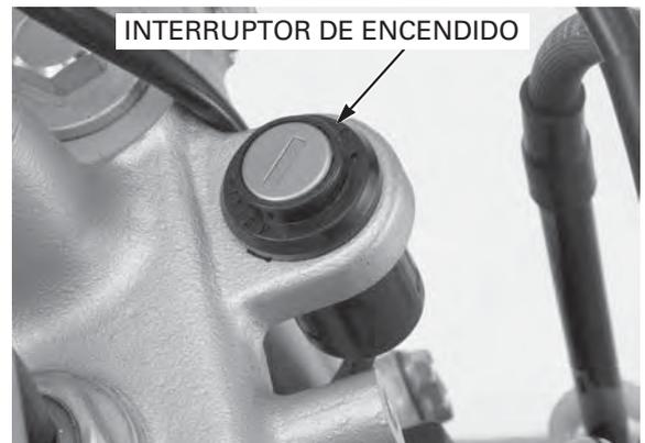
Instale el interruptor de encendido, alineando la lengüeta posicionadora con la ranura ubicada en el puente superior.
