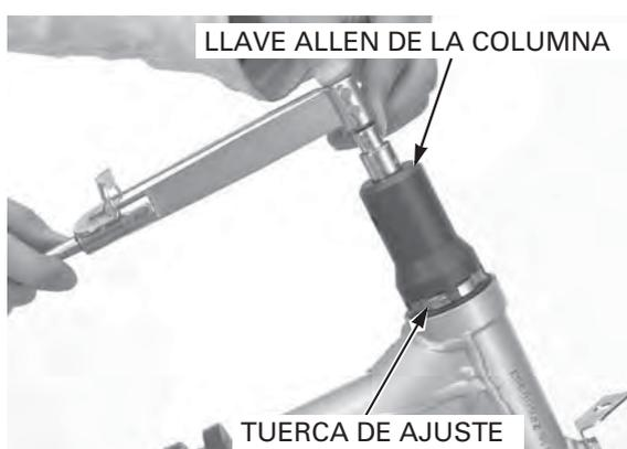
Mueva la columna de dirección hacia la derecha y hacia la izquierda, trábela y destrábela varias veces para asentar los rodamientos.
