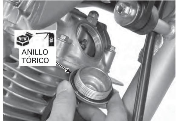
Lubrique los nuevos anillos tóricos con aceite para motor y los instale en las tapas de los orificios.
