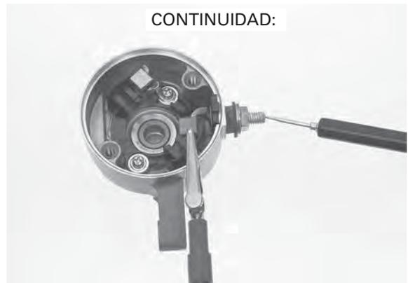
Inspeccione en cuanto a la continuidad entre el borne del cable y la tapa trasera.
