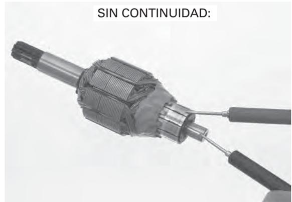
Inspeccione en cuanto a la continuidad entre el borne del cable y la escobilla aisladora.
