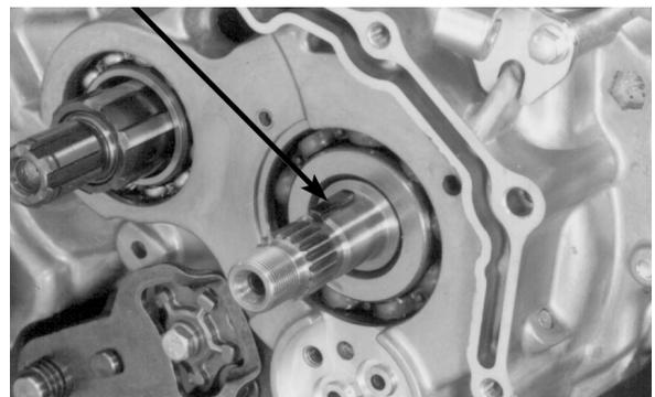
Instale la campana del embrague y la arandela estriada.
