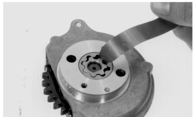
Mida la holgura entre los rotores y el flanco de la carcasa de la bomba.
