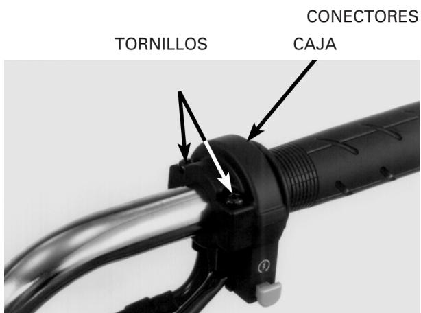
Suelte el cable del acelerador de la empuñadura del acelerador. Enseguida, quite la empuñadura.
