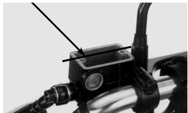
Instale el diafragma, la placa de fijación y la tapa del depósito. Apriete los tornillos al par especificado.
