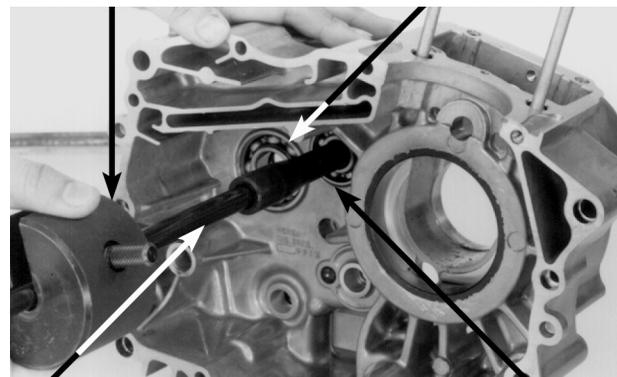
EXTRACTOR DE RODAMIENTOS RODAMIENTO DEL EJE PRINCIPAL
