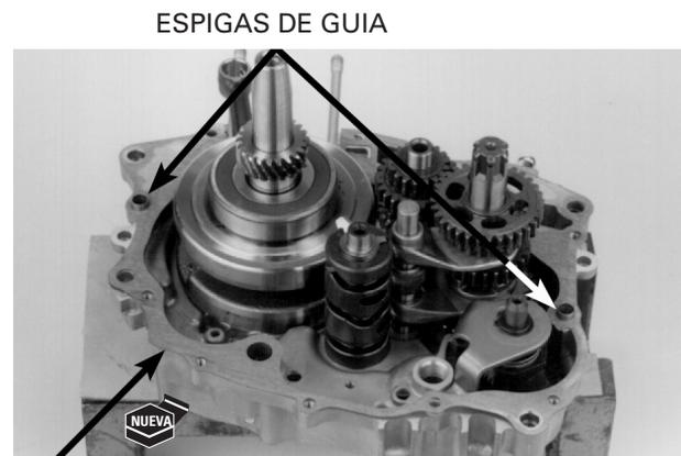
Instale la carcasa izquierda en la carcasa derecha.
