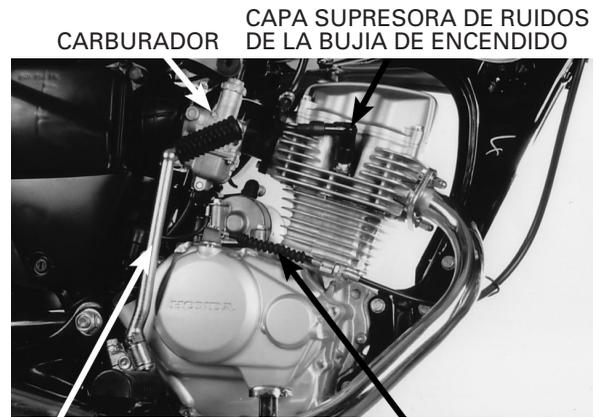
CARBURADOR      CAPA SUPRESORA DE RUIDOS DE LA BUJIA DE ENCENDIDO
