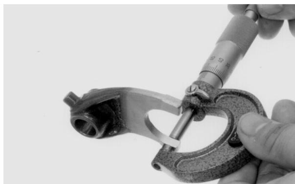
Verifique si el eje de las horquillas del cambio de marchas está alabeado, desgastado o dañado.
