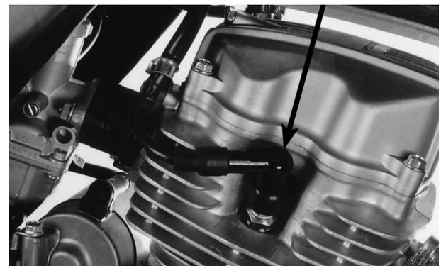
Quite la bujía de encendido utilizando la llave de bujías o alguna herramienta equivalente.
