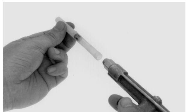
Instale el nuevo anillo tórico en el filtro de tamiz y, en seguida, instale el filtro en el tanque de combustible.
