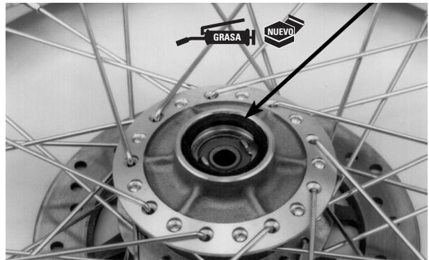
Instale la caja de engranajes del velocímetro en el cubo izquierdo de la rueda alineando sus lengüetas con los entalles.
