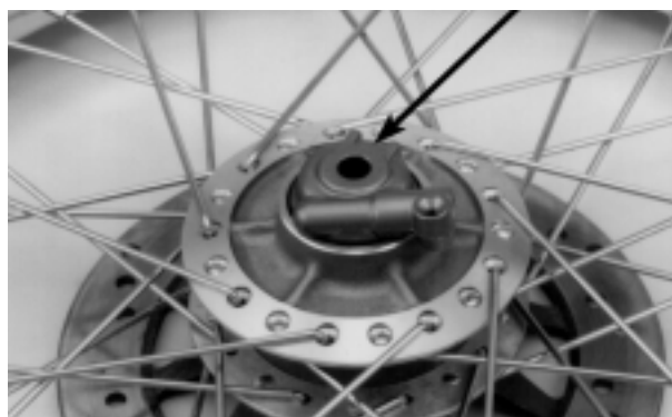
COLLARIN LATERAL CAJA DE ENGRANAJES
