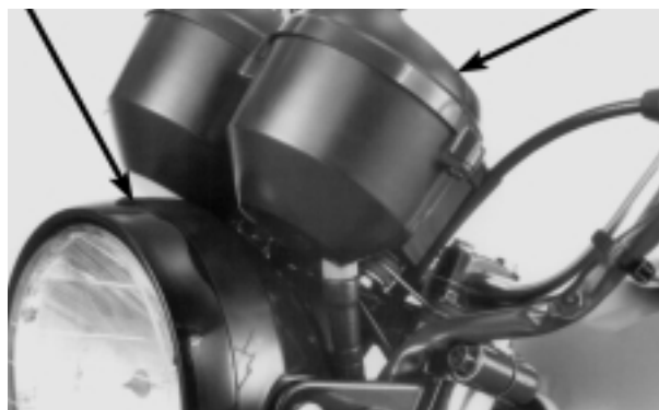
CARCASA DEL FARO CUADRO DE INSTRUMENTOS
