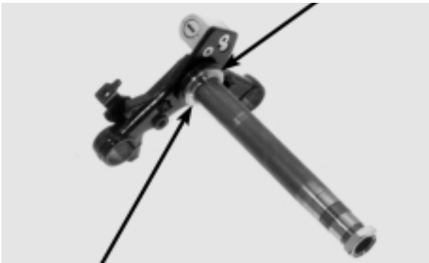
PISTA CONICA IMPULSOR DEL RODAMIENTO DE LA COLUMNA DE DIRECCION
