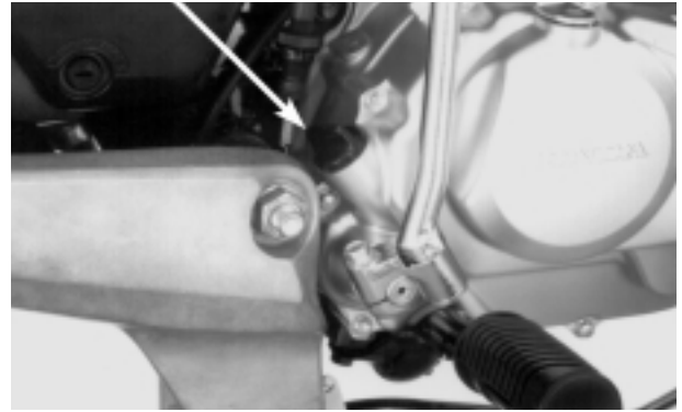
TAPA DE SUMINISTRO/ BAYONETA DE MEDICION DEL NIVEL DE ACEITE
