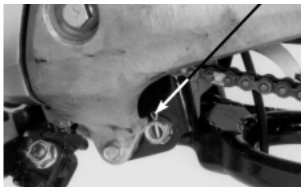
RESORTE DE RETORNO DEL FRENO PASADOR HENDIDO
