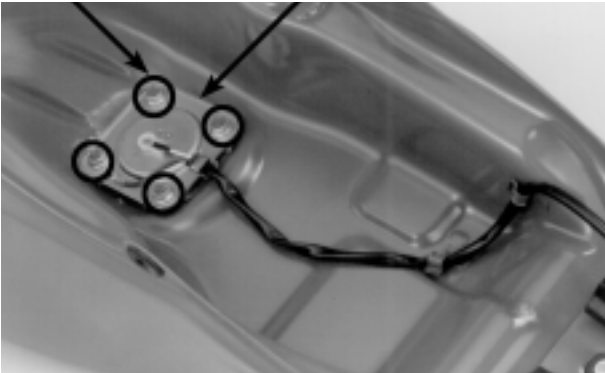
TUERCAS SENSOR DEL NIVEL DE COMBUSTIBLE
