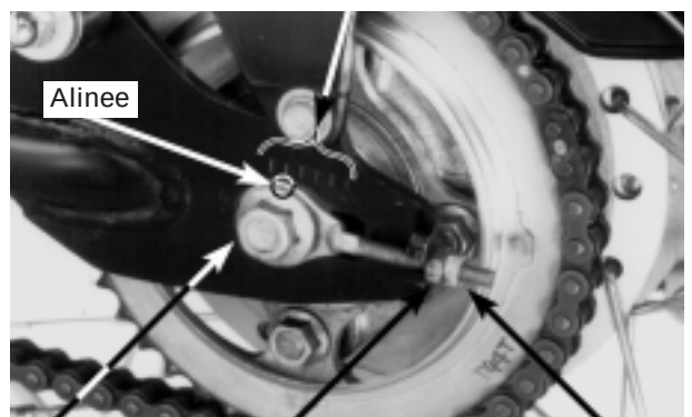
EJE TUERCA DE AJUSTE CONTRATUERCA TUERCA DEL EJE
