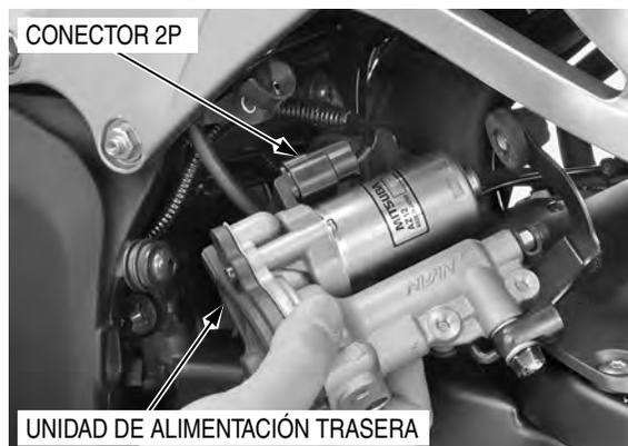
Instale la unidad de alimentación en el bastidor y apriete los tornillos con firmeza.
