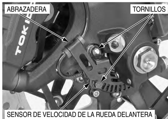
Desmonte los tornillos y las pinzas del freno.
