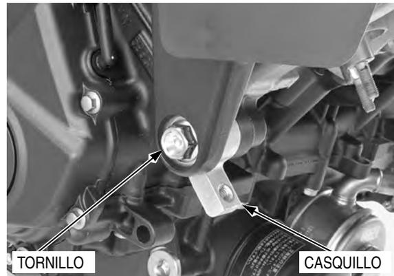
Gire el tornillo de ajuste del cáncamo de suspensión superior e inferior del motor girando el tornillo de éste hasta que el tornillo de ajuste quede asentado sobre el motor.
