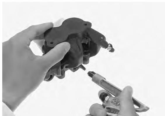
*Tenga cuidado de no dañar la superficie deslizante del pistón.* Empuje hacia dentro las juntas guardapolvo y las juntas de estanqueidad de los pistones y levántelas hacia fuera. Limpie las ranuras de cierre con líquido de frenos limpio.
