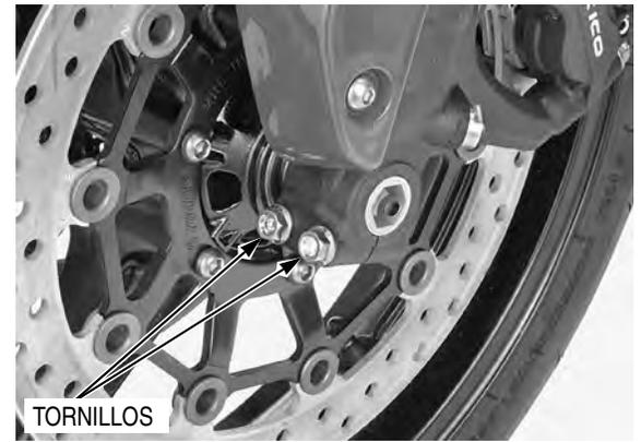
Monte el sensor de velocidad de la rueda delantera, la abrazadera para cables y apriete los tornillos.
