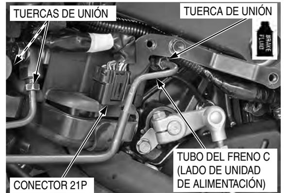
Aplique líquido de frenos a las roscas de tuerca de unión del tubo del freno.
