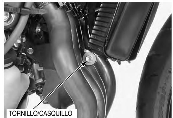
Desmonte el tornillo de fijación del radiador superior y la arandela de estanqueidad.
