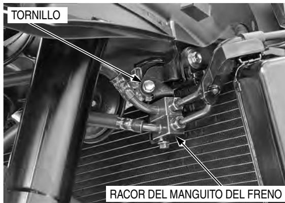
Monte la protección del tubo del agua y apriete firmemente el tornillo.
