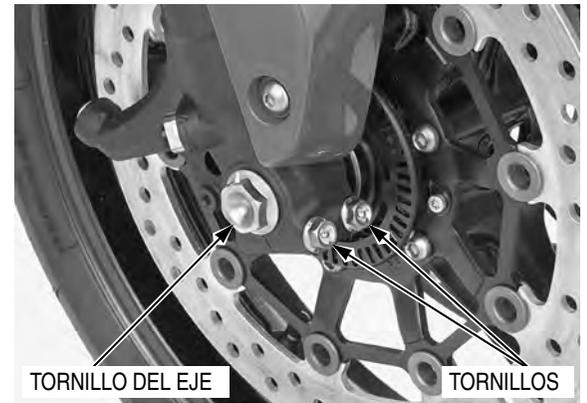
Afloje los tornillos del soporte del eje izquierdo.
