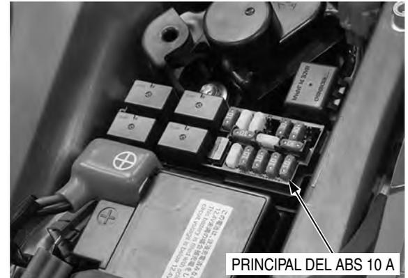
**2. Comprobación de la existencia de un cortocircuito en la línea de entrada de corriente del ABS**
