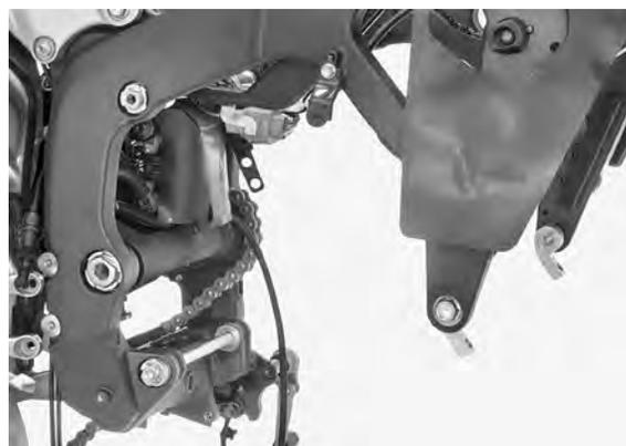
Monte los tornillos de ajuste del cáncamo de suspensión del motor superior e inferior desde el interior del bastidor.
