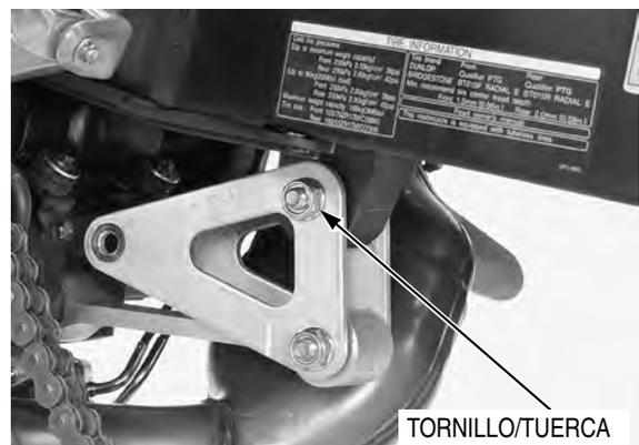
Desmonte la tuerca y arandela de giro del basculante.
