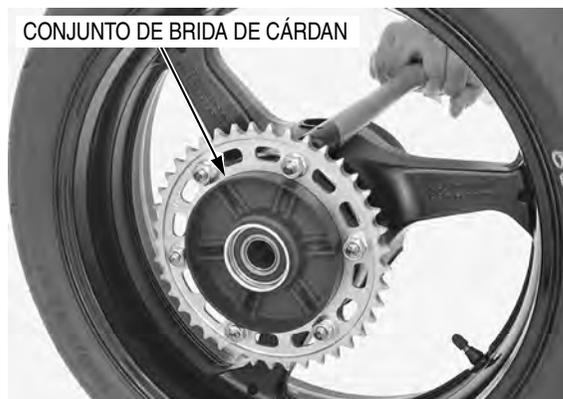
Si sustituyó el piñón conducido, desmonte las tuercas, las arandelas, el piñón conducido y los tornillos.
