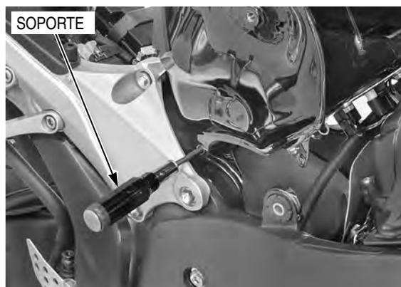
Monte las arandelas y los tornillos de fijación del depósito de combustible.
