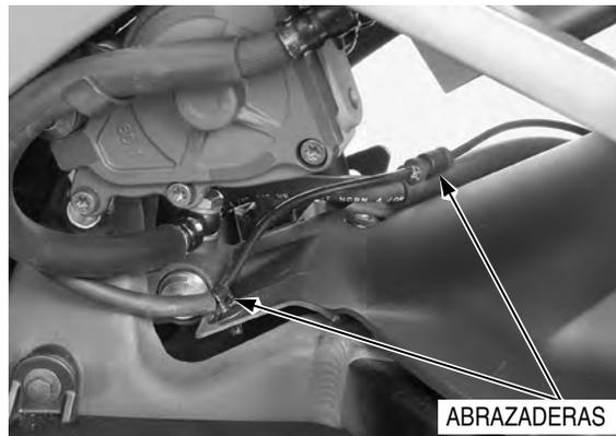
Desconecte el conector 2P (rojo) del sensor de velocidad de la rueda trasera.
