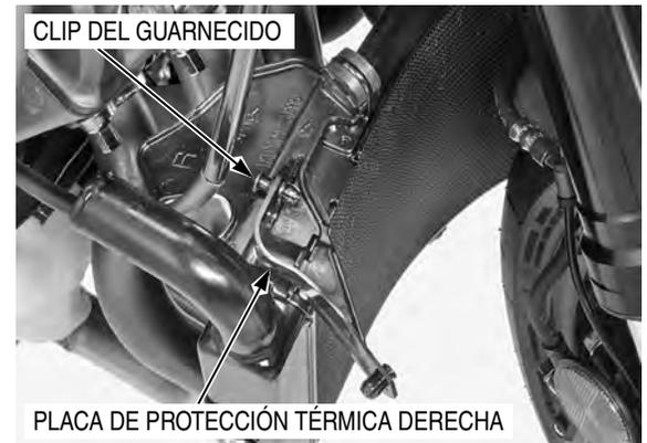
Conecte el manguito del radiador derecho y apriete firmemente el tornillo de la abrazadera del manguito (página 7-19).
