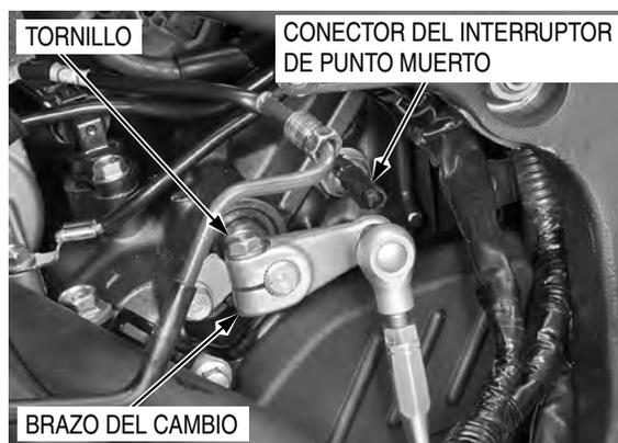
Desmonte los tornillos, las abrazaderas para cables, la tapa del piñón conductor y la placa de guía.
