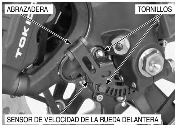
Desmonte el tornillo y la abrazadera de los cables.
