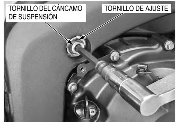
Sujete el tornillo de ajuste, para ello agarre el tornillo del cáncamo de suspensión y apriete la contratuerca al par especificado.
