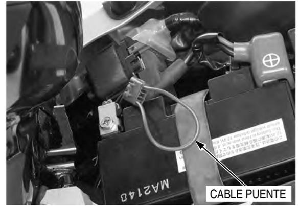
1. Gire la llave de contacto a la posición ON mientras presiona el pedal del freno trasero.
