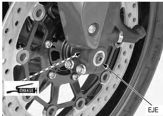
Sujete el eje y apriete su tornillo al par especificado.
