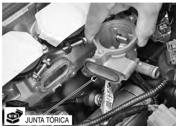
Monte el alojamiento del termostato en la culata y apriete firmemente los tornillos.
