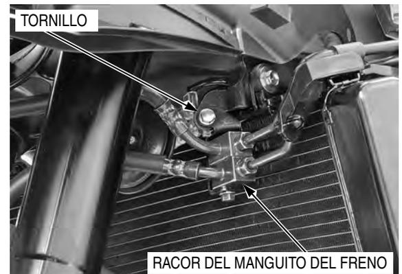
Desmonte el tornillo de fijación del radiador inferior y el casquillo.
