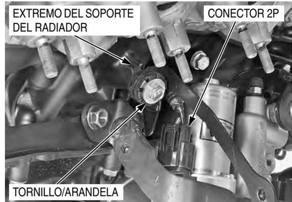
Instale los tornillos de fijación izquierdo y derecho del soporte de la unidad de alimentación delantera y las arandelas.
