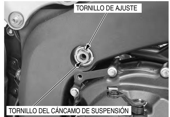
Desmonte la tuerca y la arandela del cáncamo de suspensión del motor inferior mientras sujeta el tornillo del mismo.
