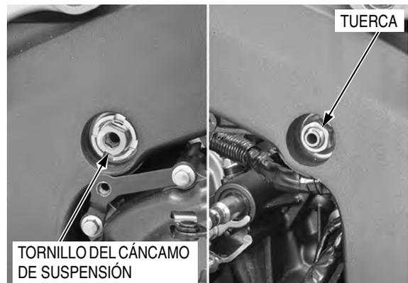
Afloje la contratuerca del cáncamo de suspensión del motor superior utilizando la herramienta especial.
