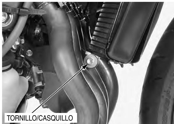
Desmonte el tornillo de fijación del radiador superior, la arandela y el soporte del racor del manguito del freno.
