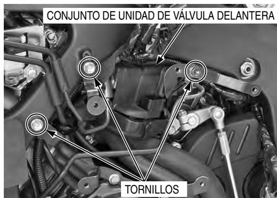
Retire las abrazaderas para cables del soporte de la unidad de la válvula delantera.
