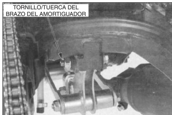
Quite la tuerca y el tornillo de montaje inferior del amortiguador.
