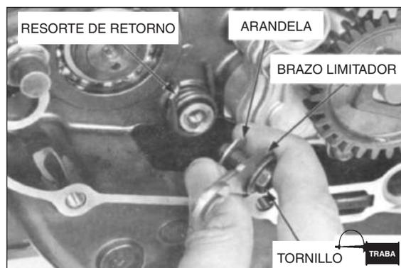
Aparte el brazo limitador utilizando un destornillador.
