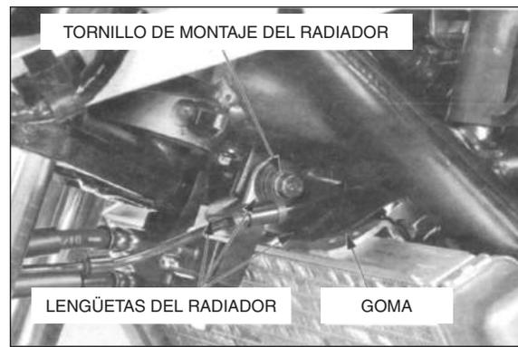
Suelte los anillos de goma inferiores del radiador desde los resaltes del chasis moviendo el radiador hacia la izquierda.
