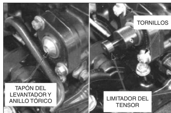
Instale una junta nueva en el levantador del tensor de la cadena de distribución e instáelos en el cilindro.
