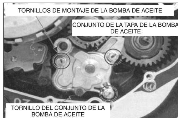
TORNILLOS DE MONTAJE DE LA BOMBA DE ACEITE
