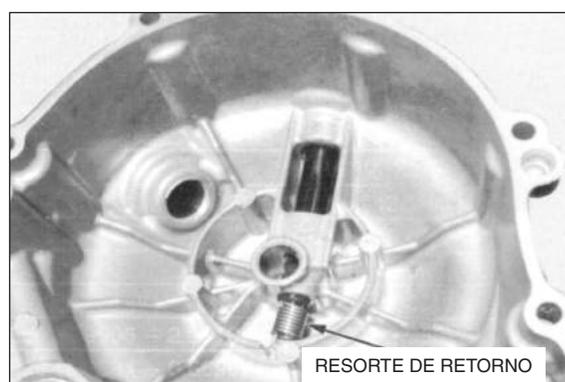
Quite el brazo de accionamiento del embrague desde la tapa derecha de la carcasa del motor.
