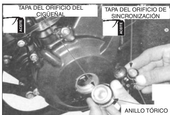
**ACEITE DEL MOTOR****INSPECCIÓN DEL NIVEL DEL ACEITE**
