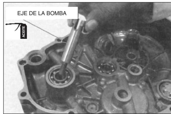
Instale la arandela plana y el impulsor en el eje de la bomba de agua.
