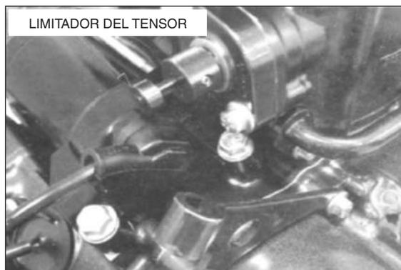
Aplique aceite para motor en el anillo tórico e instálelo en el levantador del tensor de la cadena de distribución.
