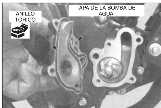
Instale y apriete los tornillos, el tornillo de drenaje y la arandela de sellado firmemente.
