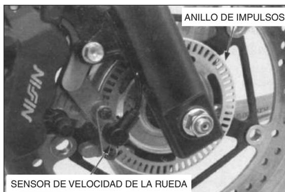
Cuando las ranuras de la superficie exterior del anillo de impulsos que gira junto con las ruedas delantera/trasera, pasa por el sensor de velocidad de la rueda, las señales de impulso se generan en el sensor. La unidad de mando del ABS del modulador del ABS detecta la velocidad de la rueda tan luego recibe las señales de impulso, porque la frecuencia de la señal aumenta proporcionalmente con la velocidad de la rueda.
