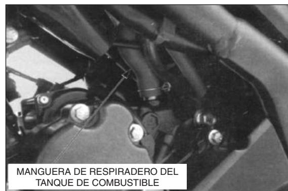
Afloje el tornillo de la abrazadera de la manguera de conexión.
