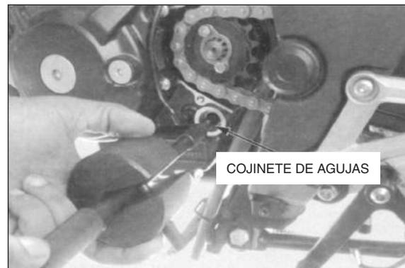
Instale un nuevo cojinete de agujas del eje del selector de marchas en la carcasa izquierda, con el lado marcado vuelto hacia arriba hasta que esté totalmente asentado, utilizando las herramientas especiales.
