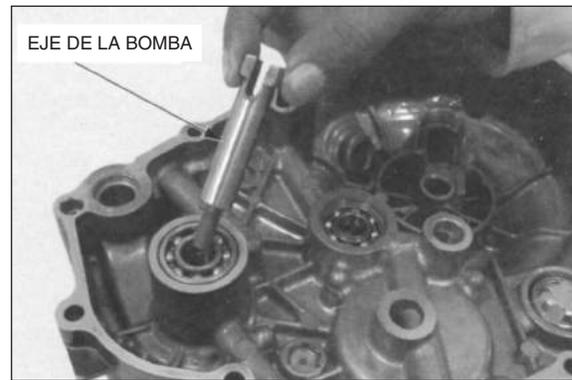
Verifique el eje de la bomba de agua con respecto a desgaste o a daño, sustitúyalo si fuera necesario.
