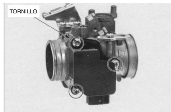
Instale el aislador del cuerpo del acelerador en el cuerpo del acelerador alineando la lengüeta del cuerpo del acelerador con la ranura del aislador del mismo.
