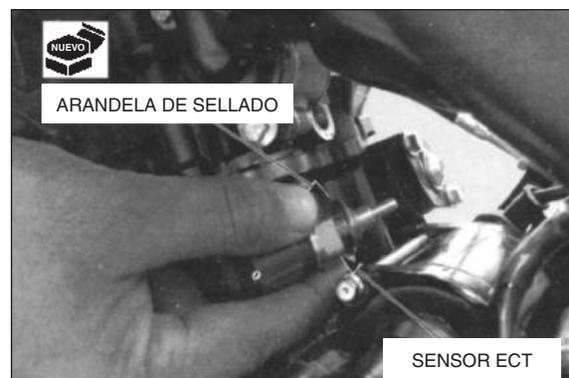
Enchufe el conector 3P del sensor ECT.
