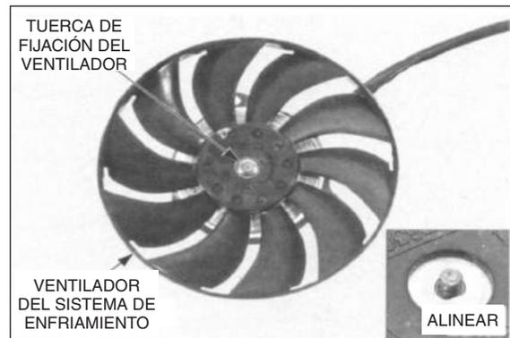
Instale el soporte del ventilador en el motor del ventilador.
