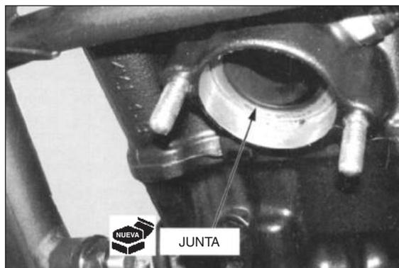
Instale el tubo de escape y las tuercas de la junta del tubo de escape.
