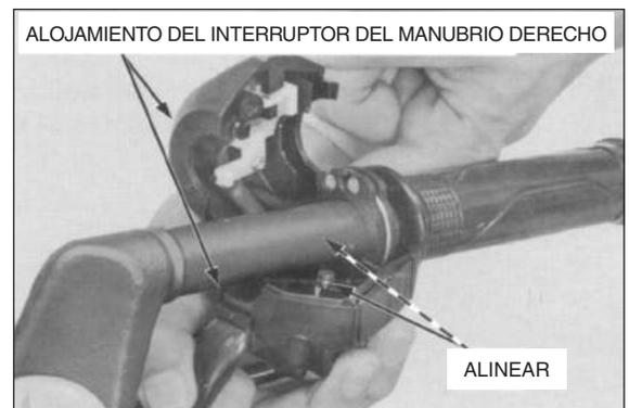
Instale los tornillos y apriete primero el tornillo delantero y enseguida el trasero al par de apriete especificado.
