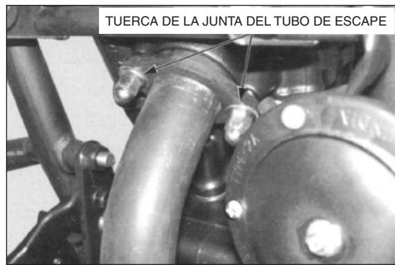
Quite la tuerca, el tornillo y la arandela de montaje del tubo de escape y el tubo de escape.
