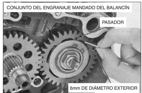
Inserte un fijador de engranajes entre el engranaje de mando del balancín y el conjunto del engranaje mandado del balancín.
