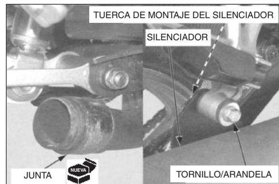
Apriete el tornillo de la abrazadera del silenciador al par de apriete especificado.
