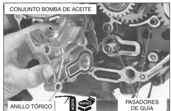
Instale y apriete firmemente los tornillos de montaje de la bomba de aceite.
