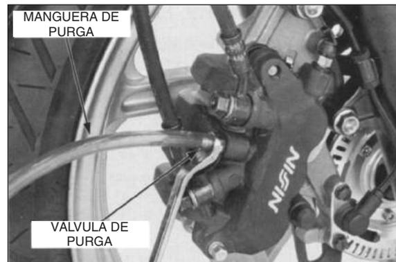
Conecte la manguera de purga a la válvula de purga del caliper del freno trasero.
