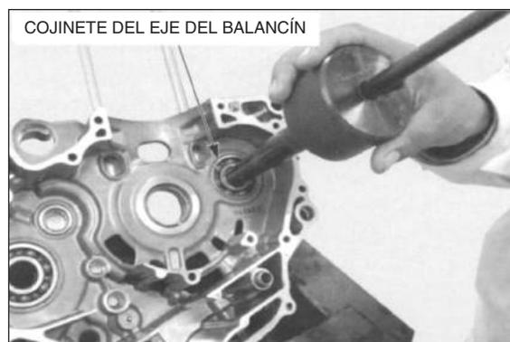
Instale cojinetes nuevos dentro de la carcasa izquierda hasta que estén totalmente asentados utilizando herramientas especiales.
