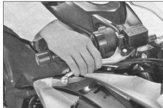
6. Suelte la palanca del freno apenas el indicador del ABS se apague.
