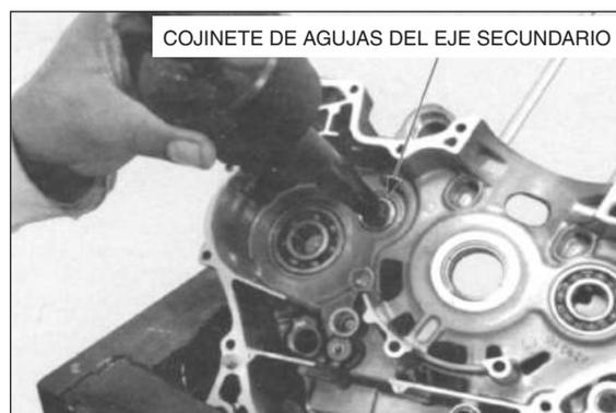
Quite el cojinete del eje del balancín utilizando las herramientas especiales.
