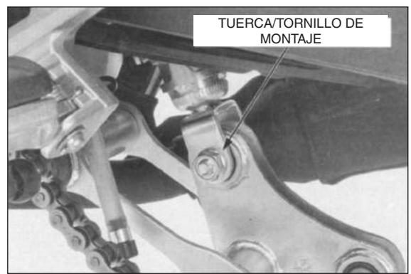
Instale la tuerca y el tornillo del brazo del amortiguador.
