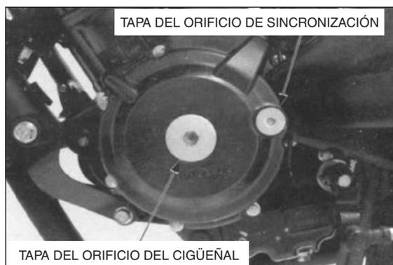
Gire el cigüeñal en sentido antihorario y alinee la marca "T" en el volante del motor con la marca de referencia en la tapa izquierda de la carcasa del motor.
