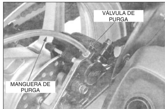
Después que no aparezcan más burbujas de aire en el fluido, repita el procedimiento de purga de aire aproximadamente dos o tres veces en cada válvula de purga.
