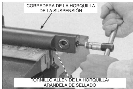
Mediante movimientos sucesivos rápidos, tire del tubo de la horquilla de la suspensión hacia fuera de la corredera de la horquilla.
