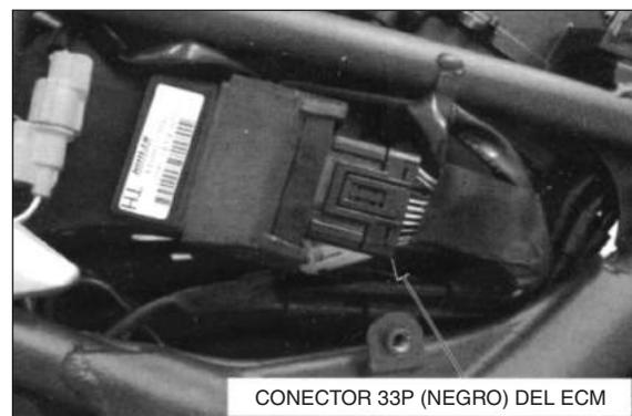
Verifique si hay continuidad entre el conector 33P (Negro) del cableado lateral y el tierra.
