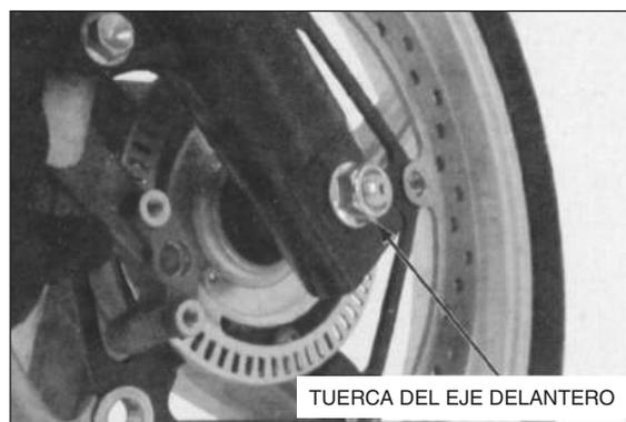
Afloje el tornillo de fijación del eje delantero.
