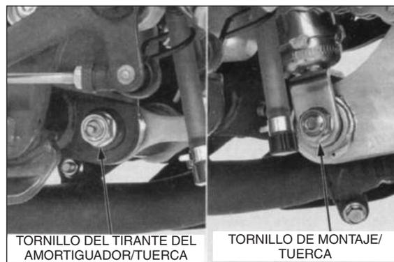
Quite la tuerca superior de montaje del amortiguador y el amortiguador.
