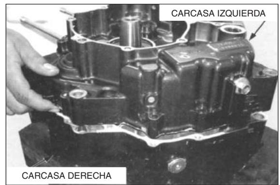
Instale los tornillos de la carcasa derecha.
