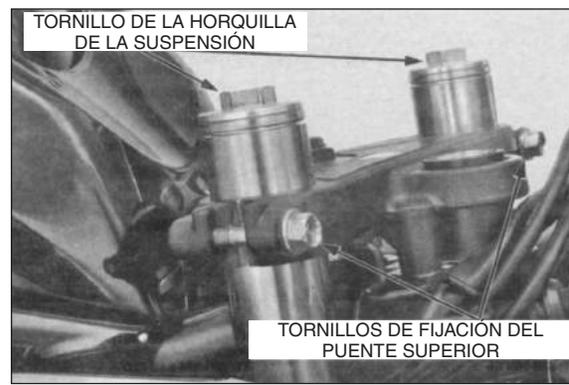
Sujete la horquilla de la suspensión y afloje los tornillos de fijación del puente inferior, baje la horquilla y enseguida quítela.
