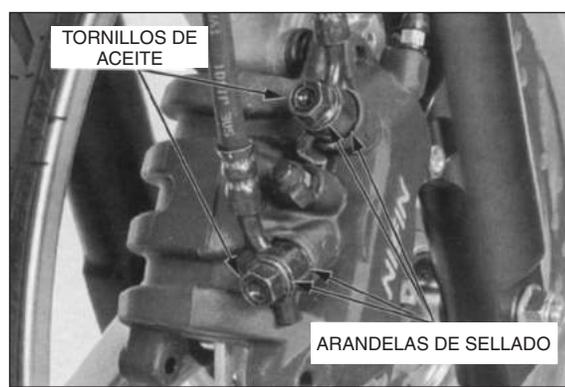
Quite los tornillos de montaje del caliper del freno y el caliper del freno/conjunto del soporte.
