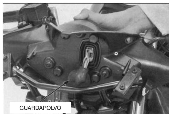
Conecte el probador de pico de tensión o el adaptador de pico de tensión en el terminal del conector 20P del tablero de instrumentos en el lado del cableado.
