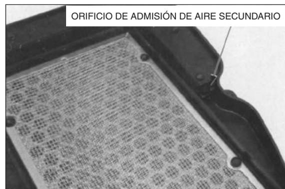
Haga funcionar el motor y abra levemente el acelerador para asegurarse de que el aire está siendo succionado a través de la manguera de suministro de aire. Si el aire no está entrando, verifique si las mangueras de suministro de aire y la válvula solenoide de control PAIR no están obstruidas.
