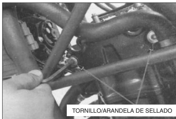
Quite el eje del balancín utilizando un tornillo de 6 mm mientras sujeta el balancín.
