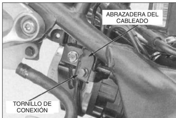
Quite los tornillos de montaje del modulador del ABS y el modulador del ABS.
