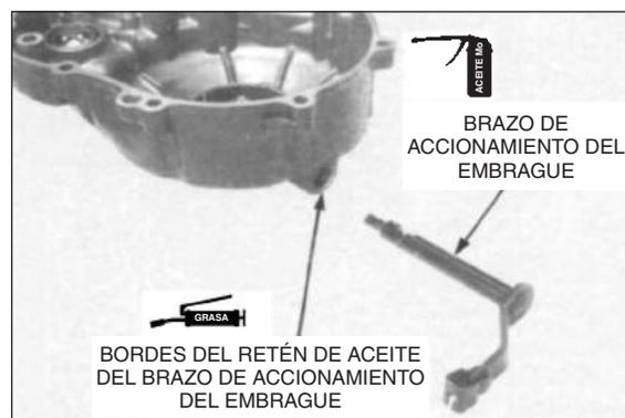
Instale el resorte de retorno en la tapa derecha de la carcasa del motor alineando el lado más corto del resorte con el orificio del brazo de accionamiento del embrague y el lado más largo con la ranura de la tapa derecha de la carcasa del motor.
