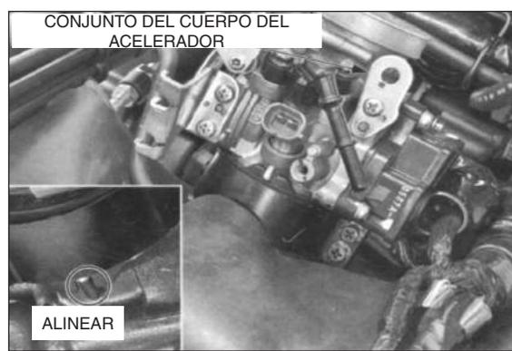
Apriete los tornillos de la abrazadera del aislador al par de apriete especificado.
