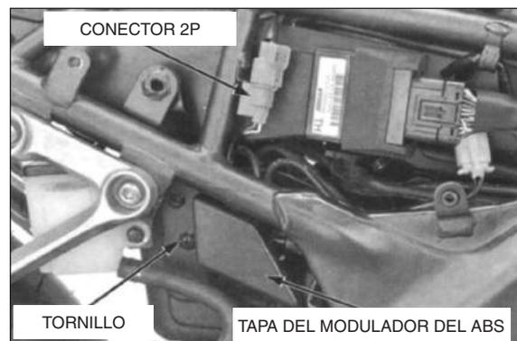
Suelte el cableado del sensor desde la abrazadera del mismo.
