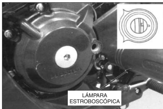
Aplique aceite para motor en un anillo tórico nuevo e instálolo en la tapa del orificio de sincronización.
