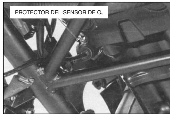
Enchufe el conector 1P del sensor de O<sub>2</sub>.
