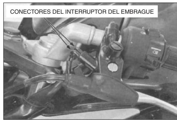
Quite los tornillos, el fijador y el soporte de la palanca del embrague.
