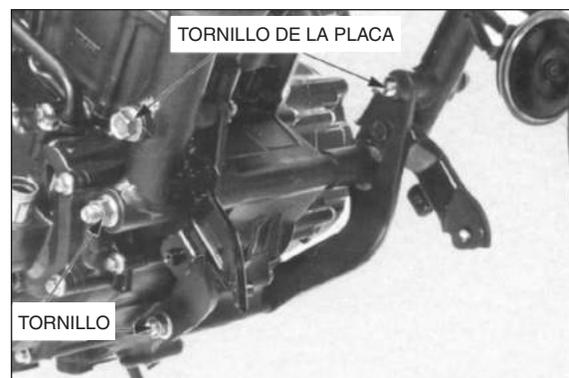
Apriete las tuercas de montaje superiores traseras del motor al par de apriete especificado.
