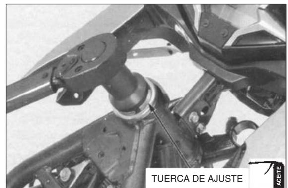
Instale una arandela de traba nueva alineando sus lengüetas dobladas cortas con las ranuras en la tuerca de ajuste de la columna de dirección.
