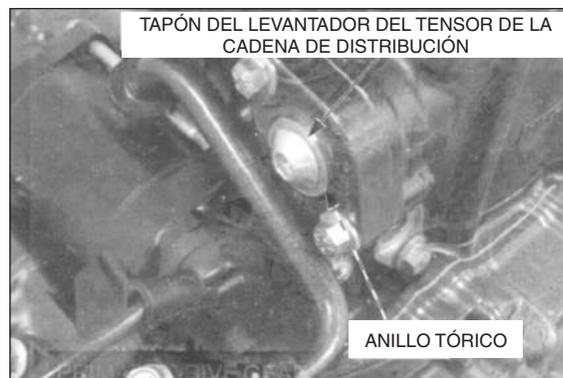
Gire totalmente el eje del levantador del tensor de la cadena de distribución (en sentido horario) y sujételo utilizando un limitador del tensor para evitar daños en la cadena de distribución.
