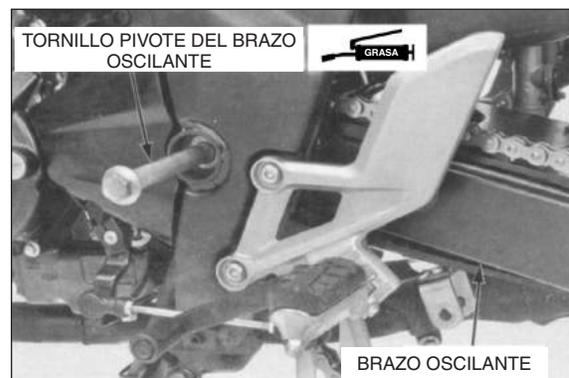
Instale la tuerca del pivote del brazo oscilante y apriétela levemente.
