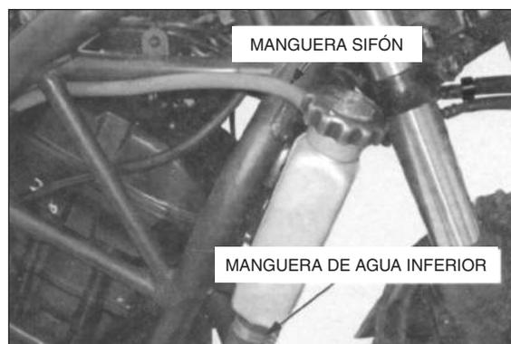
Afloje el tornillo de la abrazadera de la manguera de agua y desconecte la manguera de agua superior.
