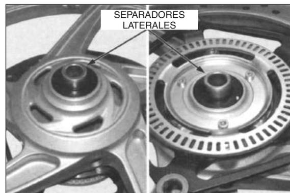
Instale la rueda delantera entre las horquillas de manera que el disco de freno se posicione entre las pastillas.
