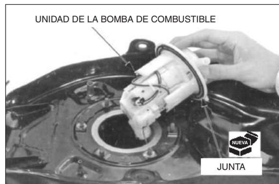
Instale la placa de asentamiento de la bomba de combustible en la unidad de la bomba de combustible alineando las ranuras de la placa de asentamiento y de las lengüetas de la unidad de la bomba de combustible.
