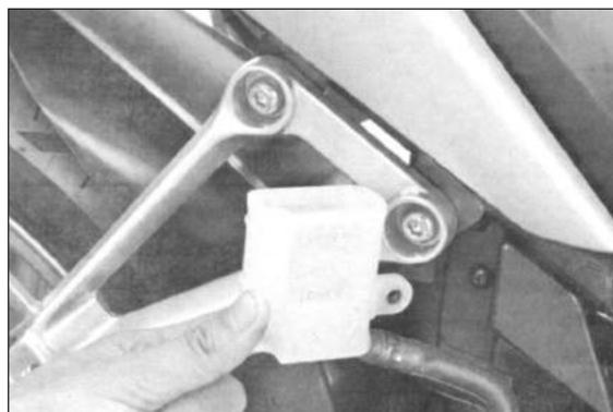
Instale el diafragma, la placa del diafragma, la tapa del depósito y los tornillos de la tapa del depósito, enseguida apriete los tornillos al par de apriete especificado.
