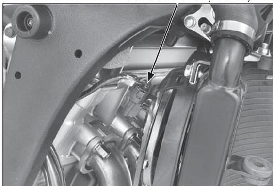
Instale e aperte o parafuso de montagem inferior do radiador.
