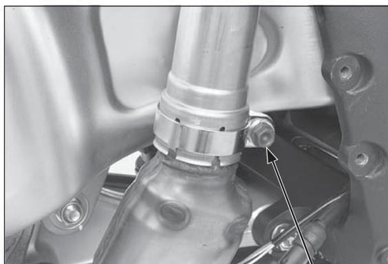
PARAFUSO DA BRAÇADEIRA INFERIOR DO TUBO DE UNIÃO DO ESCAPAMENTO
