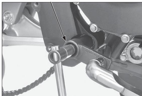
Aperte o parafuso de ajuste do suporte traseiro superior do motor no torque especificado, girando o parafuso de suporte.
