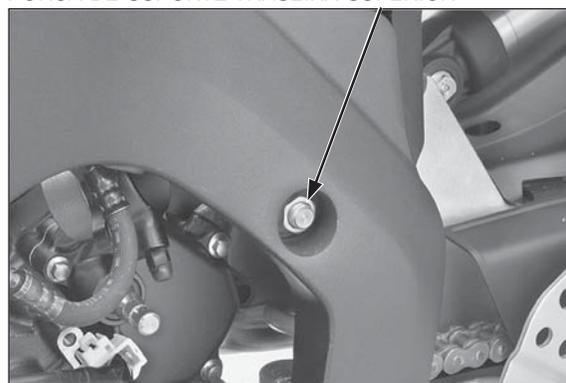
Instale e aperte o parafuso de suporte dianteiro do lado esquerdo do motor no torque especificado.
