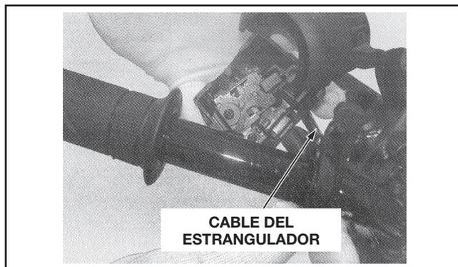
Remueva la empuñadura del manillar y la palanca del estrangulador.
