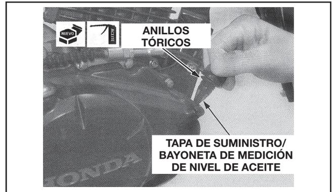
*Cambie el aceite, con el motor calentado y con la motocicleta colocada en su caballete central para asegurarse de que el drenaje sea completo y rápido.*
