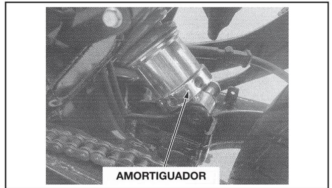
Instale el tornillo de montaje superior y la tuerca.
