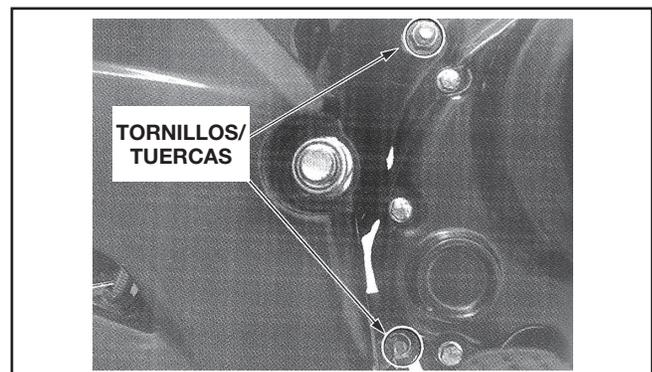
Instale la placa, tornillos y tuercas de la placa.
