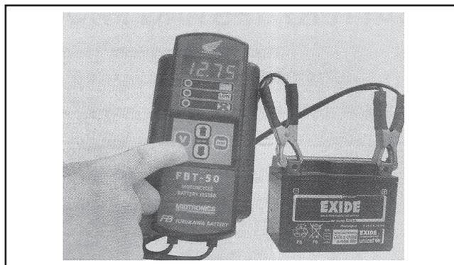
Para probar la carga de la batería, presione el botón "TEST".
