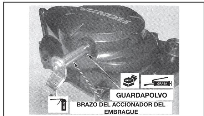
Instale el resorte de retorno en el extremo del brazo del accionador.
