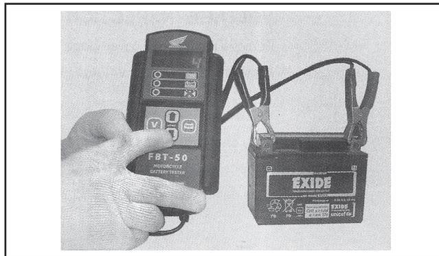
Al inspeccionar la tensión, presione el botón "V".
