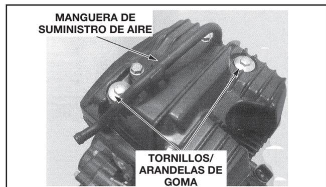
Remueva la tapa de la culata del motor y la empaquetadura de la tapa.
