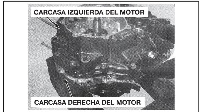
Instale los tornillos de la carcasa del motor y los apriete en secuencia cruzada en 2-3 etapas.
