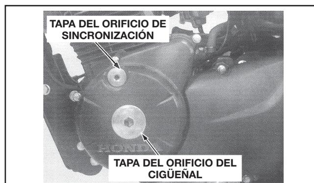
Gire el cigüeñal en el sentido contra horario y alinee la marca "T" en el volante del motor con el entalle de referencia en la tapa de la carcasa izquierda del motor.
