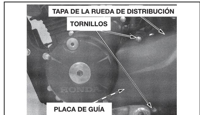
Inspeccione los dientes de la rueda movida y de distribución en cuanto a daños; las sustituya, si fuese necesario.
