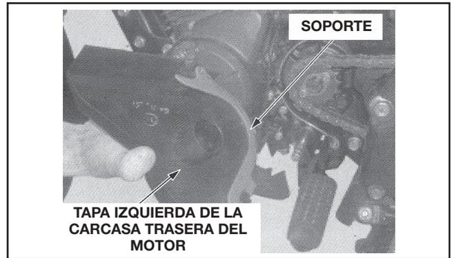
Quite los tornillos de la placa de fijación, placa de fijación y la rueda de distribución, con la cadena.
