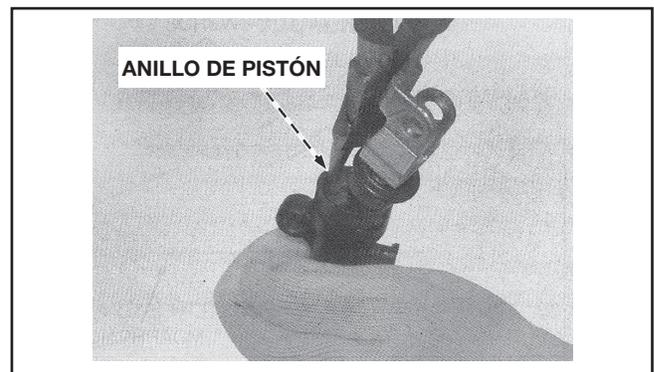
Después de instalar el anillo de presión, siempre lo gire en la respectiva ranura para asegurarse de que está completamente asentado.
