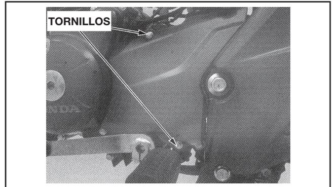
Remueva la tapa izquierda de la carcasa trasera del motor y el soporte.
