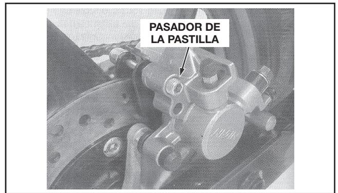
Accione el pedal de freno para asentar los pistones de la pinza contra las pastillas.
