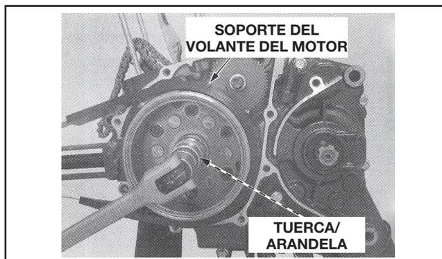
Remueva el volante del motor, utilizando un extractor del volante.
