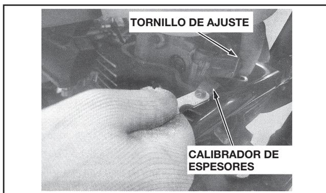
Ajuste, aflojando la contratuerca del ajustador de válvula y girando el tornillo de ajuste hasta que suceda un ligero arrastre en el calibrador de espesores.
