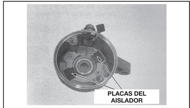
Instale el portaescobillas, arandela y apriete los tornillos con la escobilla de alambre.
