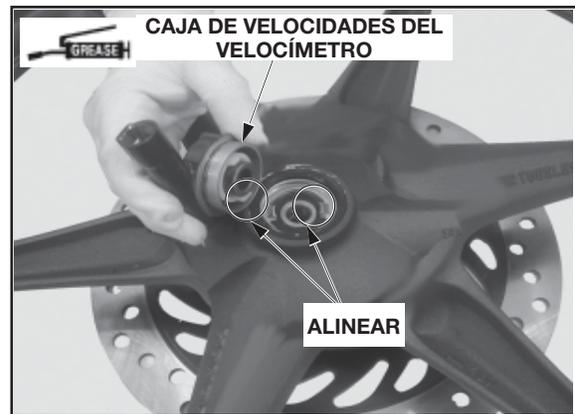
Instale el buje lateral en el cubo de la rueda derecha.
