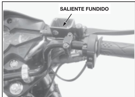
Instale el diafragma, placa del diafragma y tapa del depósito; apriete los tornillos, según el par de apriete especificado.
