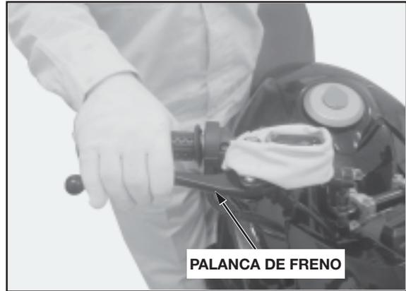
*No suelte la palanca de freno hasta que la válvula de sangría haya sido cerrada.* Conecte una manguera de sangría en la válvula de sangría y sangre el sistema como sigue:
