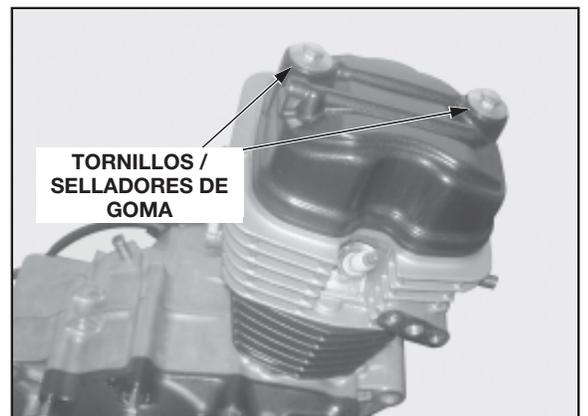
Remueva la empaquetadura de la tapa, de la tapa de la culata del motor.
