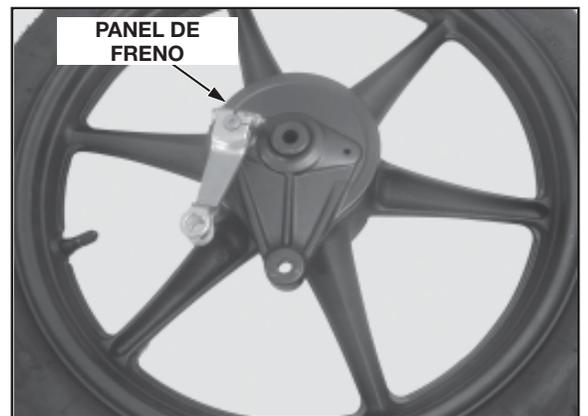
Coloque la rueda trasera en la horquilla trasera, alineando las ranuras de los amortiguadores de goma con los resaltes de la brida mandada.
