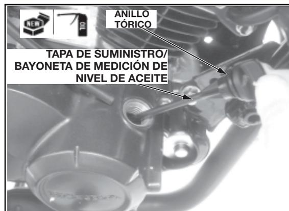
*Cambie el aceite, con el motor calentado y con la motocicleta colocada en su caballete central para asegurarse que el drenaje sea completo y rápido.*
