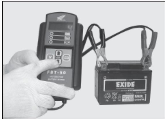
Para inspeccionar la tensión, presión el botón "V".
