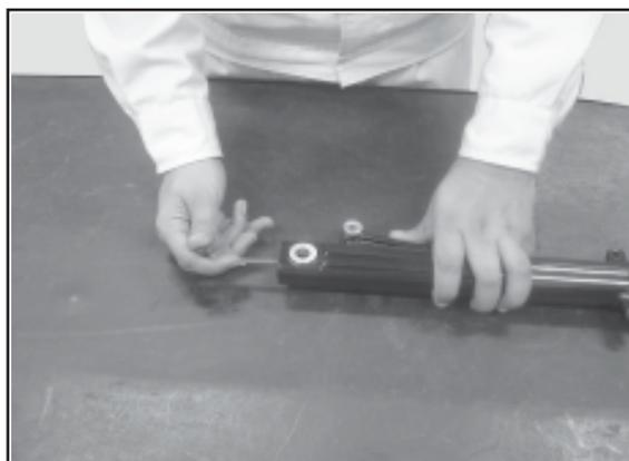
Sujete la corredera de la horquilla en un tornillo de banco con trozos de madera o un trapo.
