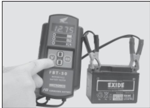
Para probar la carga de la batería, presione el botón "TEST".
