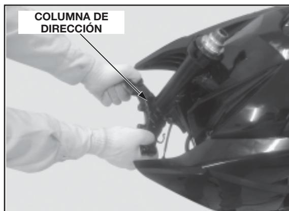
Afloje completamente la tuerca de ajuste del cojinete de la dirección; enseguida, la vuelva a apretar de acuerdo con el par de apriete especificado.
