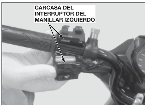
Instale y apriete primeramente el tornillo delantero; enseguida, apriete el tornillo trasero.
