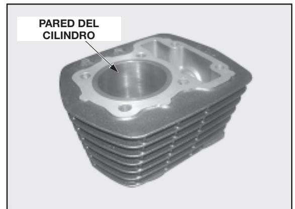
Mida y anote el diámetro interno del cilindro en tres puntos en ambos ejes (X y Y).
