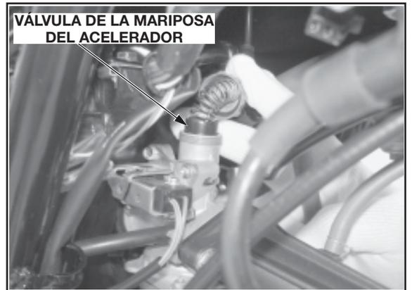
Instale y apriete la parte superior del carburador.
