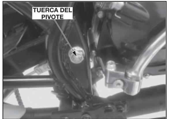
*Tenga cuidado para no dañar el resorte del interruptor de la luz de freno trasera.* Remueva el tornillo del pivote de la horquilla trasera y la horquilla trasera.
