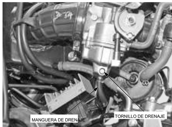
*Después de la instalación gire la válvula de combustible a posición ON y asegúrese de que estos no son combustibles fugas.*
