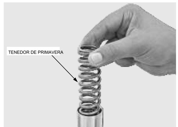
Drenar el líquido tenedor mediante el bombeo de la tubería tenedor varias veces en una bandeja limpia.
