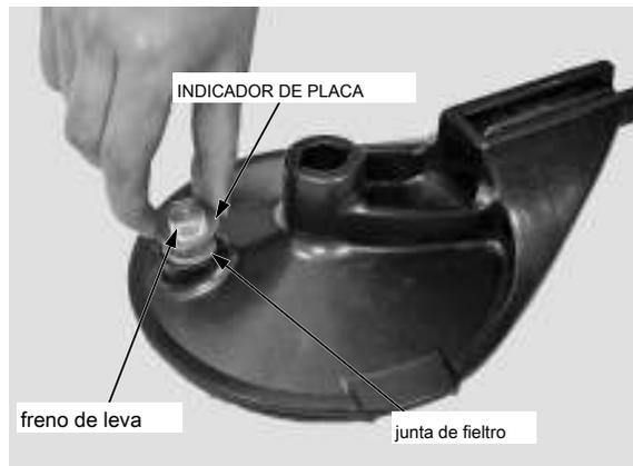
Aplique grasa a la superficie de deslizamiento de leva del freno.
