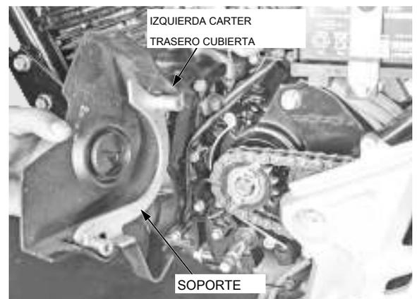
Retirar los pernos de la placa de fijación (2 nos.). La placa y la unidad de fijación la rueda dentada con la cadena.
