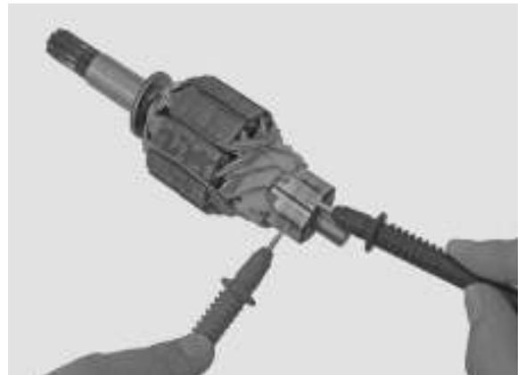
Compruebe la continuidad entre cada barra del conmutador y el eje del inducido. No debe haber continuidad.
