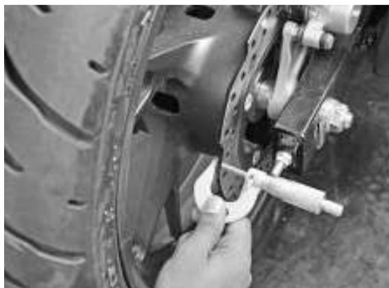
Comprobar los cojinetes de las ruedas de un juego excesivo, si la deformación excede el límite de servicio.
