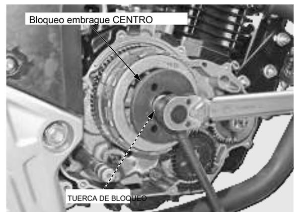
Instalar los muelles del embrague, placa de levantador de embrague y pernos de la placa de accionamiento del embrague.
