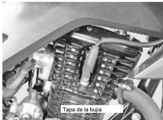
Retire la bujía con una llave de bujía equipado o un equivalente.
