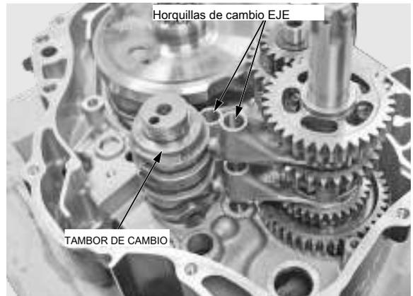
Retire el eje principal y eje secundario juntos.
