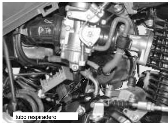
Alojar la abrazadera de la manguera de drenaje y retirar la manguera de drenaje de la carcasa del filtro de aire y drenar los depósitos en una recipiente adecuado.
