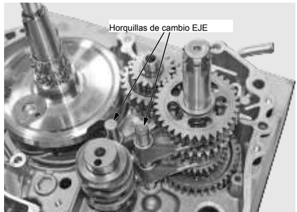
Aplicar aceite de motor limpio a los ejes de horquilla de cambio, e insertarlas a través de las horquillas de cambio en el cárter derecho.
