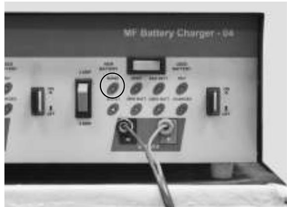
LED principal será seguido por LED amarillo (Para Nueva batería) o LED azul (Para batería utilizada) indica que la batería se está cargando correctamente.
