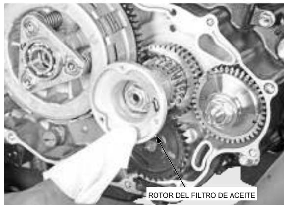
Retire la junta de la tapa del rotor aceite. Mientras presiona el aceite a través de la cara posterior, a continuación, quitar el clip.
