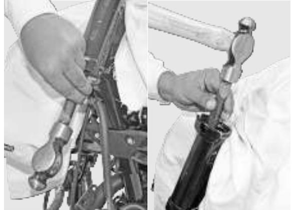
Instalar una nueva pista de bolas superior e inferior nueva pista de bolas con la herramienta especial.
