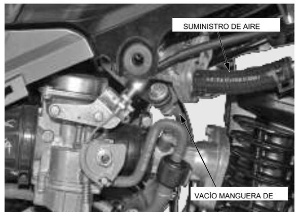
Compruebe la manguera de aspiración de aire entre la carcasa de válvula de control PAIR y filtro de aire para deterioro, daño o suelto conexiones.
