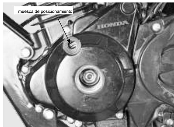
Escudo una nueva junta tórica con aceite de motor e instalarlo en la tapa de orificio de distribución.
