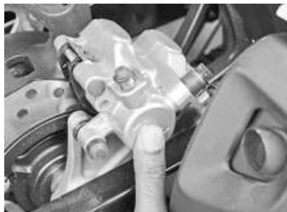
*Siempre vuelva a colocar las pastillas de freno en pares para asegurar una presión uniforme disco.*
