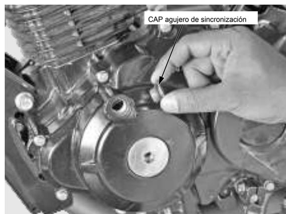
Lea las instrucciones para temporización de operación de la luz. Conectar una luz de regulación para el cable de bujía. Arranque el motor y déjelo al ralentí. **VELOCIDAD IDLE: 1,400 ± 100 min<sup>-1</sup> (rpm)**
