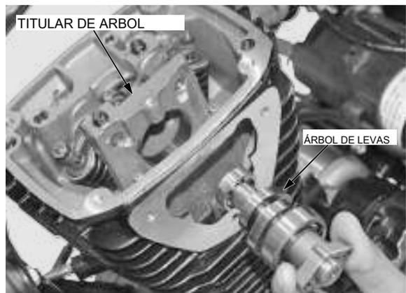
Coloque el perno de retención del árbol de levas y apretar de forma segura.
