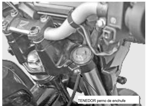
Mantenga las barras de la horquilla y aflojar los pernos de apriete puente inferior y bajar las barras de la horquilla, y luego retirarla.
