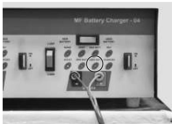
El LED verde indica, la batería está completamente cargada. Una vez más comprobar la tensión de la batería (página 15-4).
