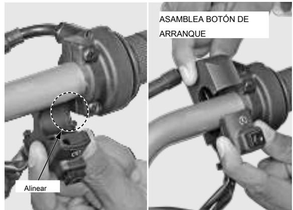
Instalar y apretar los tornillos de la caja del interruptor de arranque.
