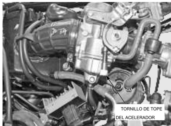
9. Girar el tornillo piloto y ajustar la concentración de CO. medición de
