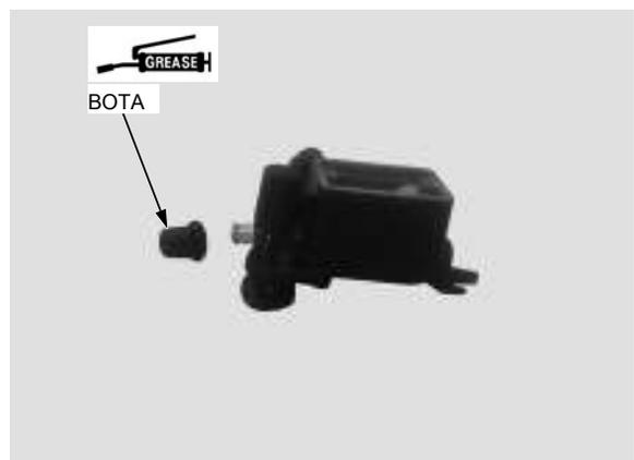
Instalar el interruptor de luz de freno al cilindro maestro alineando el jefe interruptor de luz de freno con el agujero de cilindro maestro.
