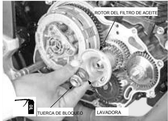
Instalar el soporte de transmisión entre la unidad principal y conducido engranajes como se muestra, y apretar el filtro de aceite de nuez de bloqueo del rotor con el par especificado utilizando las herramientas especiales.
