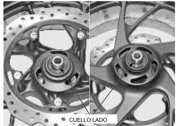
*Tenga cuidado de no dañar la almohadillas.* Instalar la rueda delantera entre las patas de la horquilla de modo que el disco de freno se coloca entre las almohadillas.
