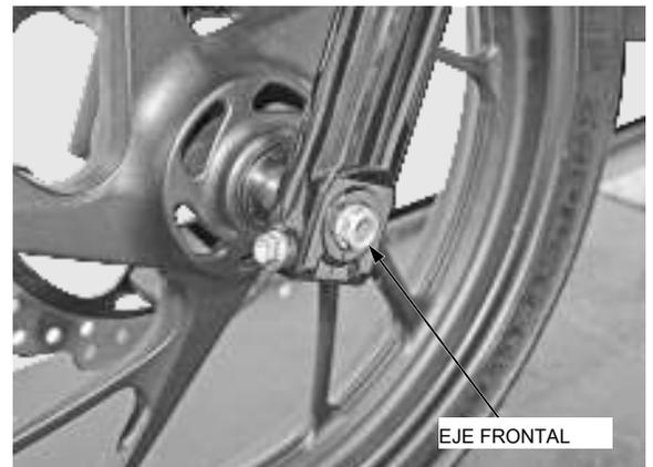
Instalar y apretar la tuerca del eje con el par especificado.
