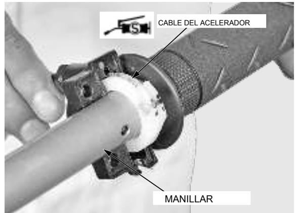
Instalar la caja del interruptor derecho del manillar, mientras que la adaptación de su clavija de posición con el orificio en el manillar.
