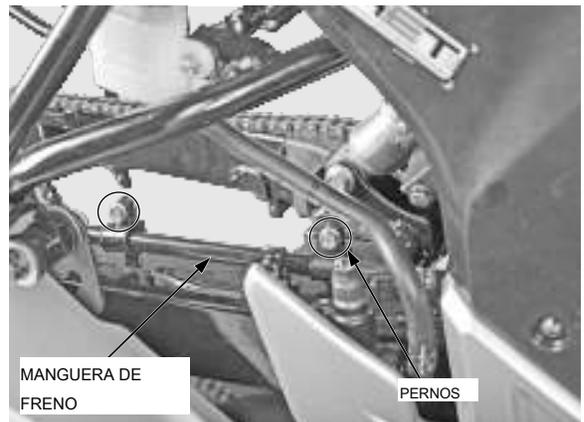
Instalar el caso superior e inferior cadena de transmisión y apretar los tornillos (4 nos.).
