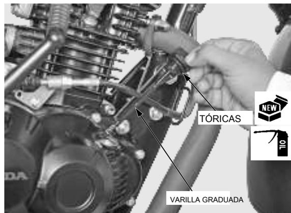
*Cambiar el aceite con el motor caliente y el motociclista colocado en su centro de soporte para asegurar la completa y vaciado rápido.*
