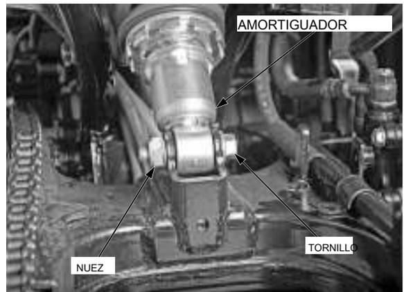
Retire el amortiguador tuerca de montaje superior, perno y amortiguador.
