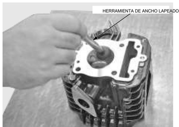
Retire la válvula e inspeccionar la anchura de cada asiento de válvula.
