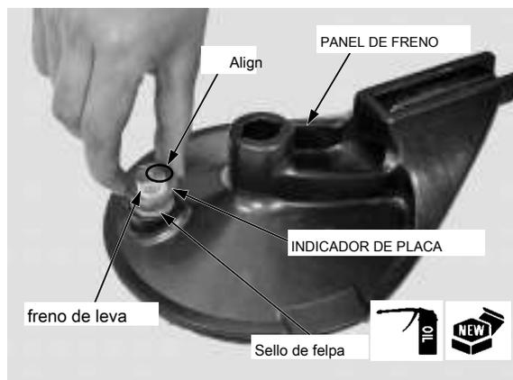
Instalar el brazo de freno mediante la alineación de las marcas de referencia del brazo del freno y el freno de leva.
