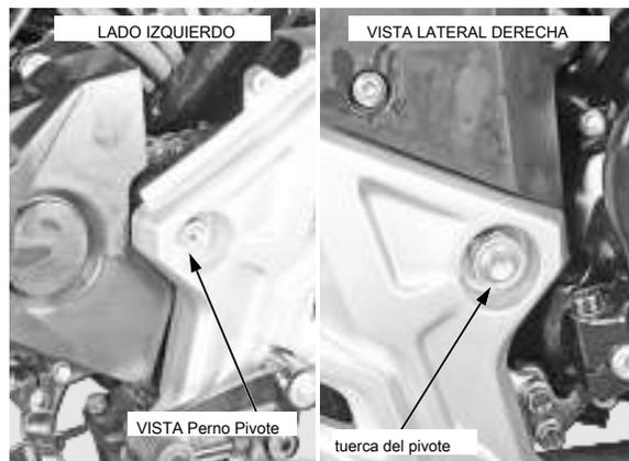
Montar el amortiguador tornillo de fijación inferior y la tuerca.
