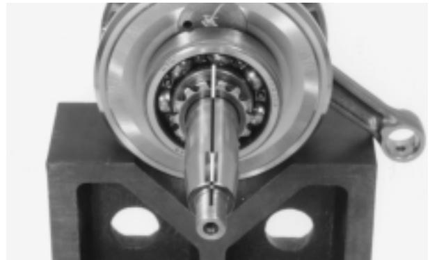
Coloque el cigüeñal en dos bloques V y medir la deformación en los puntos indicados mediante un indicador de cuadrante.
