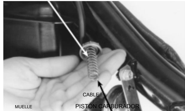
Insertar el terminal de cable del acelerador a través de la tapa del carburador comprimiendo el resorte.
