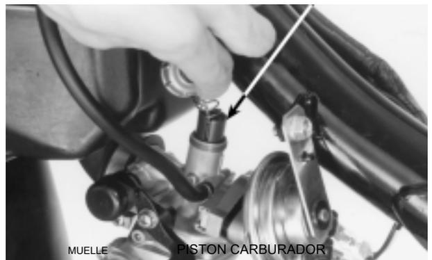
Retire el extremo del cable del acelerador ranura del pistón, comprimiendo el muelle.
