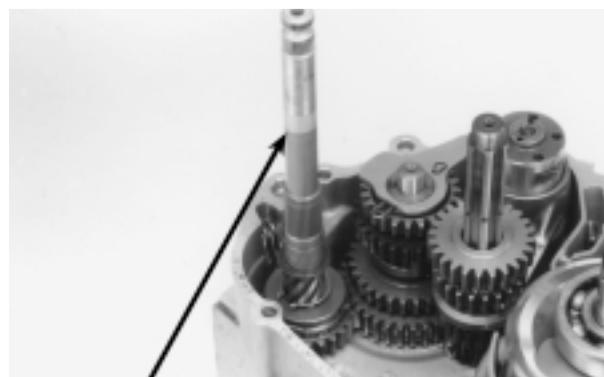
EJE DE ARRANQUE      MUELLE TRINQUETE      CARRACA ARRANQUE
