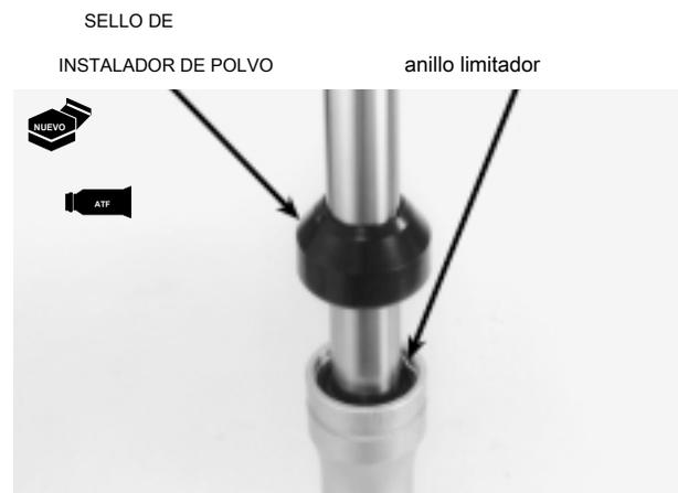
Coloque ATF líquido en el buffer en la cantidad especificada.
