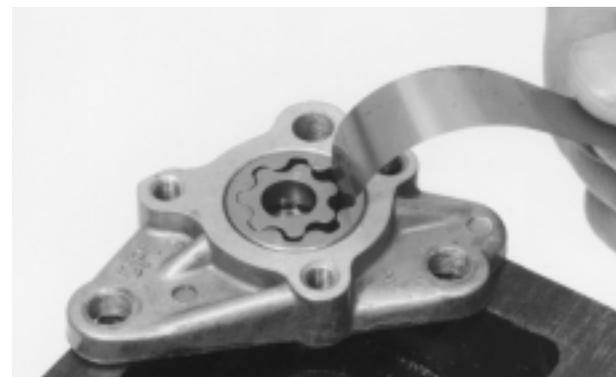
Medir la holgura entre el rotor exterior y la carcasa de la bomba de aceite.
