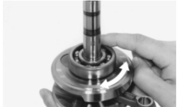
Compruebe la distribución de engranajes para el desgaste o daño.
