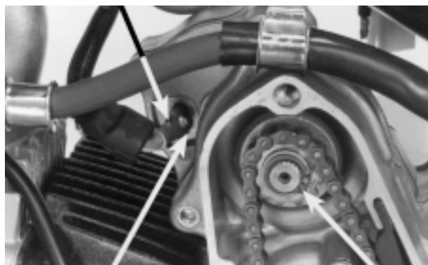
MOTOR DE ARRANQUE TERMINAL anillo elástico
