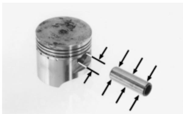
Medir el diámetro del pasador de pistón en la carcasa del cigüeñal.
