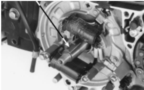
Limpiar el interior del rotor e instalarlo mediante la alineación de la ranura con la llave del cigüeñal.
