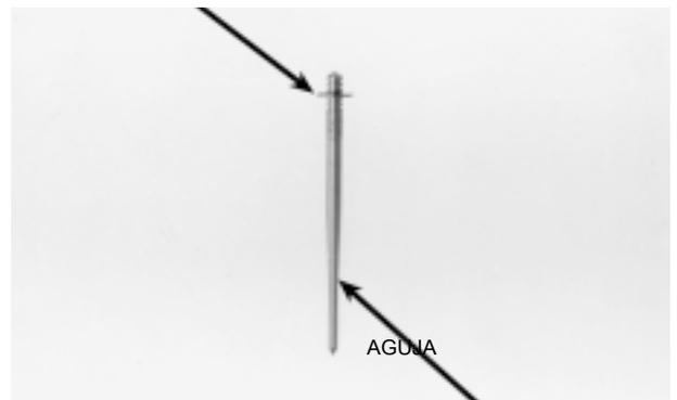
Instalar la válvula de aguja en el pistón del carburador de fijación con el clip.
