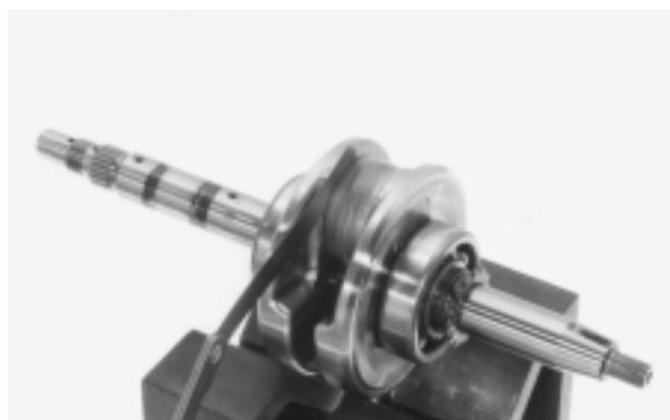
Medir la holgura radial en el regazo de la biela simétricamente en dos lugares utilizando un indicador de cuadrante.
