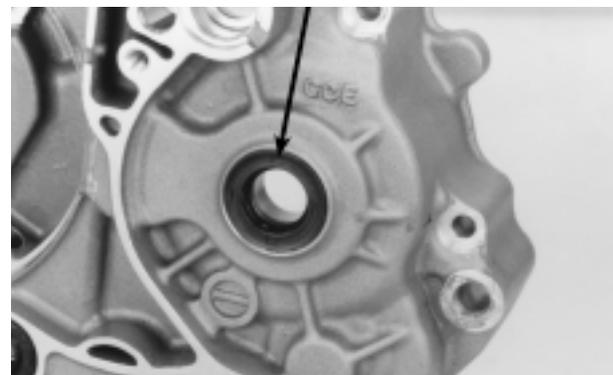
Retire el rodamiento de la caja de la derecha del árbol primario. Retire el alojamiento del cojinete del
