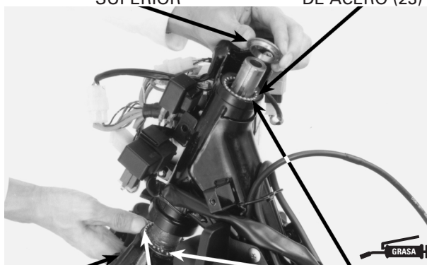
COLUMNA DE DIRECCIÓN ESFERAS DE ACERO (29) TUERCA DE AJUSTE
