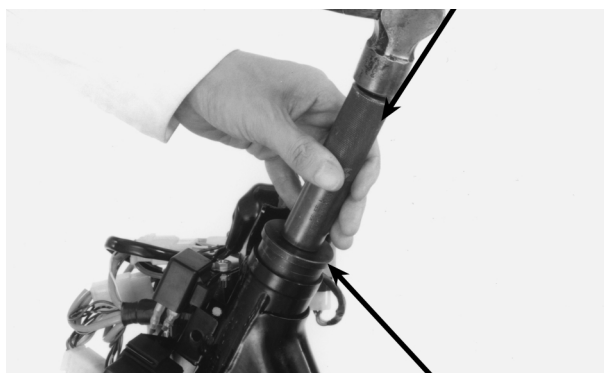
INSTALADOR CUBETA DE ESFERAS SUPERIOR ESFERAS DE ACERO (23)
