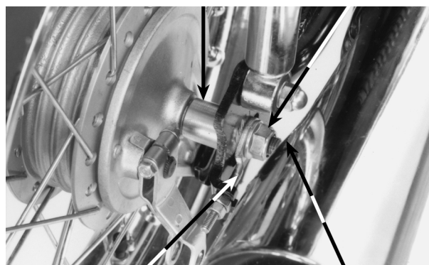
AJUSTADOR TUERCA PASADOR DE UNIÓN MUELLE EJE PASADOR HENDIDO
