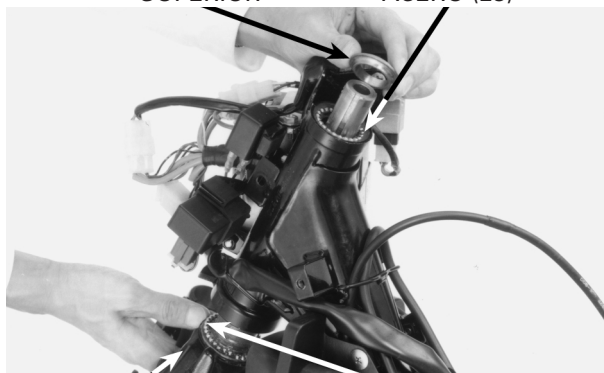
COLUMNA DE DIRECCIÓN ESFERAS DE ACERO (29) CUBETA CÓNICA
