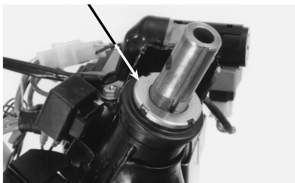
COLUMNA DE DIRECCIÓN ESFERAS DE ACERO (29) TUERCA DE AJUSTE
