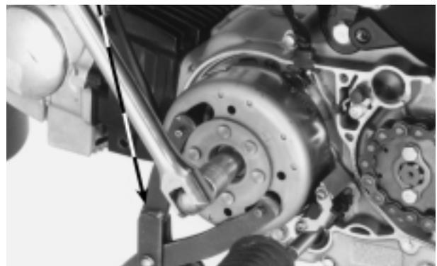
Retirar el rotor utilizando la herramienta especial.
