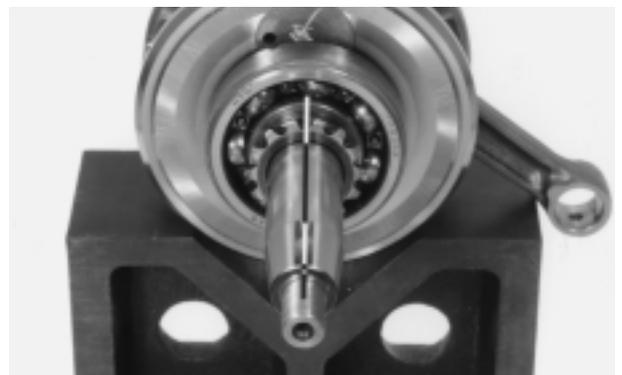
Colocar el árbol de manivela sobre dos bloques en V y medir el alabeo en los puntos indicados, usando un comparador a dial.
