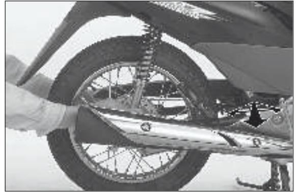
Compruebe los rodamientos de las ruedas manteniendo fija la rueda e intentando moverla lateralmente.
