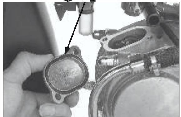
Aplice aceite para motor en los nuevos anillos tóricos e instálelos en la tapa del orificio del cigüeñal y en la tapa de inspección del punto de encendido.
