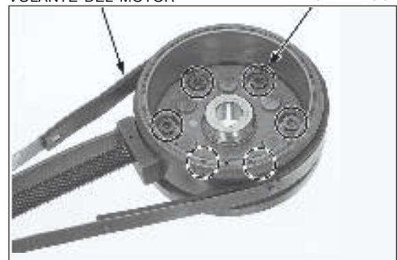
Quite el conjunto del embrague del arranque y su placa del volante del motor.
