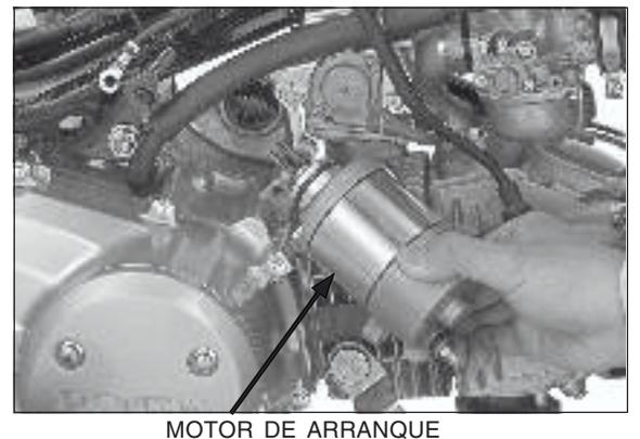
Instale los tornillos de montaje del motor de arranque junto con el cable-tierra y apriete los tornillos firmemente.
