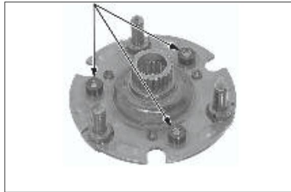
Lubrique los resaltes de la placa de accionamiento con aceite para motor.
