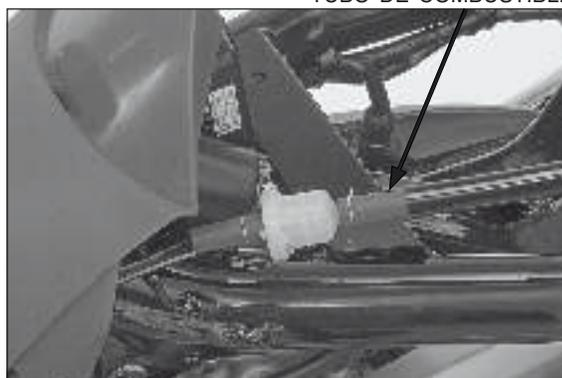
Quite los tornillos de montaje y el tanque de combustible.
