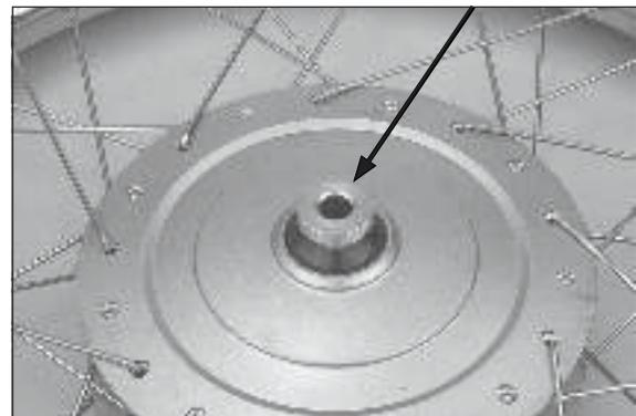
Instale la rueda delantera entre las piernas de la horquilla, alineando la ranura del panel del freno con el resalte en la pierna izquierda de la horquilla.
