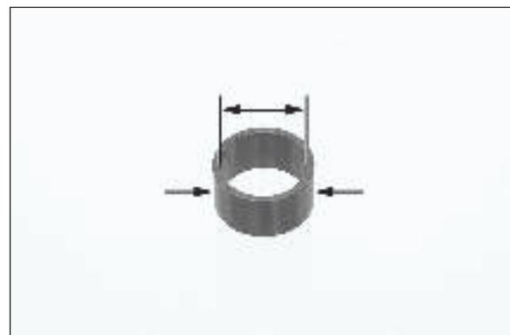
Mida los diámetros externos del eje primario en el engranaje M3, y del eje secundario en el engranaje C1.
