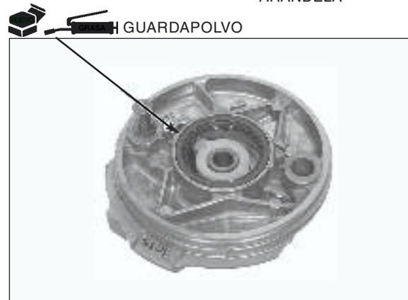
Aplique grasa a las superficies deslizantes de la leva del freno y del pasador de anclaje del panel del freno.
