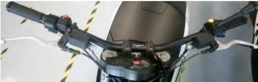
Imagen de las manetas de freno delanteros (izquierda) y traseros (derecha de la imagen) montados en el manillar.
