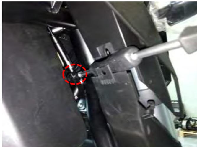
**Vista 11.** Detalle del desmontaje de la rosca del amortiguador del cofre.
