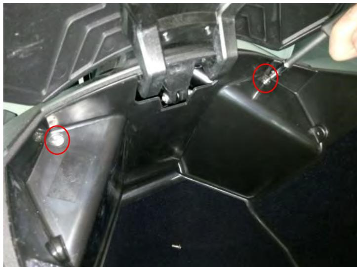
**Vista 2.** Tornillos interiores: 2 en la parte superior delantera, 2 más en la trasera.
