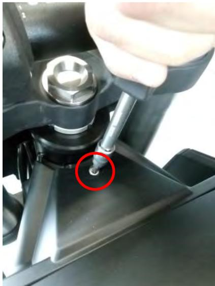
**Vista 3.** Tornillo superior en la parte frontal del cofre cerca de la dirección. Al aflojarlo el cofre subirá ligeramente por acción del amortiguador.
