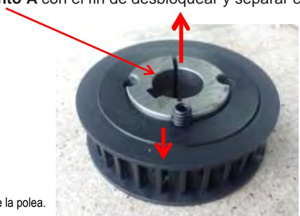
Vista 11. Desmontaje del taper de la polea.
