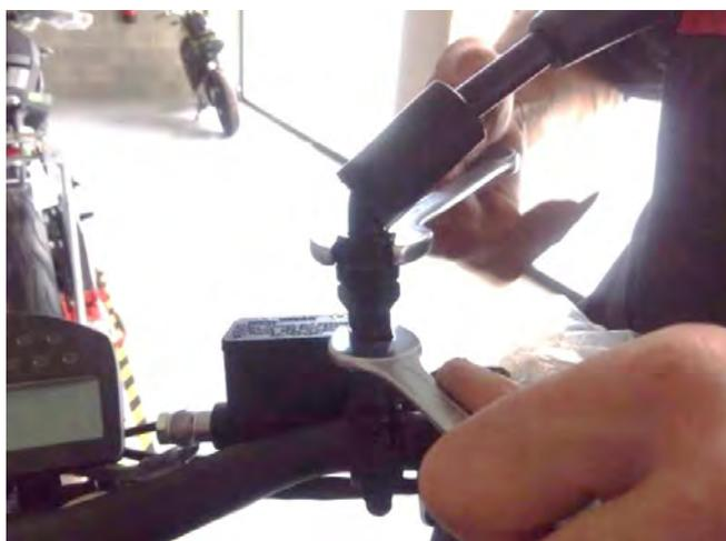
**Paso 6.** Se continúa sujetando el adaptador y se aprieta la segunda rosca superior. Si éste se encuentra fijo y la posición del retrovisor no es buena se deberá desenroscar respecto el segundo adaptador y tras reposicionar, apretar (siempre sujetando el adaptador de la base).
