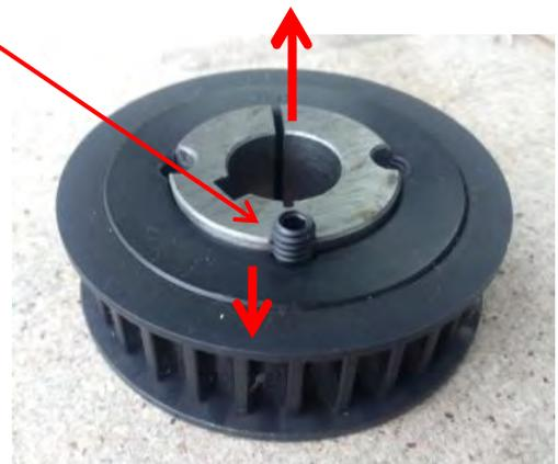
Vista 11. Desmontaje del taper de la polea.
