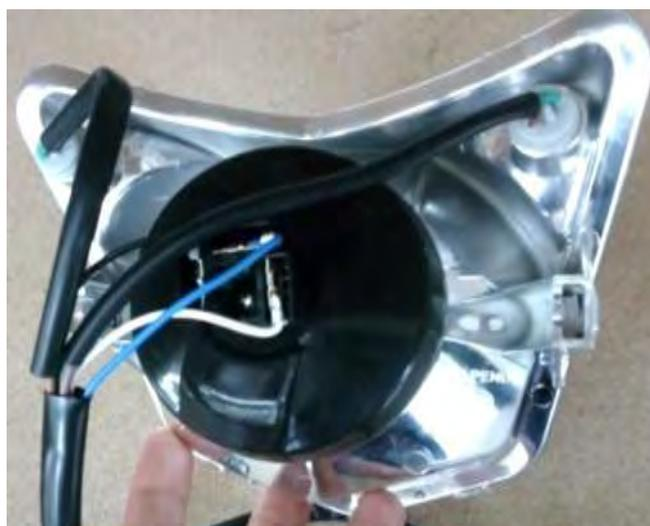
Imágenes 1: Parte posterior del faro frontal y detalle del conector desconectado .
