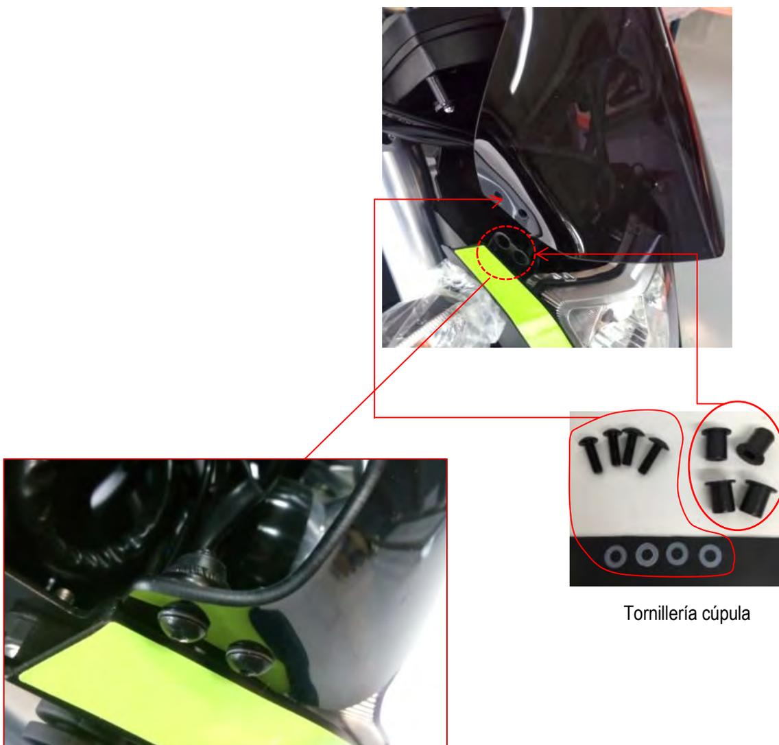
Vista 6. Detalle lateral derecho cúpula montada.
