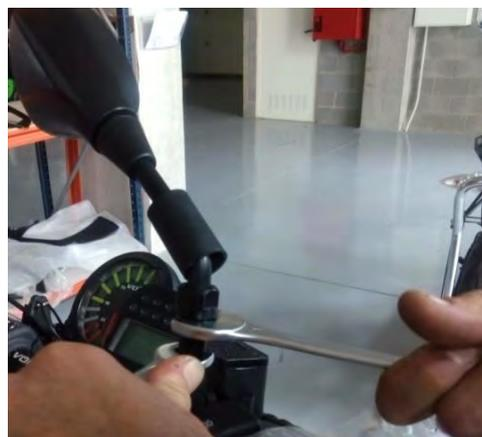
**Paso 5.** Se empieza sujetando el adaptador de abajo y se aprieta la primera rosca superior.
