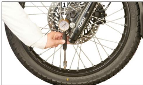
(1) Calibrador presión de aire
