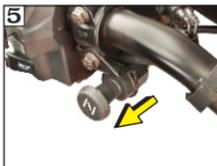
5 Tire de la perilla del Bystarter hacia afuera a la posición "ON" como se indica (Use el Bystarter en condiciones de frío).
