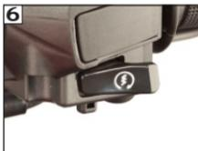
6 Presione el interruptor de arranque para arrancar la motocicleta. (Alternativamente, el pedal de arranque puede usarse para comenzar).
