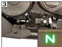
3 Seleccione la posición neutro y verifique que el indicador (N) se ilumine en el grupo de instrumentos con el encendido en "ON" (O).
