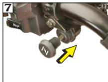
7 Empuje la perilla del Bystarter hacia adentro hacia "OFF", posición como se indica, después de que el motor se caliente lo suficiente como para tener una respuesta estable del acelerador.
