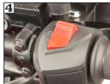
4 Asegúrese de que el interruptor de parada del motor esté en la posición "ON" (O).
