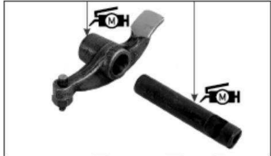
Instale los balancines y los ejes en la tapa de la culata.
