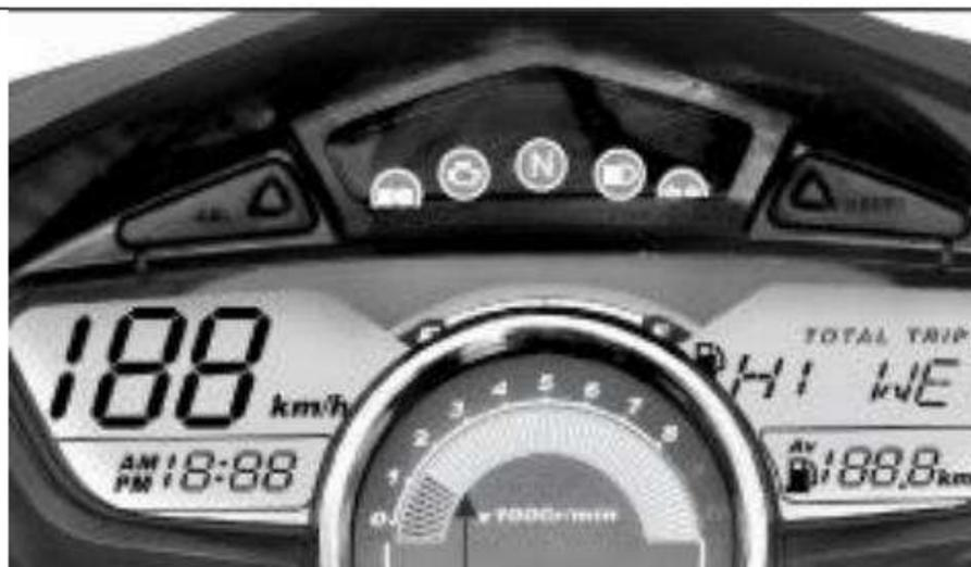
INDICADOR DE RPM DEL MOTOR
