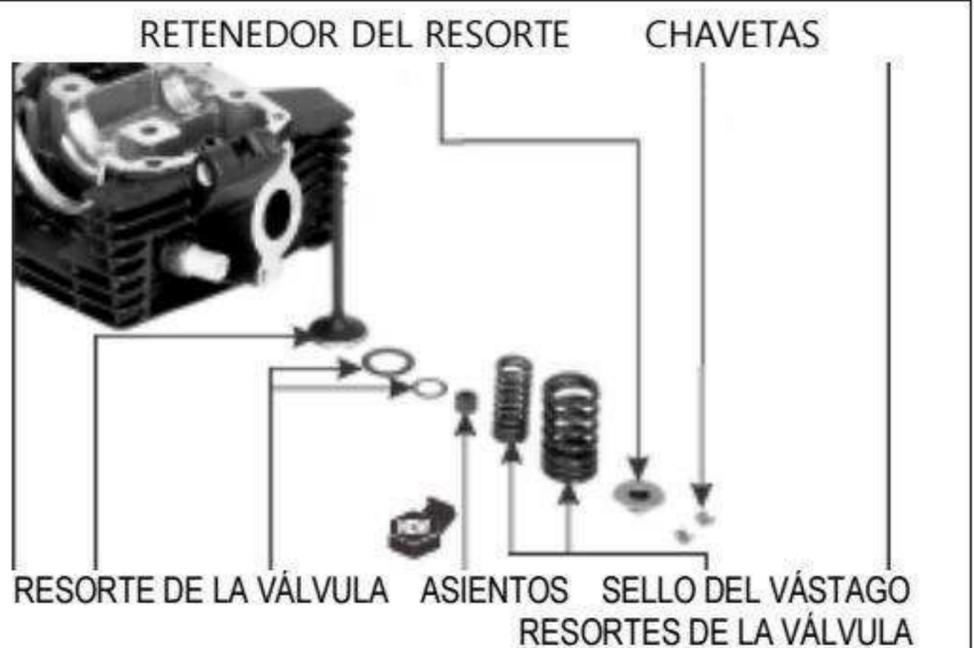
Instale los resortes de las válvulas con la parte más apretada hacia la cámara de combustión.
