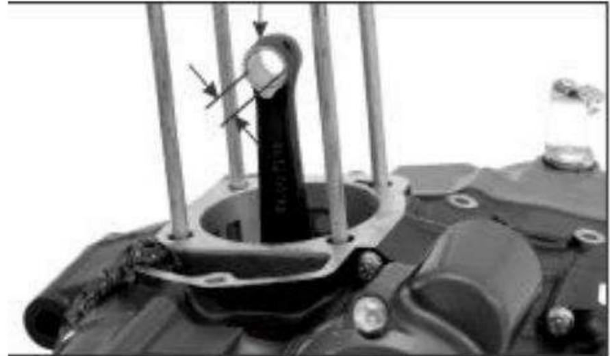
Usando un pistón, empuje el segmento del pistón con seguridad al cilindro y mida la brecha terminal usando un calibrador de hojas.
