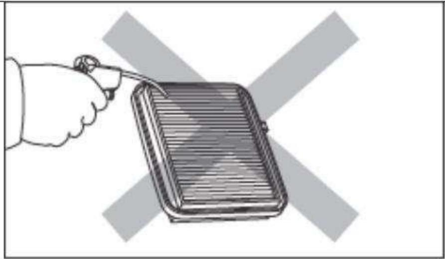
No poner el elemento del filtro de aire horizontalmente sobre cualquier superficie pues el polvo puede pegarse del filtro por la presencia de aceite. De ser necesario, ubíquelo verticalmente.
