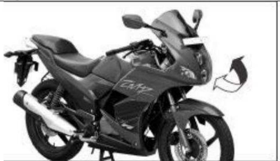
Revise el desgaste de los rodamientos del tubo de dirección tomando la pata del tenedor frontal e intentando mover el tenedor frontal de lado a lado. Ajuste/cambie los rodamientos si se observa algún juego.
