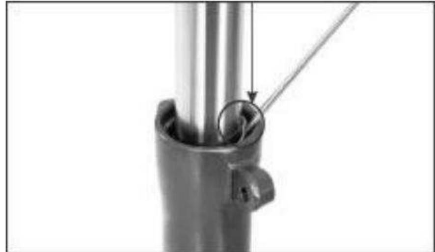
Bloquee el pistón del tenedor usando la herramienta especial según se muestra.
