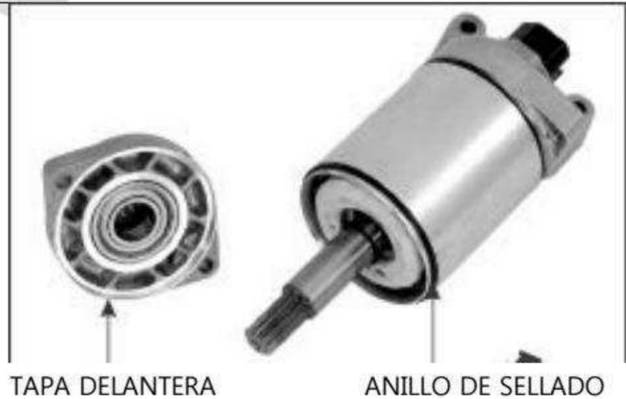
Alinee las marcas en la tapa delantera, carcasa del motor de arranque y tapa trasera.
