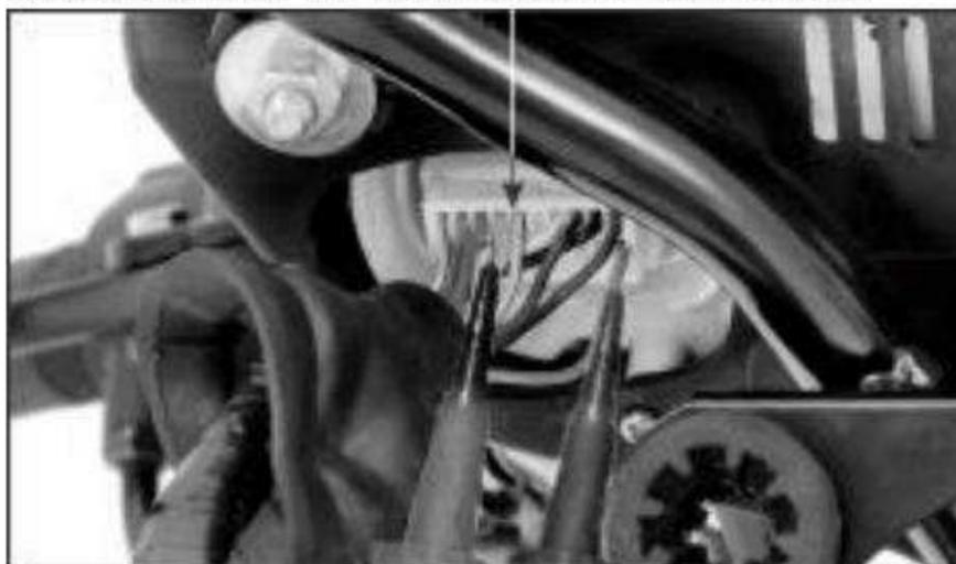
17. Gire el encendido a "OFF". Desconecte el conector ECU 33P y revise la continuidad entre el conector ECU 33P en el extremo del arnés de cables y el conector 16P de la unidad de medidores en el extremo del arnés de cables.
