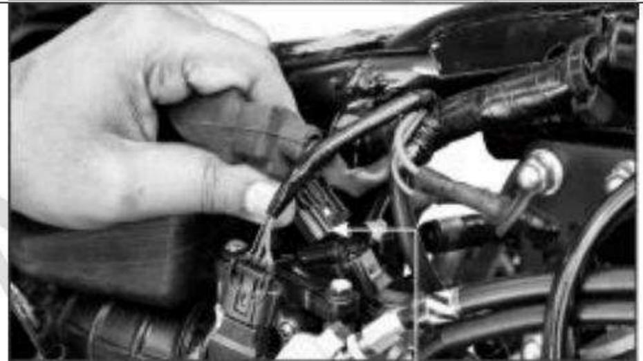
CONECTOR 2P DEL INYECTOR
