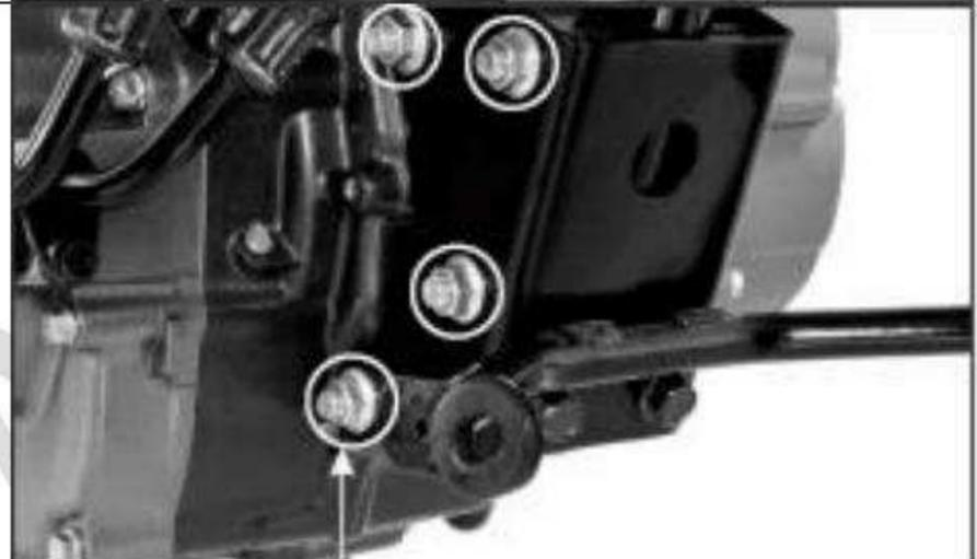
PERNOS/TUERCAS DE MONTAJE FRONTAL DEL MOTOR
