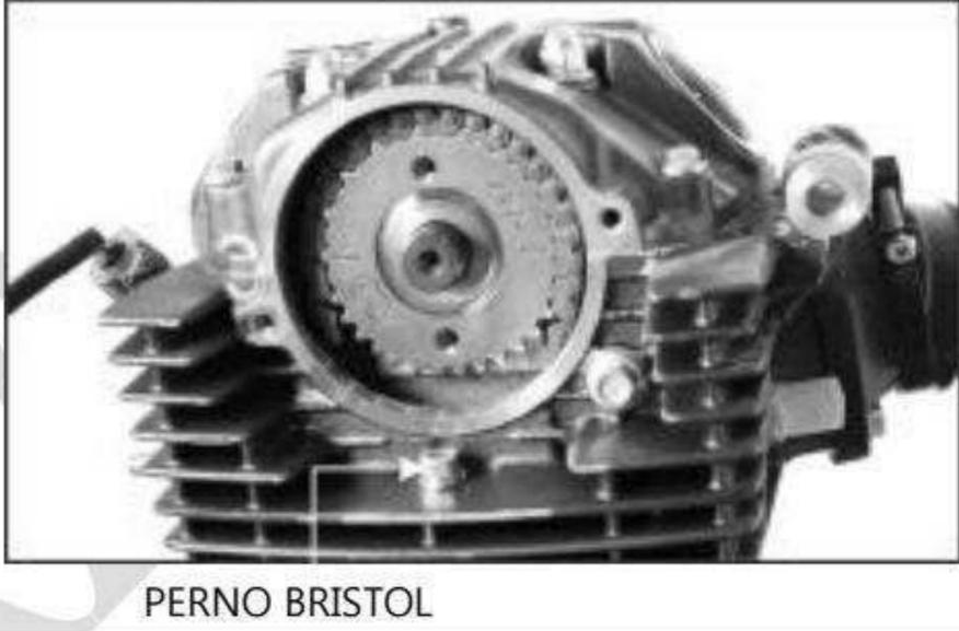
Suelte los pernos y las tuercas sueltas de la tapa de la culata en un patrón en zigzag en 2 o 3 pasos. Retire los pernos, las tuercas y las arandelas de sellado.
