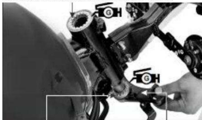
MONTAJE DE JAULA DE BOLAS SUPERIOR EJE DE DIRECCIÓN
