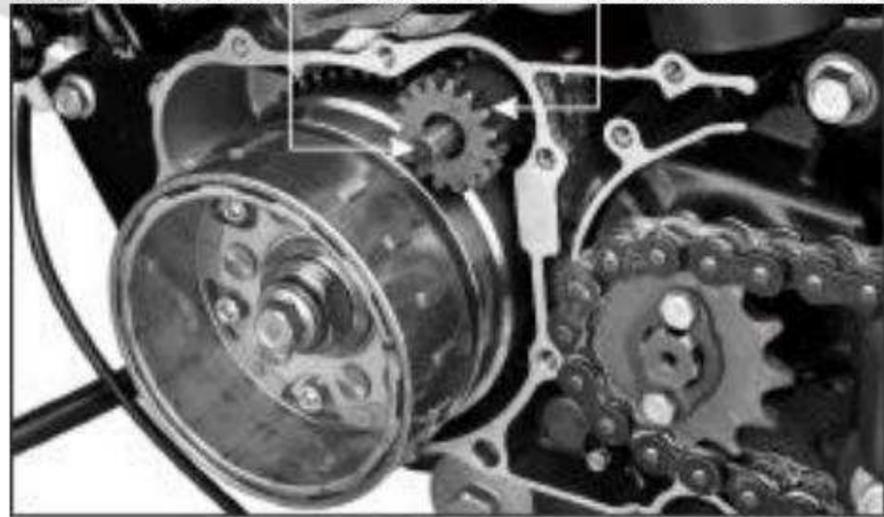
Sostenga el volante con el sujetador del volante y suelte el perno del volante.
