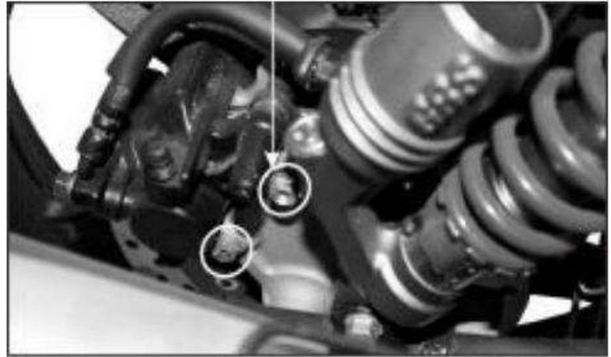
Conéctele la manguera del freno a la pinza del freno con nuevas arandelas de sellado.
