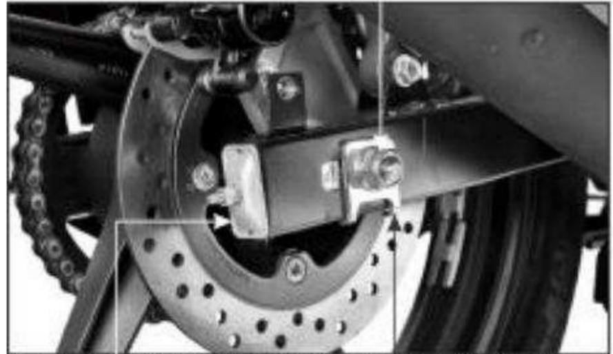
PLACA DE AJUSTE DE LA CADENA ARANDELA DEL EJE TRASERO
