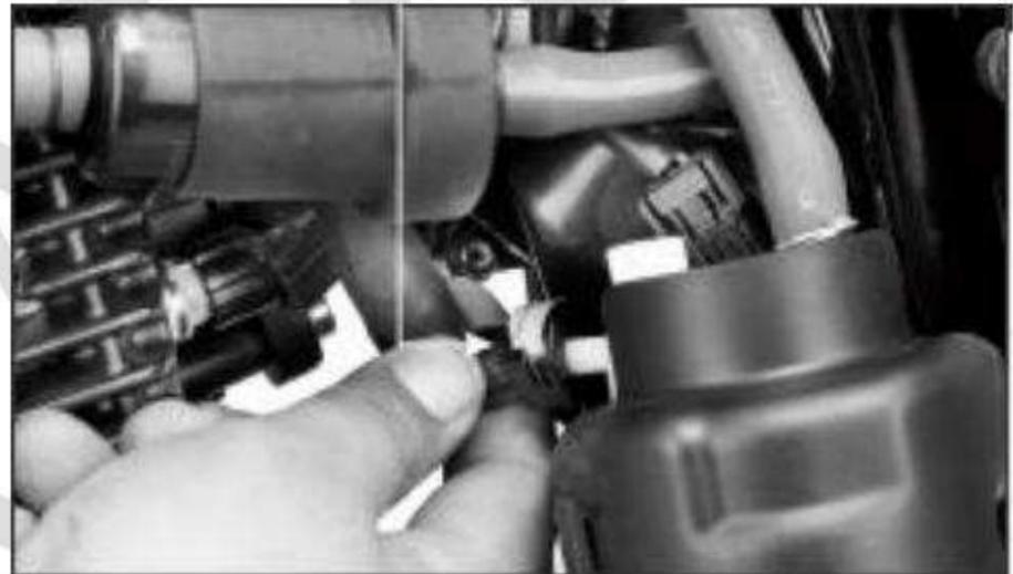
Anexar un lado del adaptador del manómetro de presión a la manguera de combustible.
