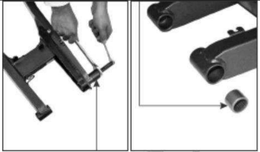
EXTRACTOR/INSTALADOR DEL RODAMIENTO DE
