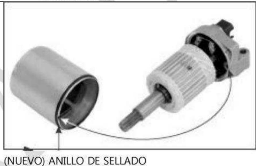
Instale un nuevo anillo de sellado en la carcasa del motor de arranque.
