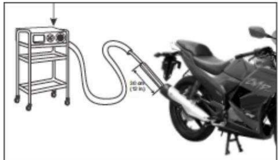
mofle para que la sonda pueda ser insertada más de 30 cm (12 pulgadas).
