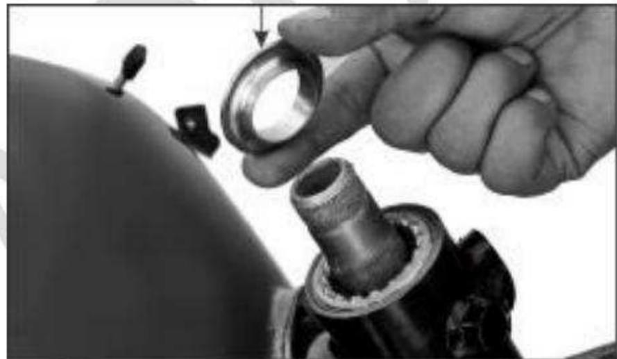
Retire el montaje superior e inferior de la jaula de bolas. Revise el montaje de la jaula de bolas buscando desgaste o daños.
