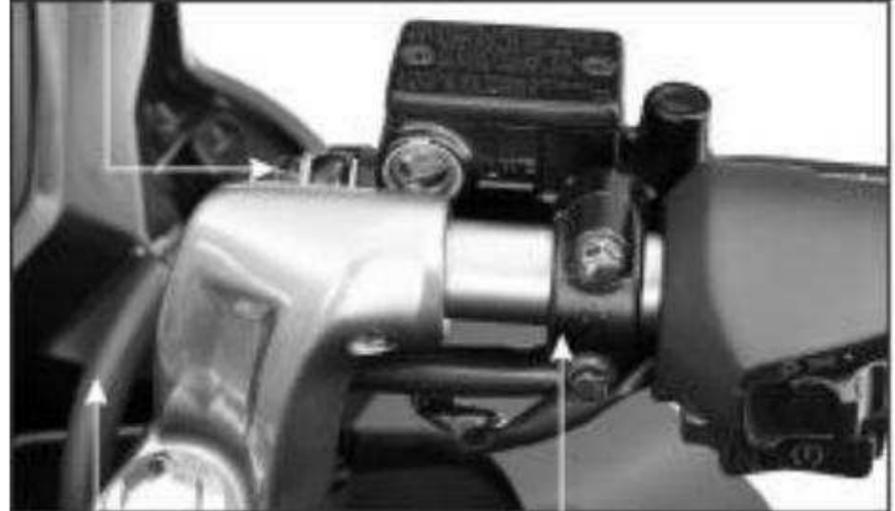
MANGUERA DE FRENO SUJETADOR DEL CILINDRO MAESTRO
