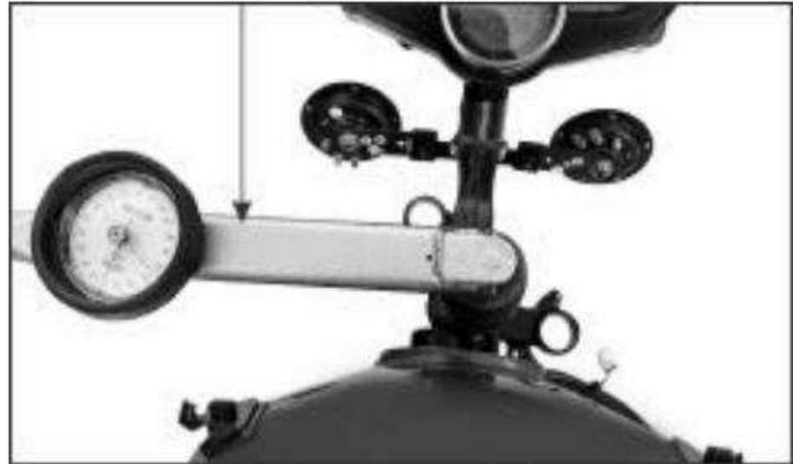
Gire el eje de la dirección de bloqueo a bloqueo varias veces para asentar el rodamiento de la dirección, luego suelte la tuerca de ajuste del rodamiento de la dirección. Vuelva a apretar la tuerca de ajuste del rodamiento de la dirección a la torsión final indicada.
