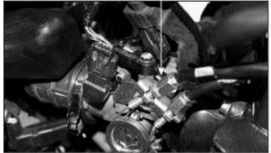
3. Desconecte el conector 2P del inyector y busque contactos sueltos o malos en el conector 2P del inyector.
