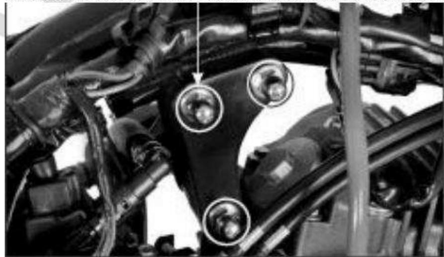
Retire las tuercas de montaje traseras del motor sosteniendo los pernos de montaje trasero del motor. Soporte el motor usando un gato o algún otro soporte ajustable para facilitar la remoción de los pernos de montaje frontales y traseros del motor.
