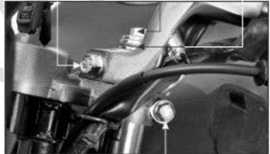
Mientras sostiene el montaje del tenedor, suelte los pernos de fijación del puente inferior y retire el montaje del tenedor del manubrio y los puentes del tenedor.
