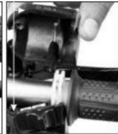
Desconecte el cable del acelerador del tubo del acelerador, luego retire el tubo del acelerador y la empuñadura del acelerador.
