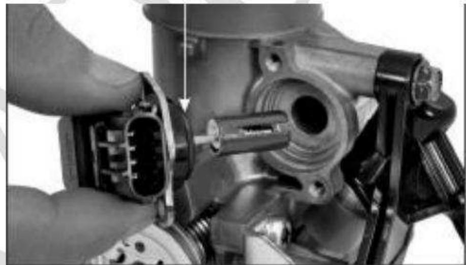
Instale y apriete los tornillos torx hasta la torsión específica.
