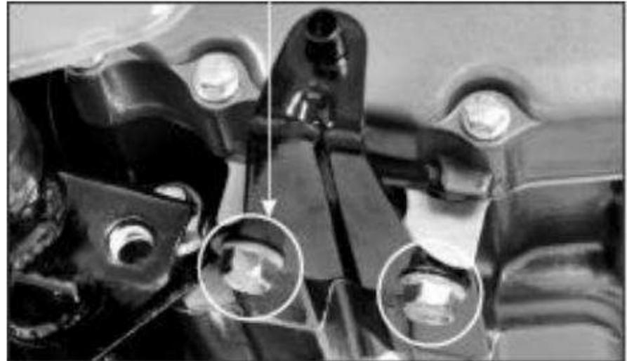
Retirar las tuercas de montaje frontal del motor mientras sostiene los pernos de montaje del motor.
