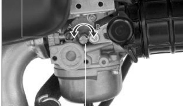
Tornillo de Ajuste de velocidad en neutro
