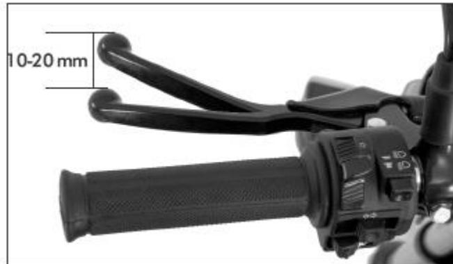
El ajuste se hace ajustando la tuerca del cable del embrague al motor. Afloje la tuerca de bloqueo y gire la tuerca de ajuste ajustando la palanca del juego libre del embrague.
