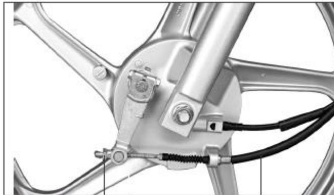
Tuerca de ajuste      Cable freno delantero
