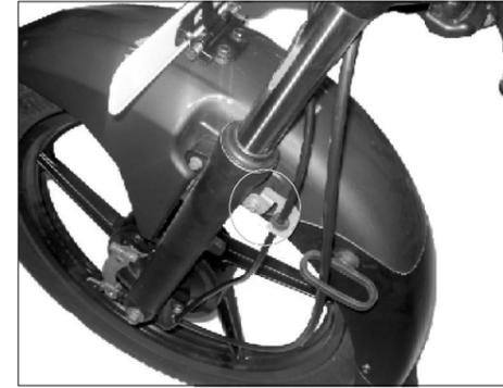
Cable sensor del espedómetro
