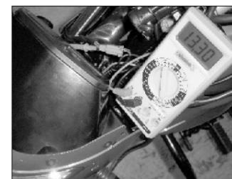
Para medir el voltaje CD, abra la caja de alojamiento de la luz principal. Arranque el motor y llévelo a 5000 RPM. Verifique que la luz principal, la luz trasera y la luz del velocímetro estén en 'ON' y el suiche regulador está en posición de 'Luz Alta'. Conecte el multímetro en paralelo a través del circuito de CD conectando el terminal del medidor +ve al alambre Rojo/Negro desde el terminal -ve del medidor a tierra (alambre Negro/Amarillo).
