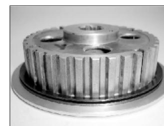
**Mecanismo anti-deslizamiento del clutch**
