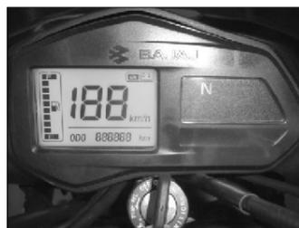
El velocímetro tiene una pantalla digital de LCD con un sistema de visualización lumínica naranja para óptima visibilidad durante el manejo de noche. Este conjunto de instrumentos del velocímetro incluye:-
