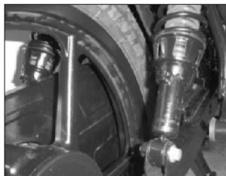
La tensión del resorte RSA se puede ajustar con la ayuda de una leva ajustadora de 5 pasos, según la carga y las condiciones de la vía, para suplir los requisitos individuales.
