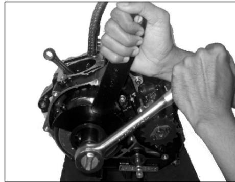
Usando sujetador de rotor F41AJA09 y extractor de rotor F41AJA10
