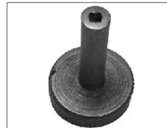
Ajustador Tolerancia de Válvulas
