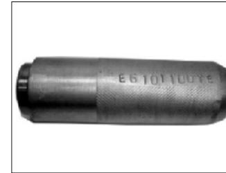
Conductor para instalar el buje del Tambor del Selector de Cambios
