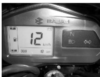
Nota: Note que durante el arranque de patada o con el auto arrancador, el visor del velocímetro se desvanece momentáneamente y regresa en 1.5 ~ 2 seg.
