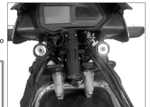
Precaución: cubra el tanque de combustible con trapos de algodón para evitar rayones o daños debidos a que descansa sobre el conjunto del manubrio.
