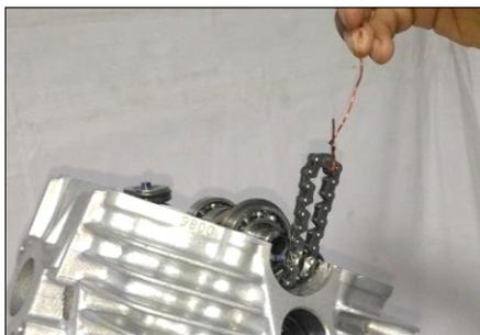
• Ate la cadena de levas con un cable de cobre suave.
