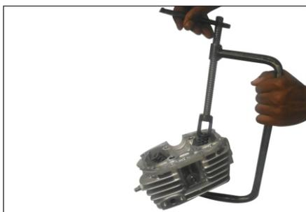
Usando el compresor de resorte de válvulas y el adaptador.
