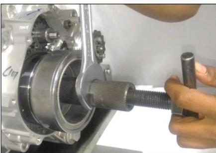
**Usando el extractor del rotor**
