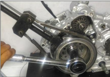
**Usando el Sujetador de Volante**
