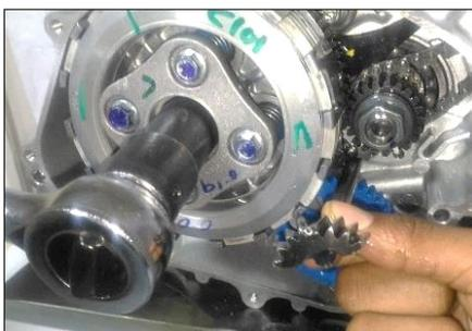
**Usando el sujetador del piñón primario.**
