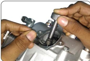
Siempre regule / ajuste la luz de las válvulas con el motor frío.
