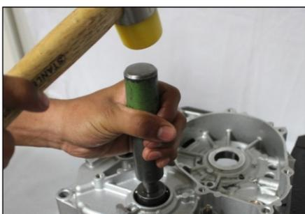
**Usando el conductor del rodamiento**
