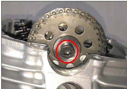
• Usando el sujetador del piñón del eje de levas
