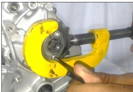
**Usando el Sujetador del Piñón de Arrastre**
