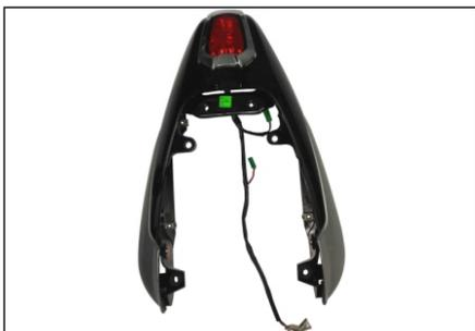
Retire el carenado de asiento junto con el faro posterior
