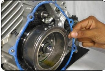
Siempre reemplace los empaques y o rings si desarma el motor.
