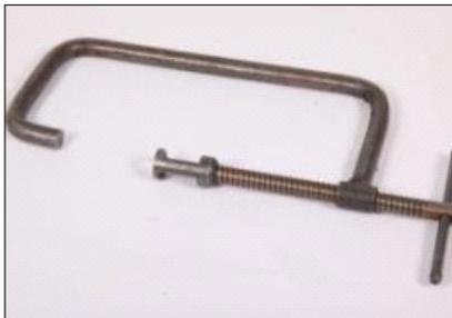
**Adaptador y Compresor del Resorte de Válvulas**
