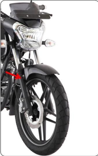
Reemplace el aceite de las horquillas delanteras con aceite grado SAE 10W20.
