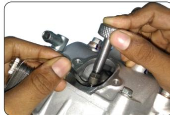
No regule / ajuste la luz de las válvulas con el motor caliente.
