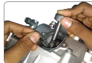
Nunca verifique ni calibre las válvulas con el motor caliente
