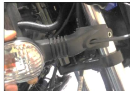
**Reemplazo de las direccionales traseras**
