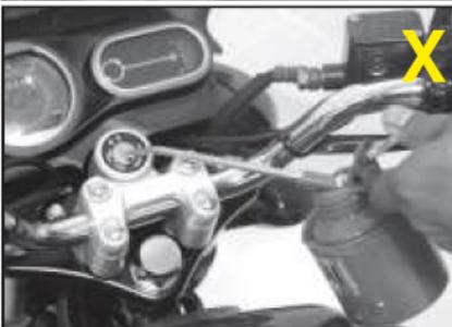
**Nota: - No lubrique el interruptor de ignición con aceite de motor**
