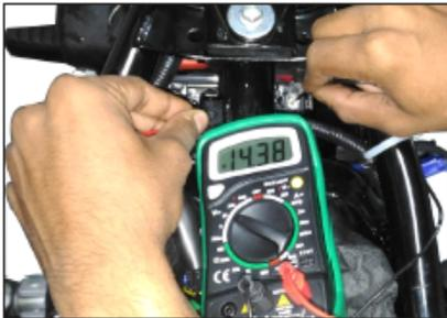
Equipo de medición: multímetro
