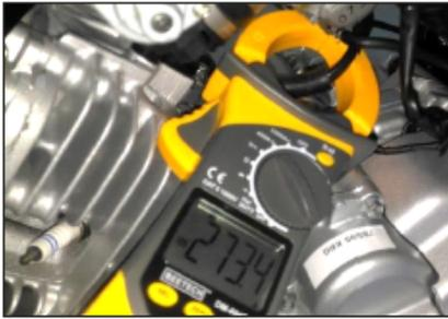
**Equipo de medición: pinza amperimétrica**
