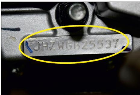
Ubicación del número de motor: en la carcasa izquierda del cárter cerca de la palanca de cambios
