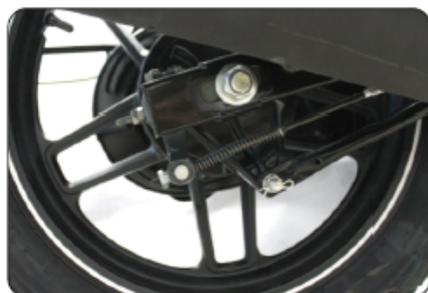
Verifique que el pin de la varilla de torque este instalado
