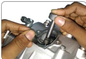
Siempre que verifique o calibre las válvulas, asegure que el motor este completamente frio
