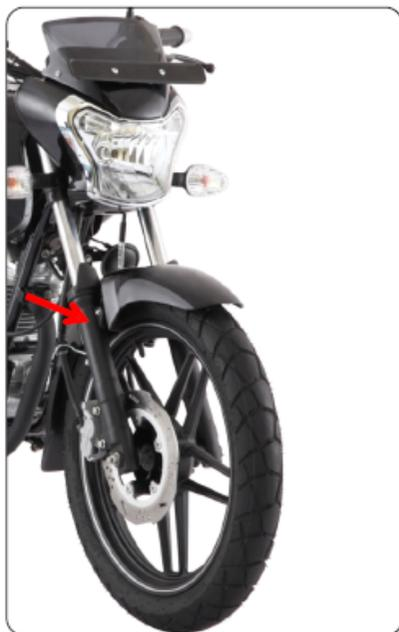
Reemplace el aceite de la horquilla por uno de especificación SAE 10W20
