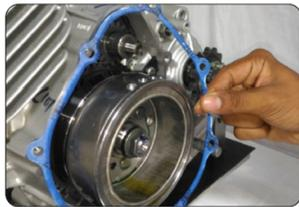
Reemplace los empaques siempre que desarme el motor
