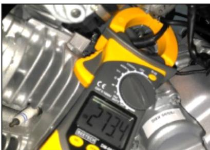
**Equipo de medición: pinza amperimétrica**
