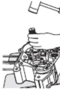
3) Quite el rodamiento de agujas del eje de caja al lado del clutch, usando el extractor de rodamientos 37-1003-02.
