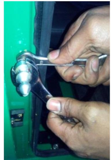
Ajuste el terminal del seguro sin moverlo de su posición
