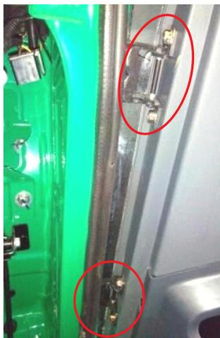
La puerta debe moverse en la dirección del eje Z luego de ajustar las bisagras. La puerta debe dejarse con un par flojo para permitir su movimiento en la dirección Z de los soportes
