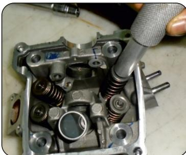
**Usando el Adaptador del Compresor del Resorte de Válvulas - 37103108**
