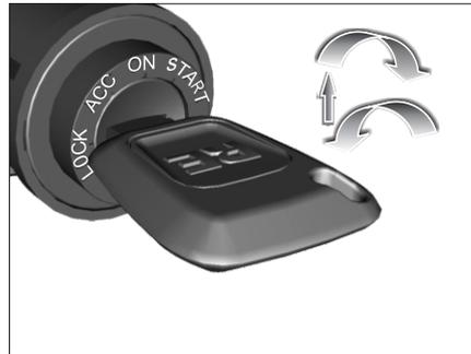
El interruptor de encendido está ubicado en el lado derecho de la columna de dirección. El interruptor tiene 4 posiciones.
