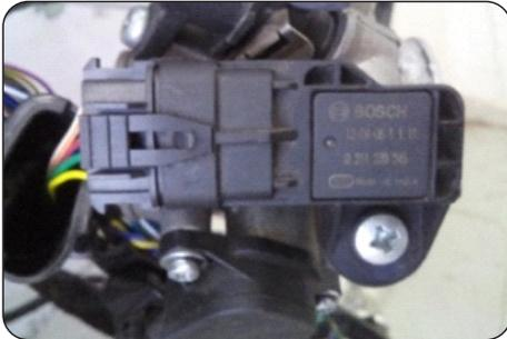
El sensor MAP (Presión absoluta del Colector) se usa para encontrar el flujo de aire requerido por el motor. Ayuda a que la ECU determine la cantidad de combustible a ser inyectada.
