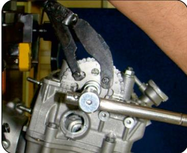
Usando la Herramienta Especial 37104254 (Sujetador del Piñón de Levas)
