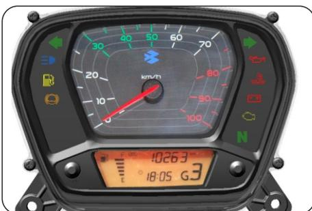
Parpadeará el indicador si existe alguna avería en el sistema de inyección (FI) o en el sistema de gestión del motor (EMS).
