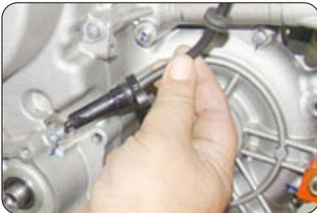
El sensor de velocidad es un dispositivo semiconductor basado en el efecto Hall. El sensor envía pulsos ON/OFF a la ECU, cuando el elemento metálico giratorio interrumpe el campo magnético.
