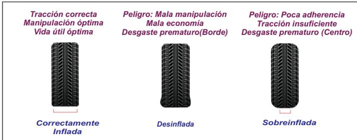
**Presión de Neumáticos:** Las ruedas del RE 60 vienen provistas con neumáticos sin cámara.
