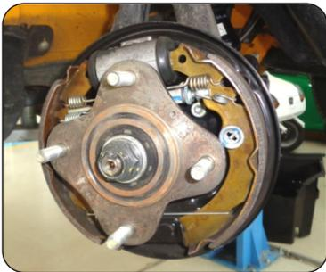
Retire el pasador de la zapata usando un alicate mientras sujeta el pasador desde la parte posterior. (ambos pasadores)
