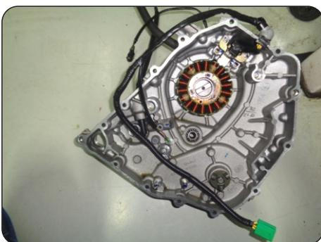
Ramal del Sensor de Posición del Cigüeñal
