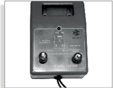
2. Retire los capuchones de las bujías y conéctelos a la terminal S1/S2 en la unidad.
