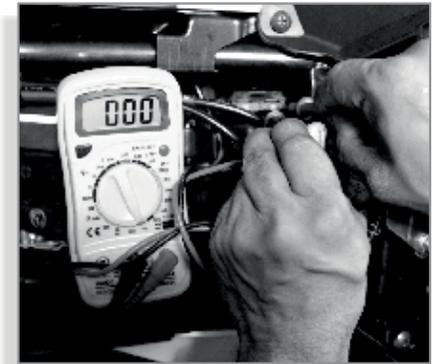
**Precaución:** cuando reemplace el fusible, asegúrese que el nuevo tiene el mismo rango especificado para este circuito. Instalar un fusible de un rango superior puede causar daños al cableado y a los componentes.
