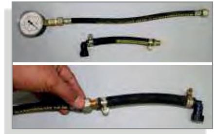
2. Desconecte el tubo del inyector, el conector rápido del filtro de combustible.
