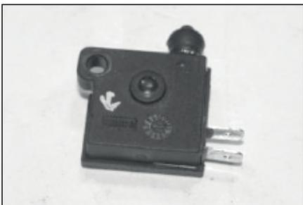
Ubicación : En el lado inferior de la leva de freno conectado al actuador de la bomba de freno.
