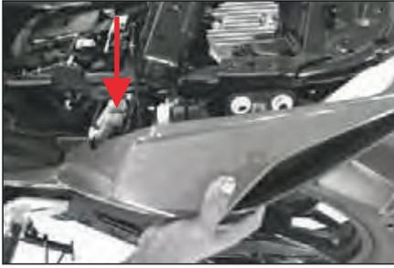
Ubicación : Montado en el chasis en el carenaje izq. del sillín junto al relé aux. 1.
