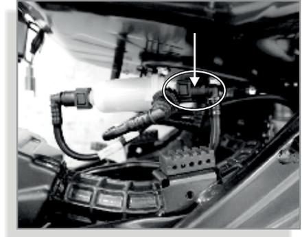
3. Conecte la unidad de revisión de presión de la bomba de combustible a la salida de la bomba de combustible firmemente.
