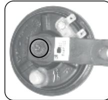
Nunca la tuerca del lado de la tapa del pito y del extremo de la platina (lado posterior) pues esto hará que el pito falle y funcione mal.
