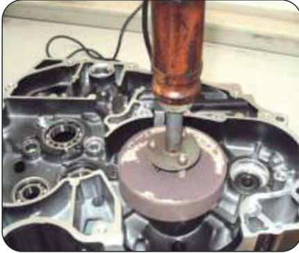
Utilice un calentador de motor para calentar el lado del clutch de la carcasa para un ensamble fácil y suave del rodamiento del cigüeñal.
