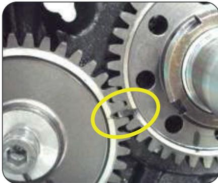
Las marcas del piñón conducido y conductor del balanceador estén alineadas entre ellas.
