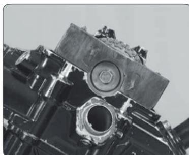
**Sujetador del sprocket de levas**
