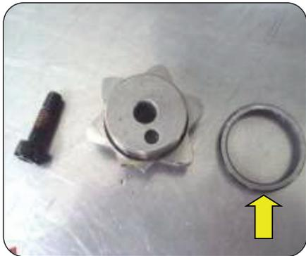
Asegúrese del ajuste del espaciador cuando ensamble el piñón guía
