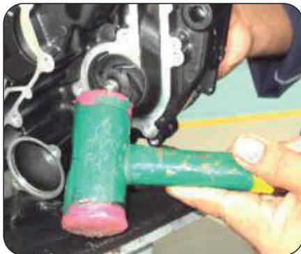
Golpee el eje del balancador para remover el rotor
