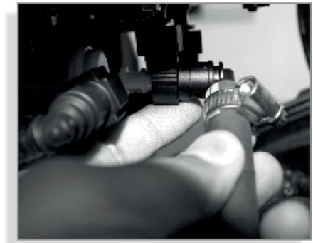
4. Haga la conexión del acople de la bomba de combustible.
