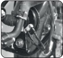
Asegúrese que el pito esté firmemente instalado en la estructura del carenaje central.
