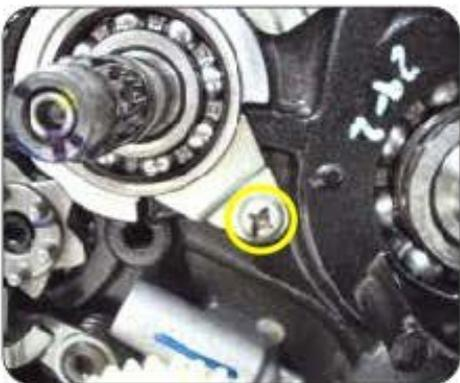
Retire el tope del rodamiento del eje de entrada del lado del embrague para instalar la herramienta de división del cárter.
