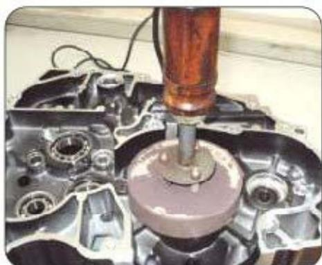
Utilice el calentador del motor para calentar el lado del embrague del cárter a fin de instalar fácilmente el rodamiento del cigüeñal.
