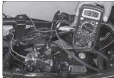
Verificación de voltaje de salida
