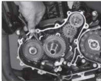
**Herramienta de ajuste/extracción de la contratuerca de balanceador**
