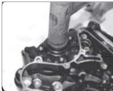
**Herramienta de instalación del retén de aceite en eje de salida**
