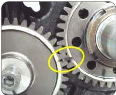
*Las marcas del conductor balanceador y el engranaje del controlador concuerden una con otra.*
