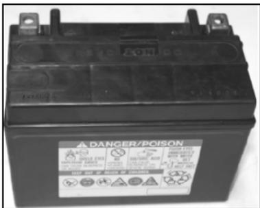
**Tipo de batería: 12V - 8Ah VRLA (“BATERIA SECA”)**
