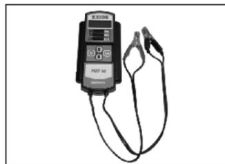
Para verificar el estado de la batería VRLA, se usará un probador de carga según las especificaciones siguientes:
