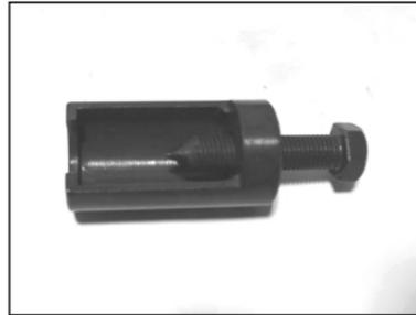
**Extractor de rodamiento del eje de levas**
