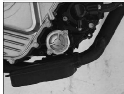
El filtro de aceite se ubica en la DER justo arriba de la cámara de expansión de torque.
