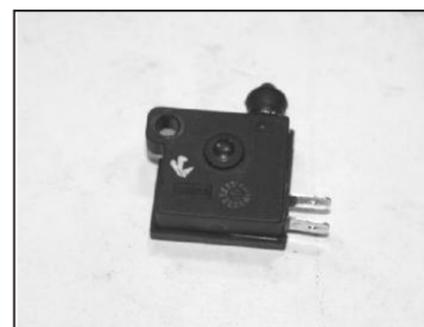
**Interruptor de Luz de Frenado Delantera**
